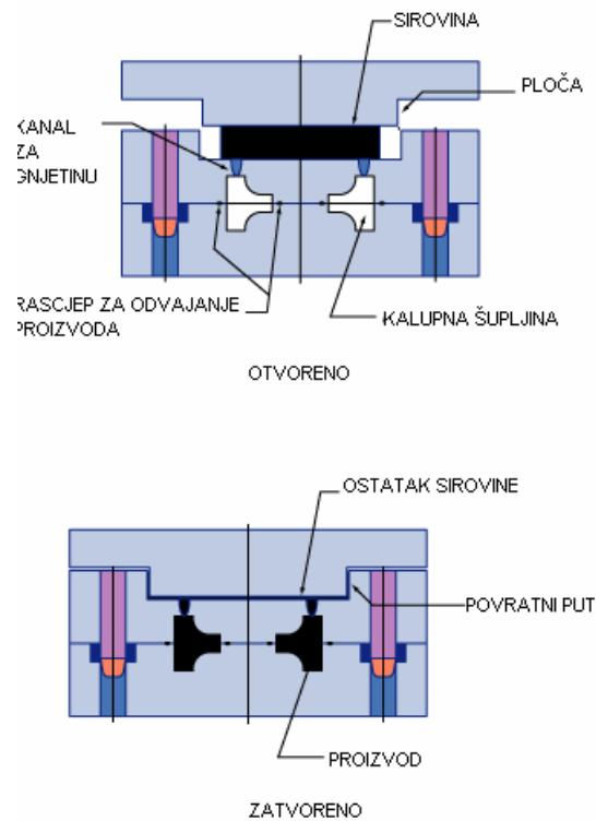
Slika 5.4 Princip posrednog prešanja<sup>16</sup>
