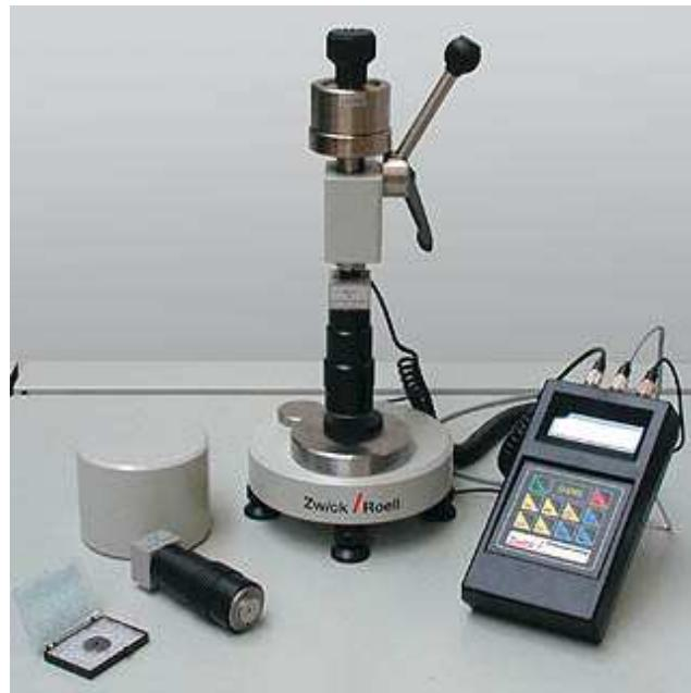
Slika 7.5. Schore- ov uređaj za ispitivanje tvrdoće<sup>26</sup>
