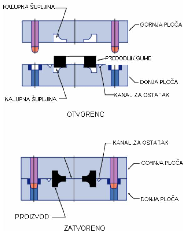
Slika 5.2. Princip izravnog prešanja<sup>16</sup>
