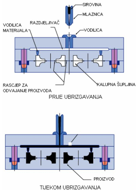
Slika 5.5. Princip injekcijskog prešanja<sup>16</sup>
