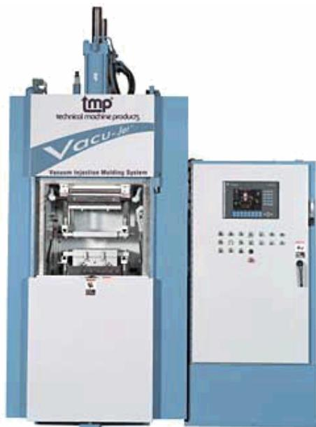
Slika 5.6. Preša za injekcijsko prešanje<sup>19</sup>
