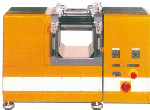
Slika 4.3. Dvovaljak (horizontalno postavljeni valjci)<sup>13</sup>
