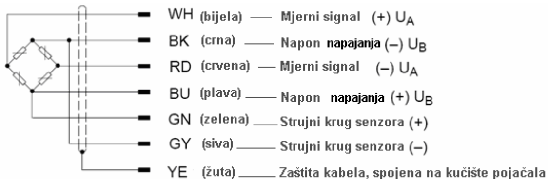
Slika 18. Konektori i spojna shema [13]
