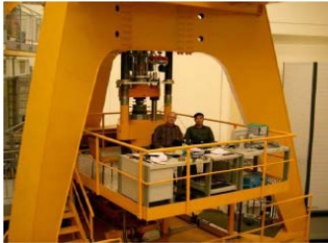
Slika 5. Primjer hidraulične kidalice nazivne sile 2 MN
