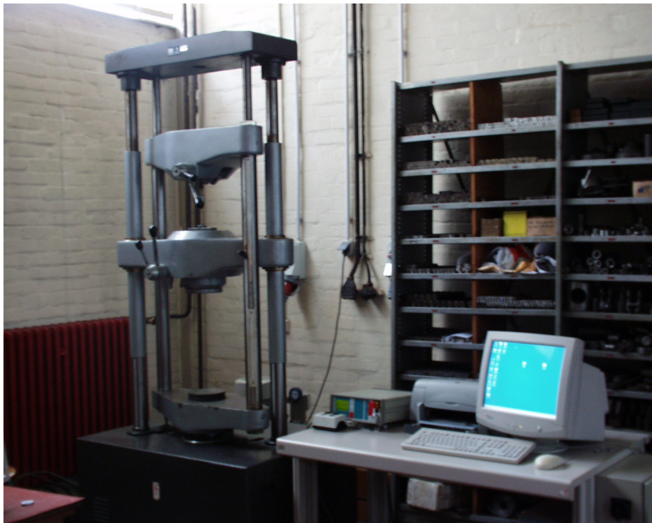
Slika 30. Umjeravana kidalica sa upravljačkim uređajem i PC-om
