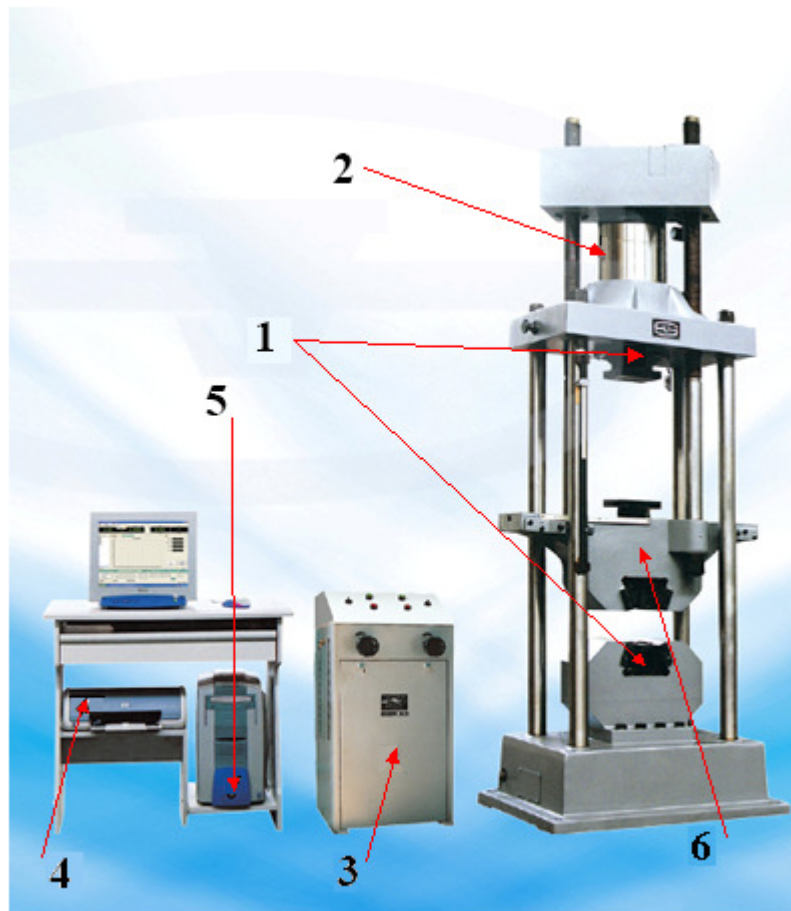
Slika 4. Prikaz hidraulične (univerzalne) kidalice [10]
