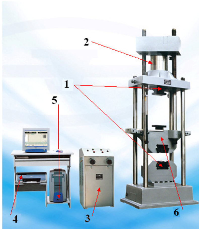
Slika 4. Prikaz hidraulične (univerzalne) kidalice [10]
