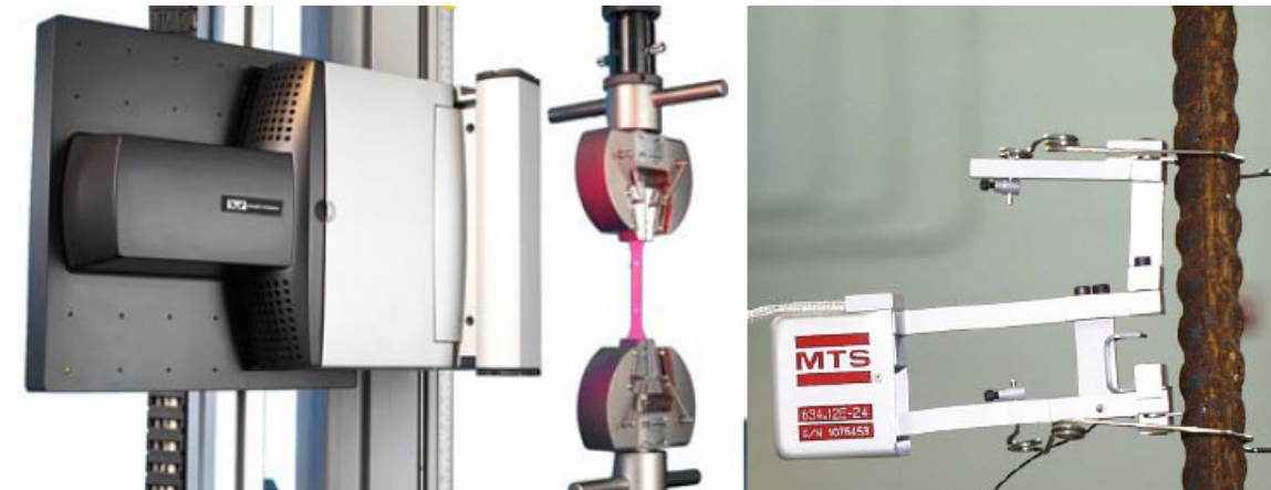
Slika 3. Ekstenzimetri u procesu mjerenja [8]
