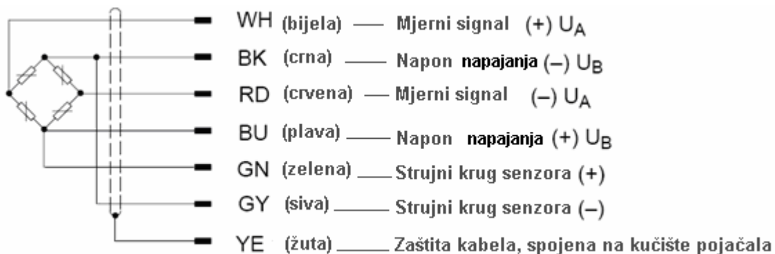
Slika 18. Konektori i spojna shema [13]
