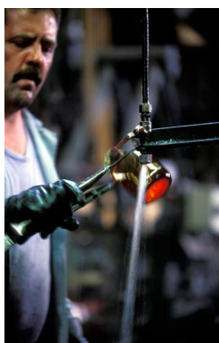
Slika 11: Ispitivanje staklenih spremnika u Vrućoj zoni
