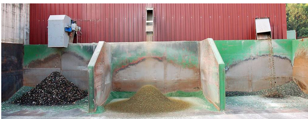
Slika 22: Nečistoće izdvojene iz staklenog krša
