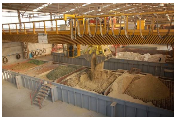
Slika 24: Transport kvarcnog pijeska do silosa u mješaone
