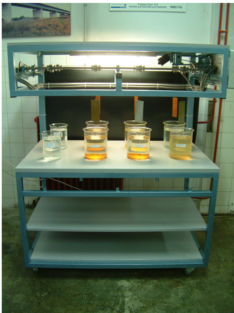
Slika 66. Naprava za ispitivanje uranjanjem prema normi ASTM G44 u Laboratoriju za zaštitu materijala Fakulteta Strojarstva i Brodogradnje Sveučilišta u Zagrebu 2008. godine
