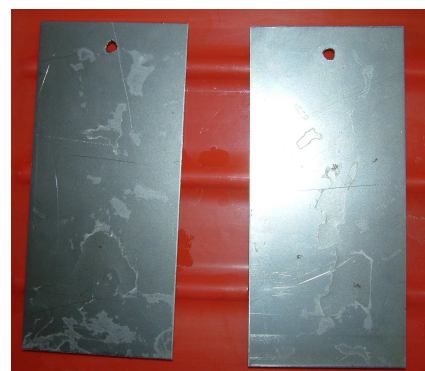
Slika 46. Zaštićeni uzorci probnog ispitivanja prije uranjanja
