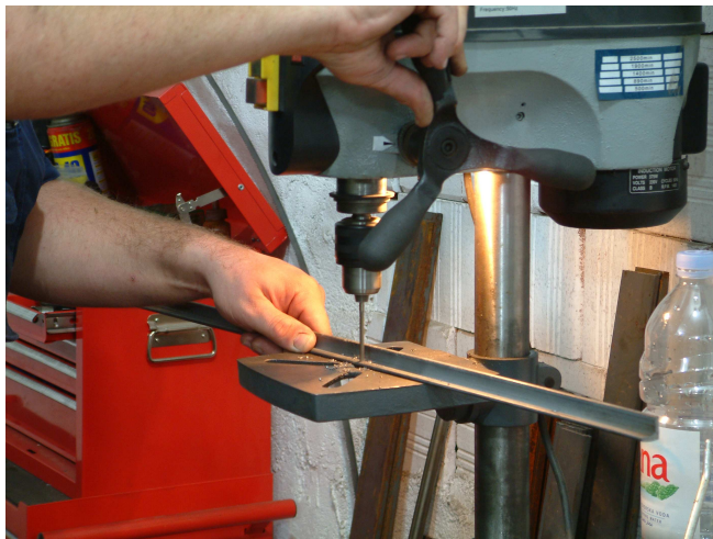
Slika 38. Bušenje profila za izradu kućišta
