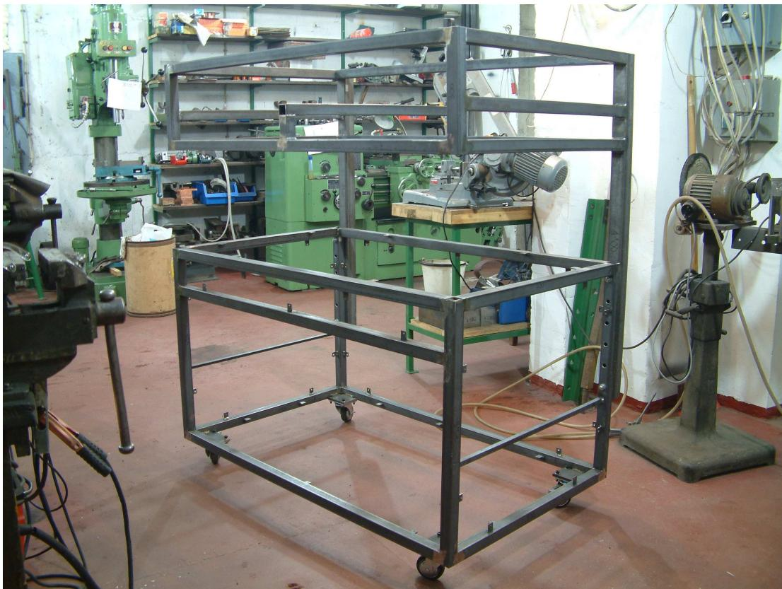
**Slika 22.** Čelično kućište uređaja
