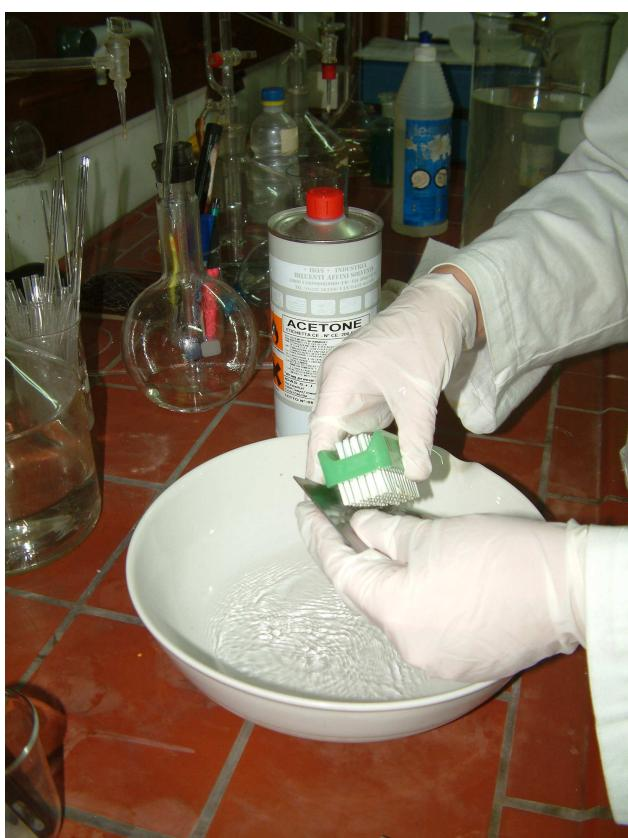
**Slika 52.** Odmašćivanje uzoraka acetonom
