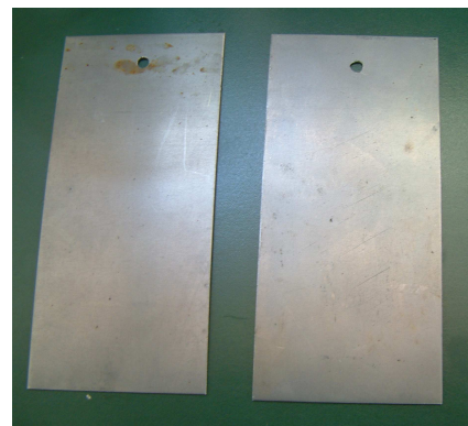
Slika 45. Nezaštićeni uzorci probnog ispitivanja prije uranjanja
