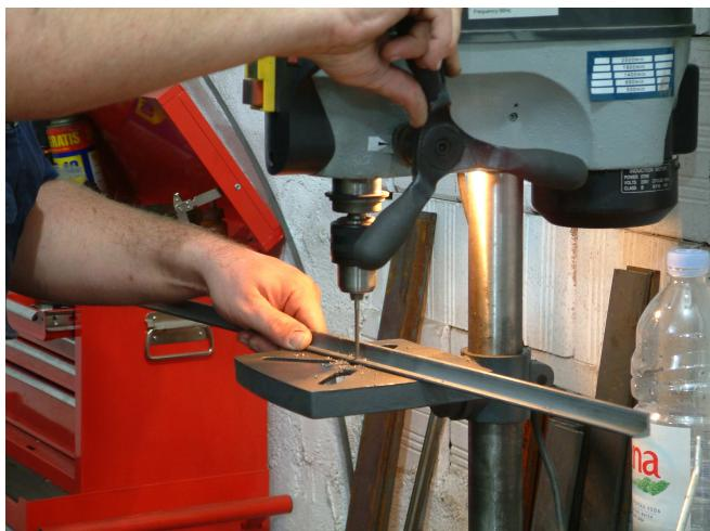
**Slika 38.** Bušenje profila za izradu kućišta
