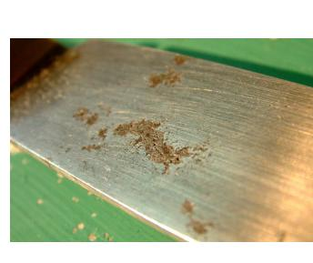
e) galvanska korozija Cr-Ni čelika
