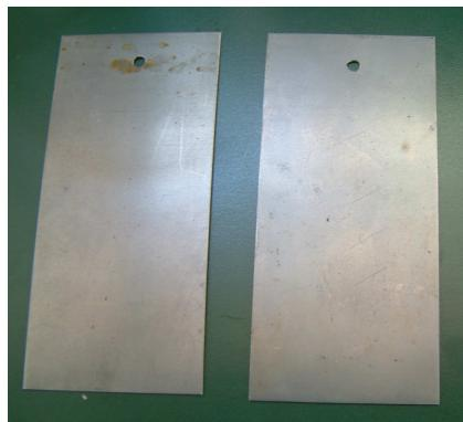
**Slika 45.** Nezaštićeni uzorci probnog ispitivanja prije uranjanja
