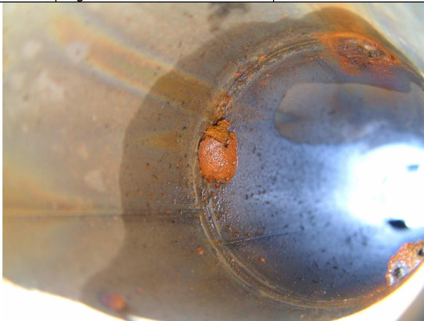
**Slika 4.** Mikrobiološka korozija na cijevi od nehrđajućeg čelika
