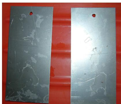
**Slika 46.** Zaštićeni uzorci probnog ispitivanja prije uranjanja
