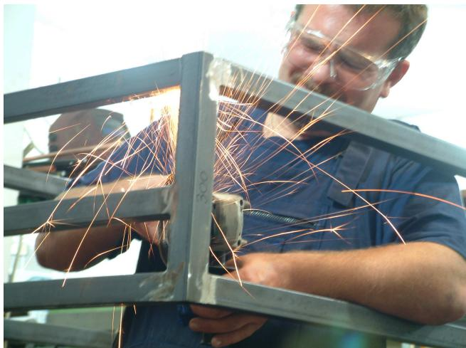
**Slika 40.** Brušenje zavara kutnom brusilicom
