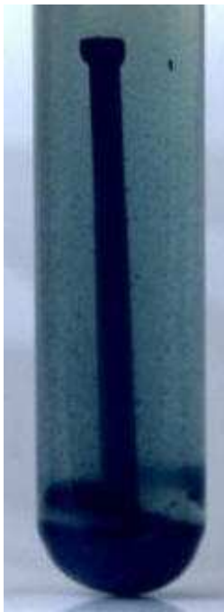
Slika 10. Zelena hrđa \text{Fe(OH)}_2 [10]
