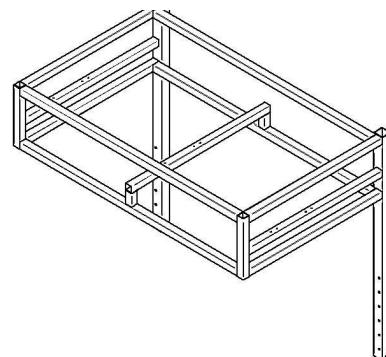
**Slika 33.** Montažni nacrt gornjeg dijela kućišta
