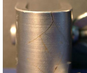
c) interkristalna korozija Cr-Ni čelika
