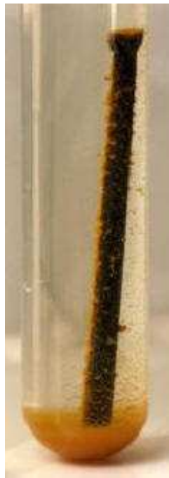
Slika 11. Crvena hrđa hematit \text{Fe}_2\text{O}_3 \cdot x\text{H}_2\text{O} [10]
