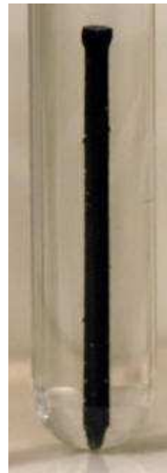
Slika 12. Crna hrđa magnetit \text{Fe}_3\text{O}_4 [10]
