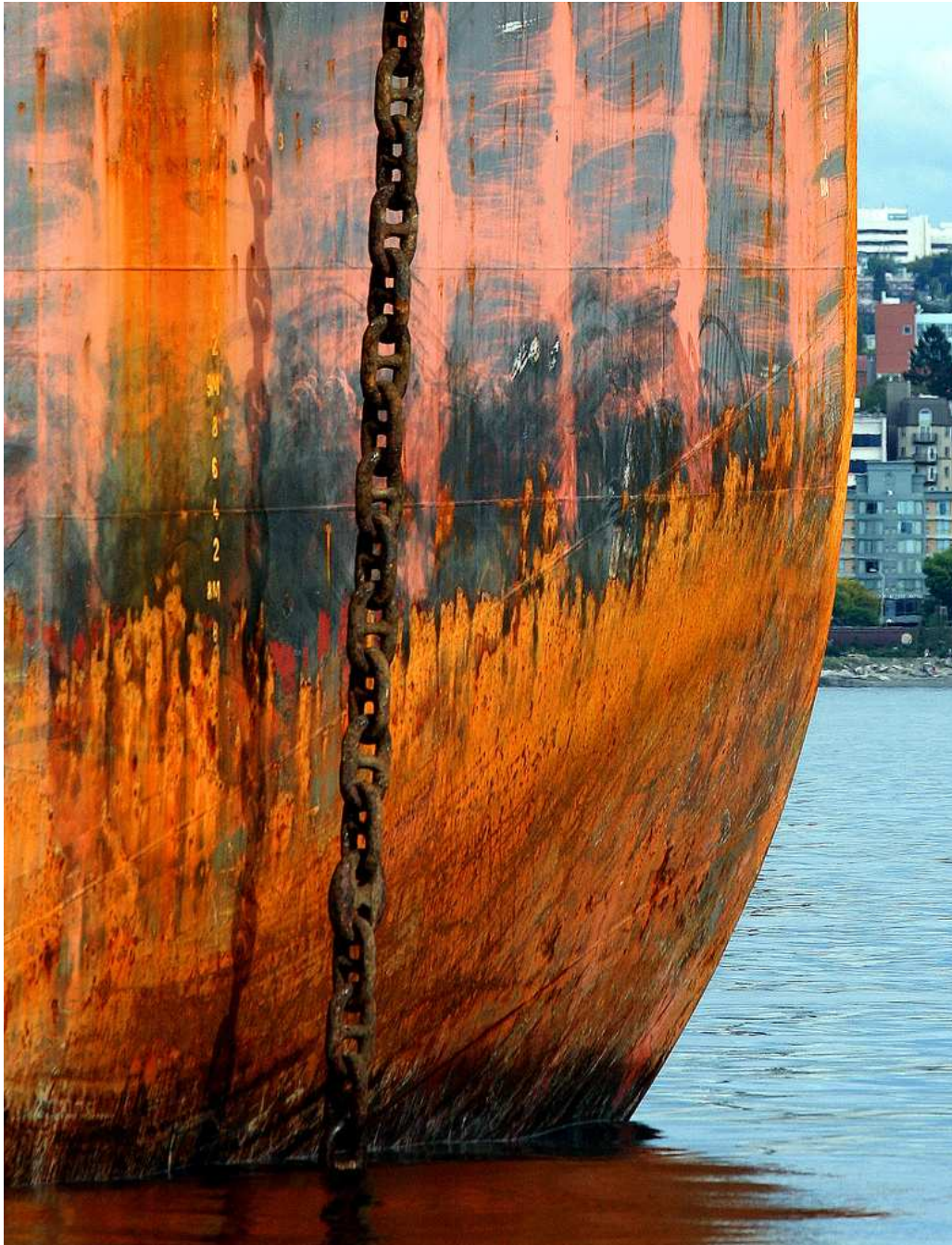
Slika 19. Detalj korodiranog brodskog trupa [17]
