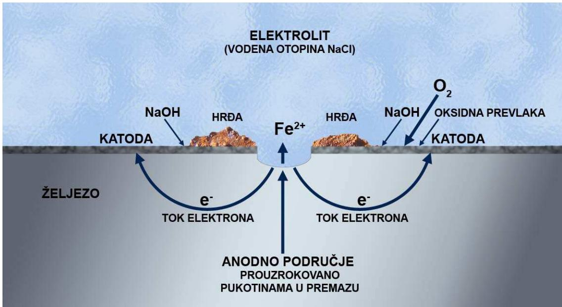
**Slika 13.** Korozija u vodenoj otopini NaCl [1]
