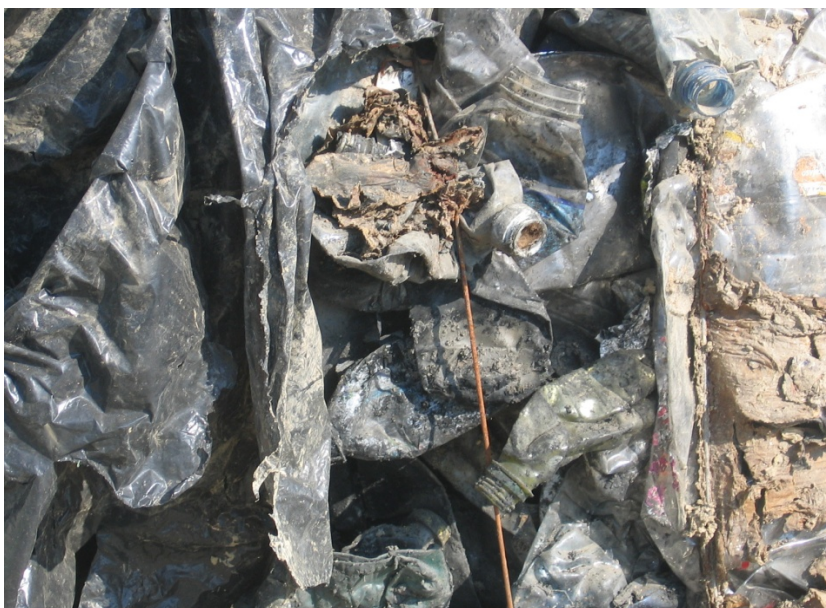
Slika 6.10. Jako onečišćene i degradirane PET boce
