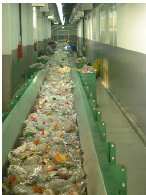
Slika 6.3. Prikaz postupka razvrstavanja plastične ambalaže
