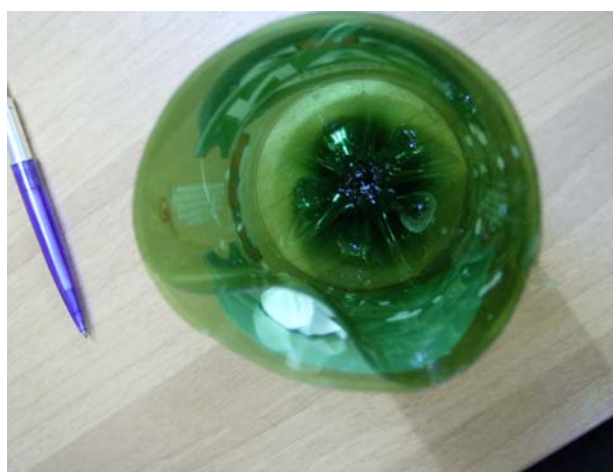
Slika 6.14. Višeslojna PET boca PAN piva
