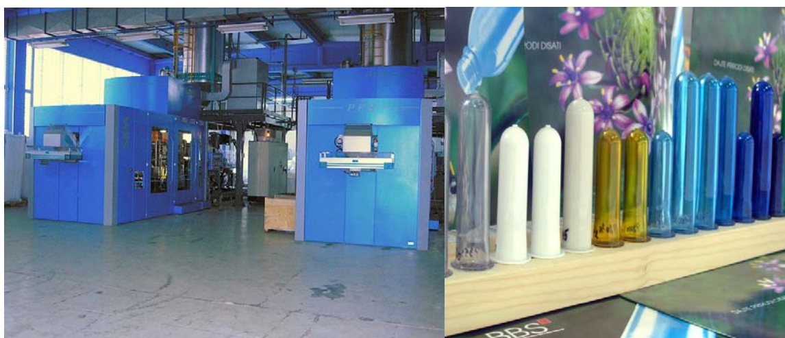
Slika 6.6. Postrojenje za izradu predoblika
