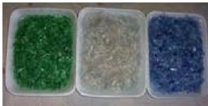
Slika 5.9. Prikaz po boji razvrstane PET mljevine [34]
