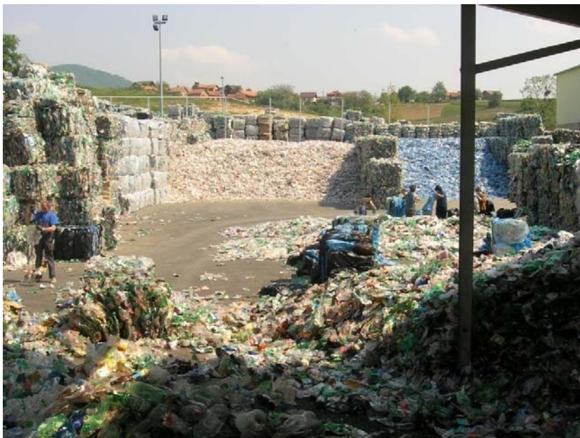
Slika 6.2. Prihvat i razvrstavanje plastične ambalaže
