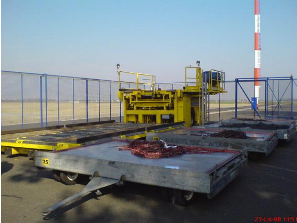
Slika 27. Avio palete na kolicima i valjčani konvejer, na 'zračnoj' strani skladišnog prostora.
