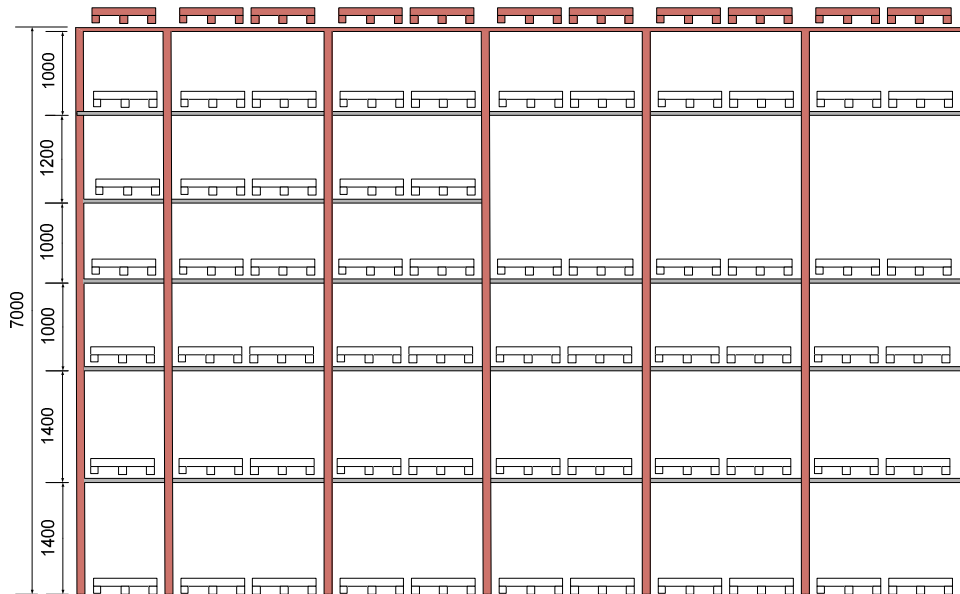
Slika 40. Prijedlog poboljšanja – D – nadogradnja još jednog reda na postojeće regale.
