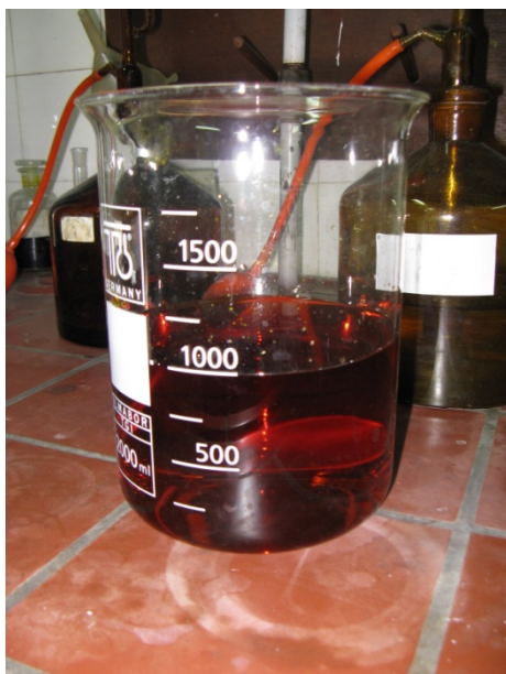
Slika 8.16. Pripremljena otopina prema sjevernoameričkoj normi ASTM G48-99a koja se koristi za ispitivanje jamičaste korozije.
