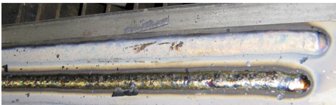
Slika 7.16. Izgled navarene gusjenice PPŽ nakon skidanja troske, donja gusjenica ( I_z = 180 A).
