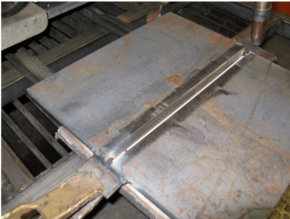
Slika 8.3. Predhodno prikazani sučeljeni spoj nehrđajuće čelične ploče sa keramičkom podlogom u položaju za zavarivanje.
