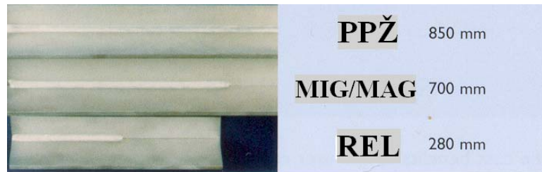
Slika 2.4. Prednost FCAW postupka naprema svim ostalim postupcima zavarivanja. Dobivene duljine zavara uz isti vremenski period zavarivanja. [4]
