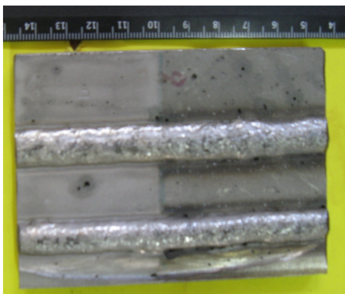
Slika 8.19. Navari izvedeni MIG postupkom uz punu žicu, odnosno uzorci C i D. Jamičasta korozija je zahvatila ZUT i osnovni metal koji je manje plemenit od dodatnog metala.
