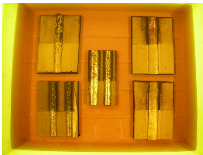
Slika 8.17. Uzorci uronjeni u otopinu u kojoj će ostati slijedećih 72 sata.
