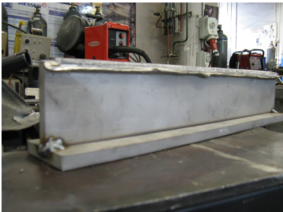
Slika 7.10. Pripremljen i na krajevima učvršćen T spoj kutnog zavora čelika 316Ti (W.Nr. 1.4671).
