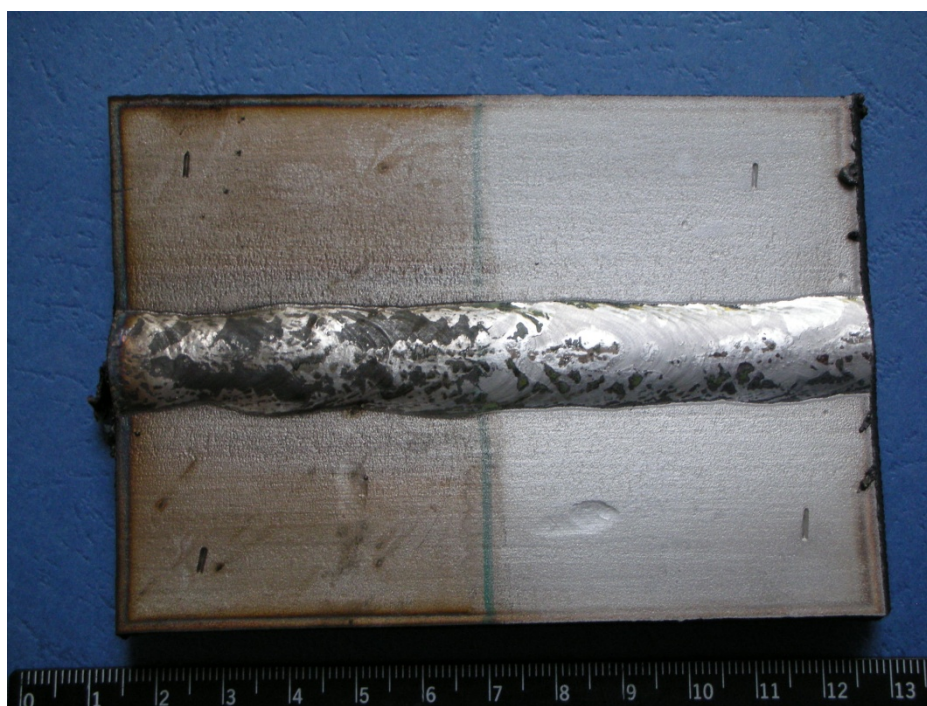
Slika 8.15. Uzorak I je sučeljeni spoj izveden MIG postupkom uz punu žicu.
