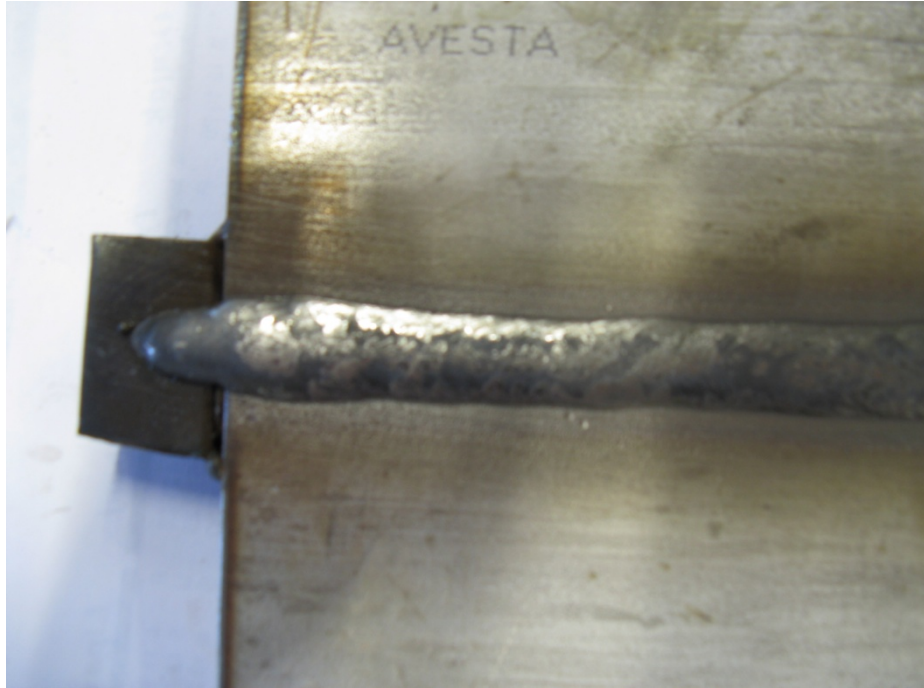
Slika 8.7. Drugi prolaz (popuna) pri zavarivanju MIG postupkom uz punu žicu i razmak u korijenu od 1 mm dao je vrlo dobro nadvišenje lica zavara i dobru popunu.
