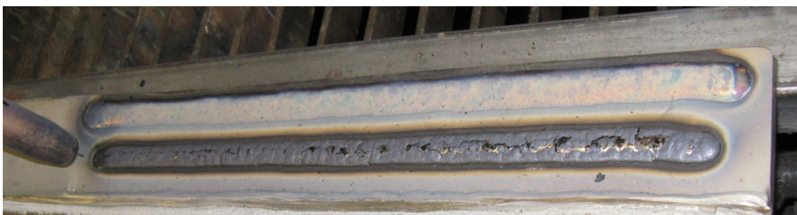
Slika 7.15. Izgled navarene gusjenice PPŽ sa troskom, donja gusjenica ( I_z = 180 A).
