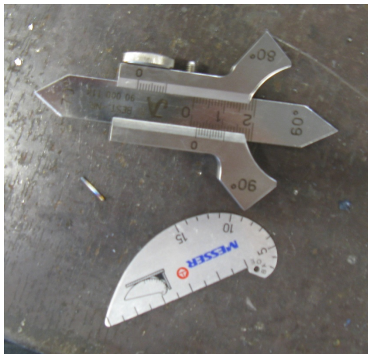
Slika 7.7. Pomična (gornja) i šablonska (donja) mjerka za kontrolu debljine kutnog zavara.
