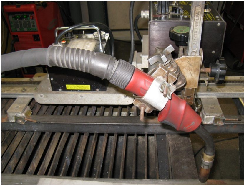
Slika 7.5. Prihvat zavarivačkog pištolja na uređaju Bug-O Systems Bug-5100. Omogućava odabir i mijenjanje kutova postavljanja zavarivačkog pištolja, udaljenost sapnice od radnog komada,...
