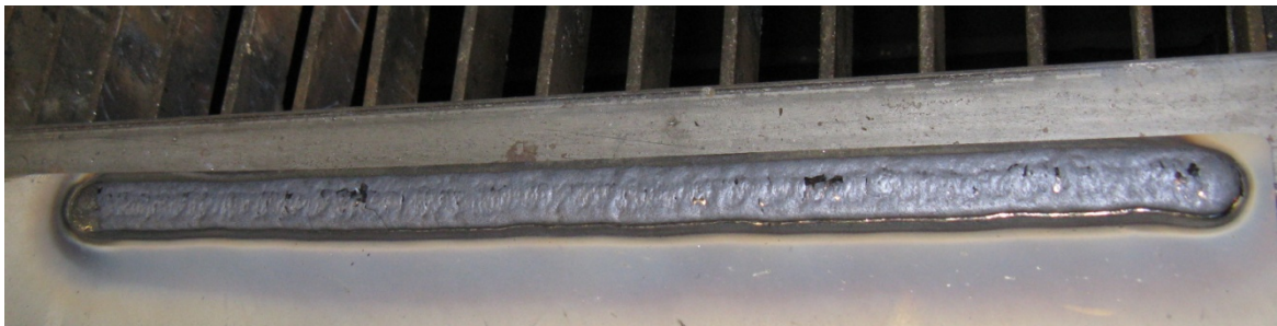
Slika 7.13. Navarena gusjenica PPŽ na sebi ima lako skidajuću trosku koja će se odstraniti ( I_z = 235 A ).
