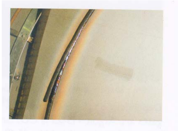
Slika 3.4. Primjer samoskidajuće troske zavara. [4]
