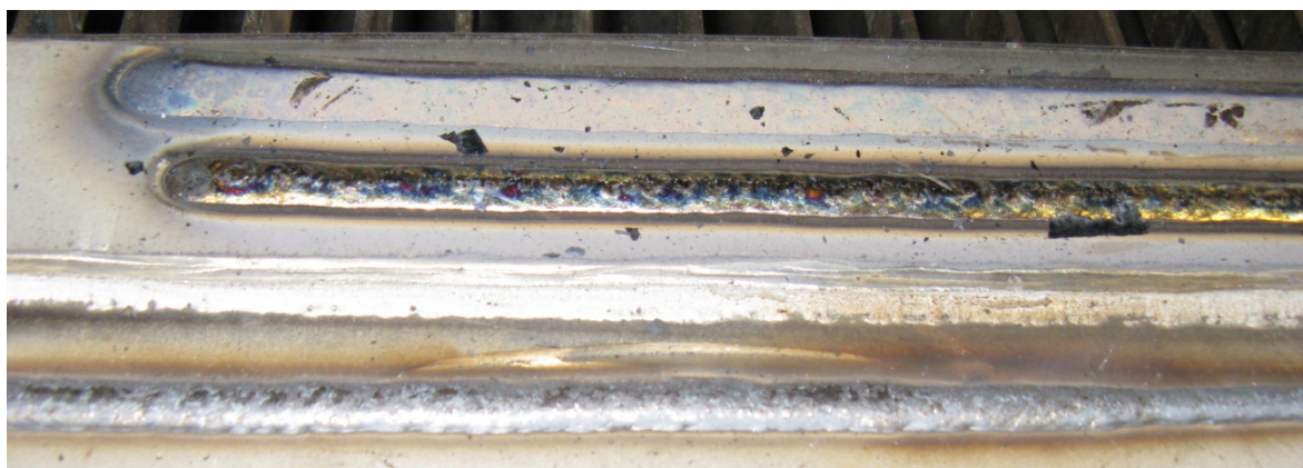
Slika 7.17. Izgled navarene gusjenice pune žice, najdonja gusjenica ( I_z = 180 A).
