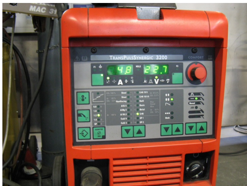
Slika 7.3. Kontrolna ploča uređaja za zavarivanje omogućava odabir i namještanje parametara zavarivanja.
