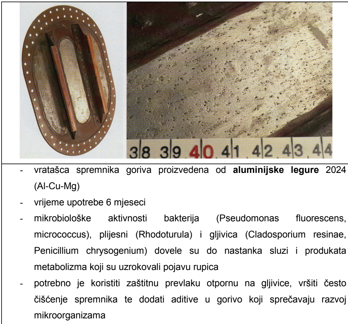
Slika 5-8 Vratašca zrakoplovnog spremnika goriva[7]
