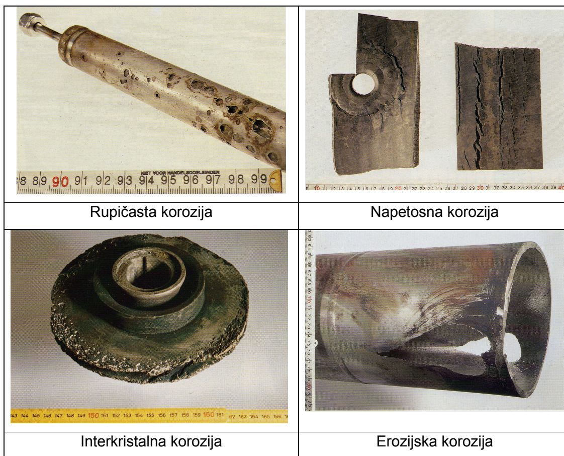
Slika 3-5 Pojavni korozijski oblici na niklu i njegovim legurama[7]
