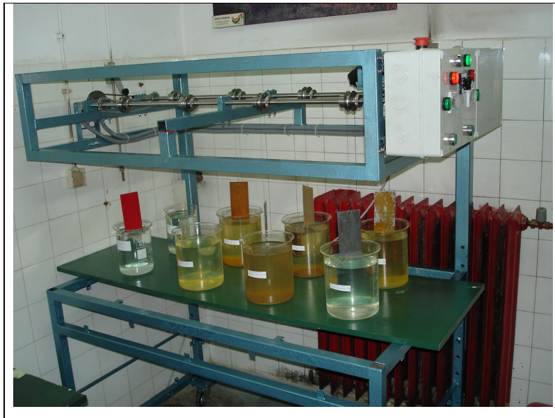
Slika 7-6 Ispitivanje uranjanjem u 3.5% -tnoj otopini NaCl[22]
