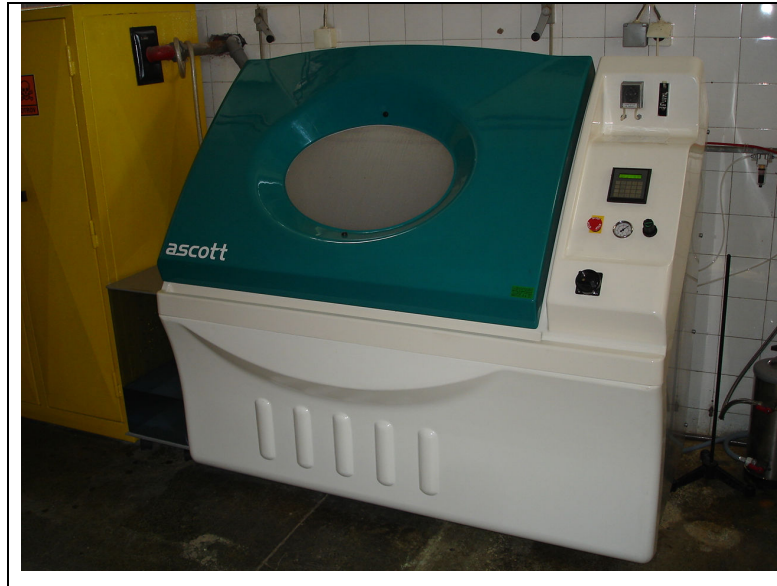
Slika 7-3 Slana komora u Laboratoriju za zaštitu materijala Fakulteta strojarstva i brodogradnje u Zagrebu[22]
