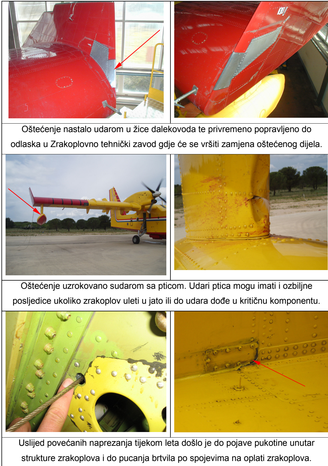
Slika 6-9 Oštećenja tijekom eksploatacije[21]
