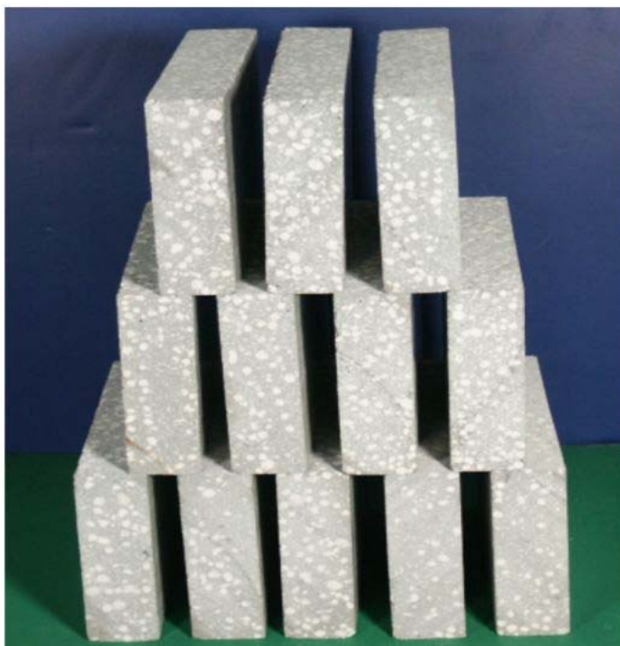
Slika 4.12 Mješavina cementa i polistirena [30]
