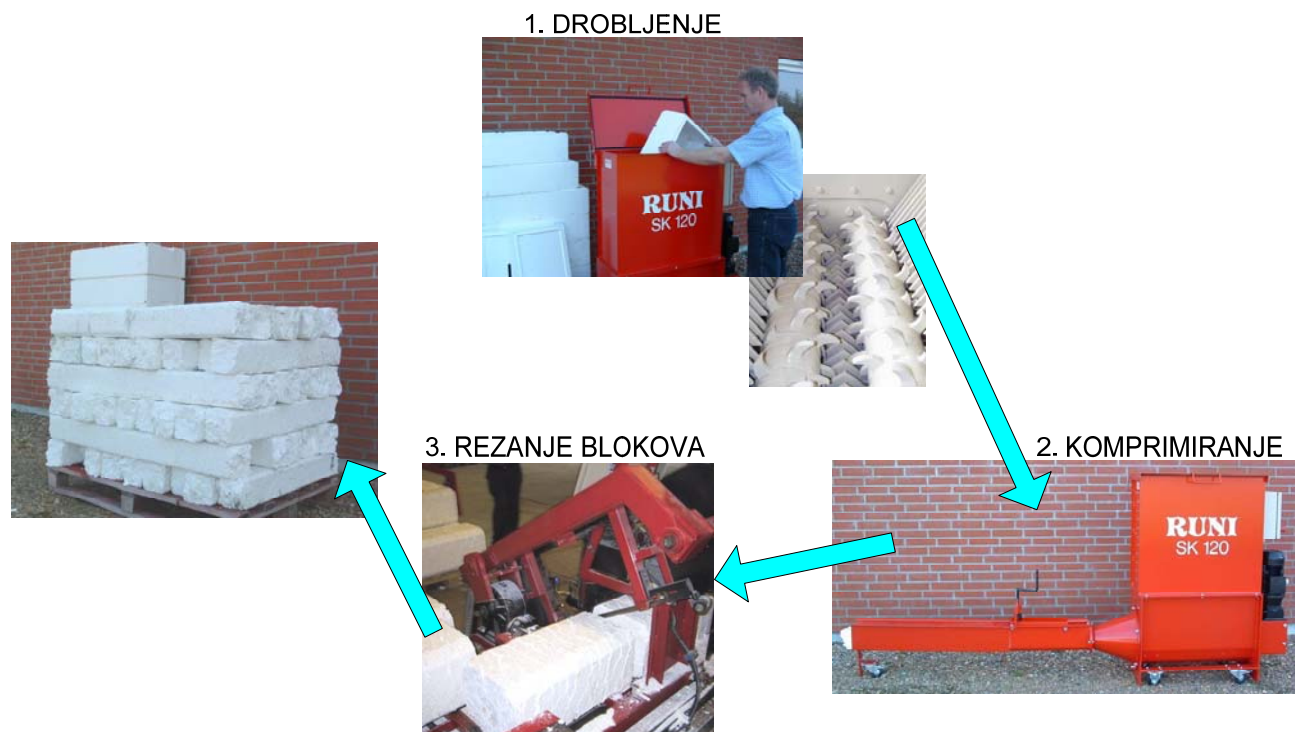
Slika 4.15 Hladno komprimiranje [34]
