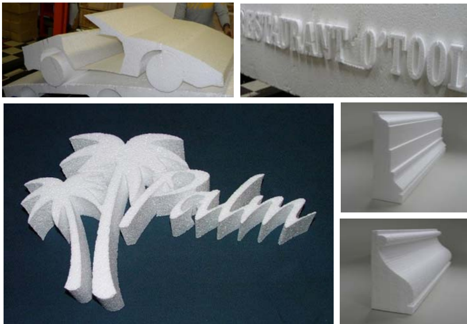
Slika 3.12 Proizvodi dobiveni rezanjem s vrućom žicom [14]
