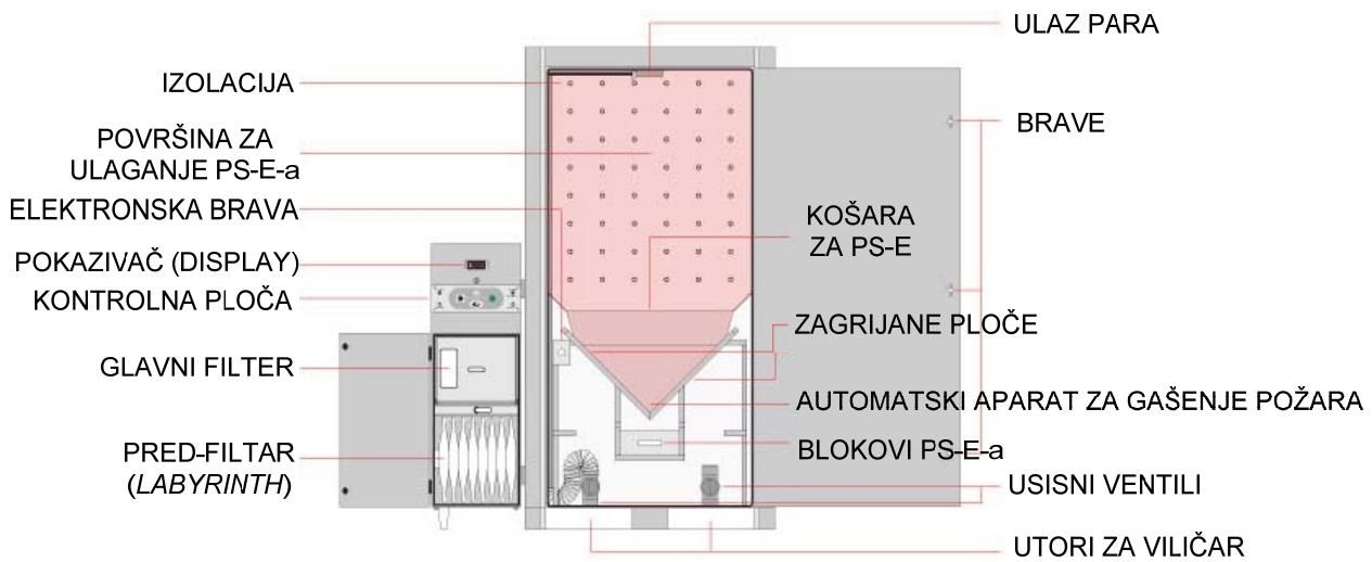
Slika 4.18 Presjek *Styromelta* [35]
