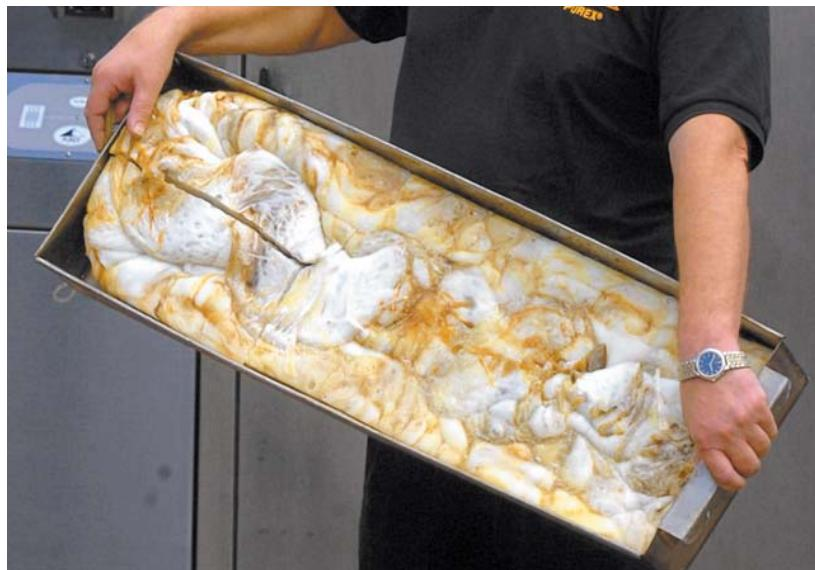
Slika 4.16 Blok PS-E-a nakon izlaza iz styromelta [35]
