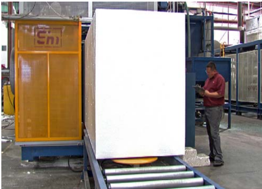
Slika 3.10 Kalupljenje u blokovima [12]
