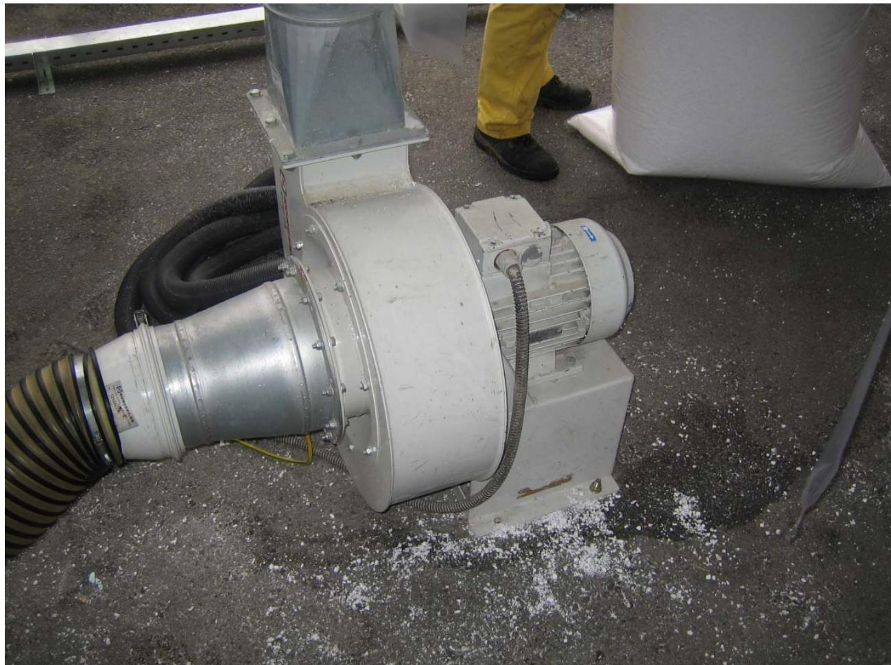
Slika 5.11 Ventilator za transport usitnjjenog PS-E-a
