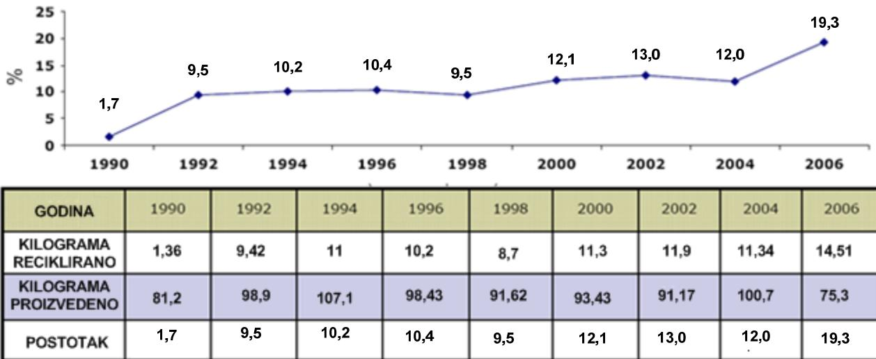
Slika 4.5 Postotak recikliranog u odnosu na proizvedeni PS-E [31]
