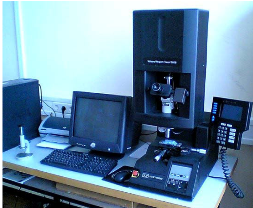
Slika 24. Mirkotvrdomijer Instron, Wilkon-Wolpert Tukon 2100B
