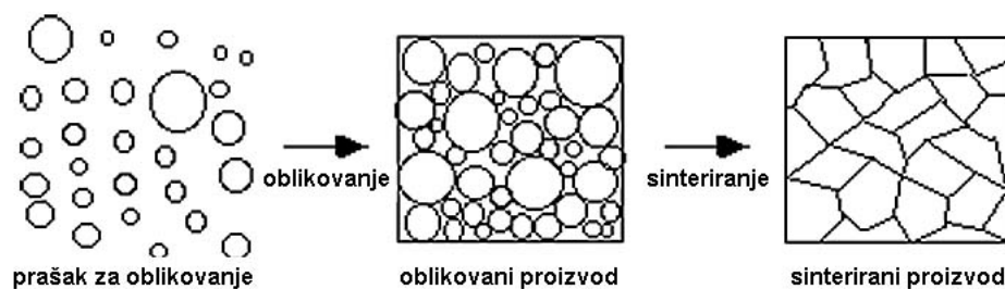
Slika 11. Zgušnjavanje mase oblikovanjem za daljnju obradu (sinteriranje) [4]
