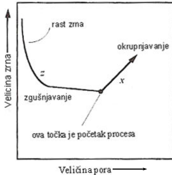
Slika 18. Ovisnost vremenskog razvoja zrna i pora: okrupnjavanje vodi k povećanju i zrna i pora, dok zgušnjavanje uklanja pore[4]
