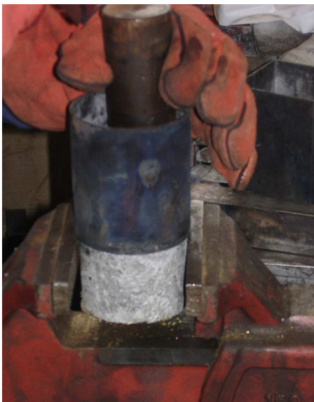
Slika 7.13. Izbijanje cilindričnog uzorka iz kalupa
