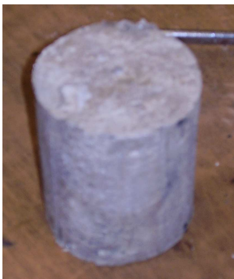
Slika 7.3. Uzorak aluminijske pjene izvađen iz kalupa
