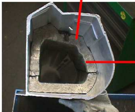
Slika 2.9. Kruti uložak na okviru osobnog automobila izrađen od metalne ALULIGHT pjene (povećava krutost i čvrstoću pokazanog dijela) /7/
