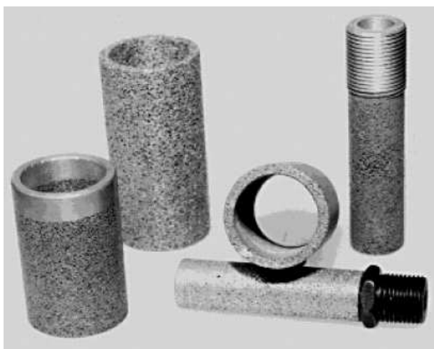
Slika 5.10. Prigušivači zvuka od aluminijskih pjena /6/
