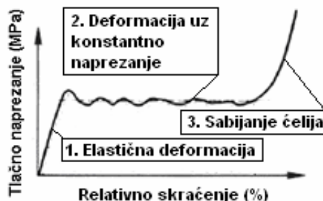
Slika 6.8. Dijagram tlačnog naprezanja i tlačne deformacije metale pjene
