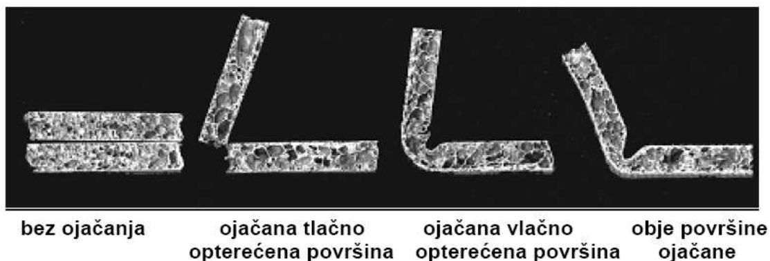
Slika 3.11. Ojačane Al pjene nakon udarnog opterećenja /18/
