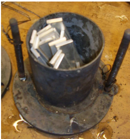
Slika 7.2. Čelična cijev pripravljena za kalupljenje
