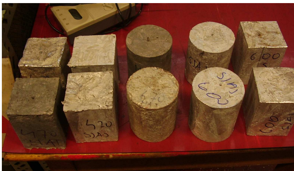
Slika 7.14. Uzorci aluminijskih pjena različite gustoće, materijala i oblika
