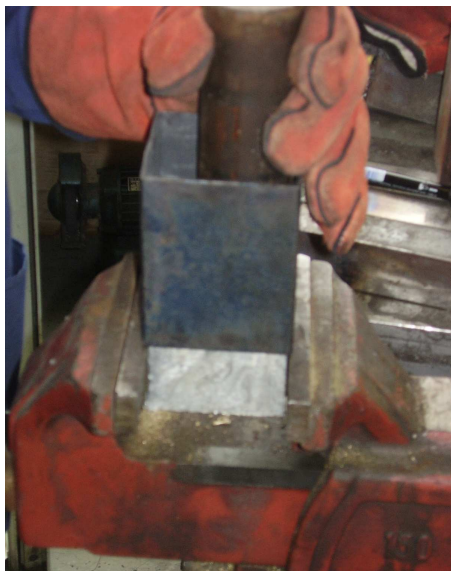
Slika 7.12. Izbijanje kvadratnog uzorka iz kalupa
