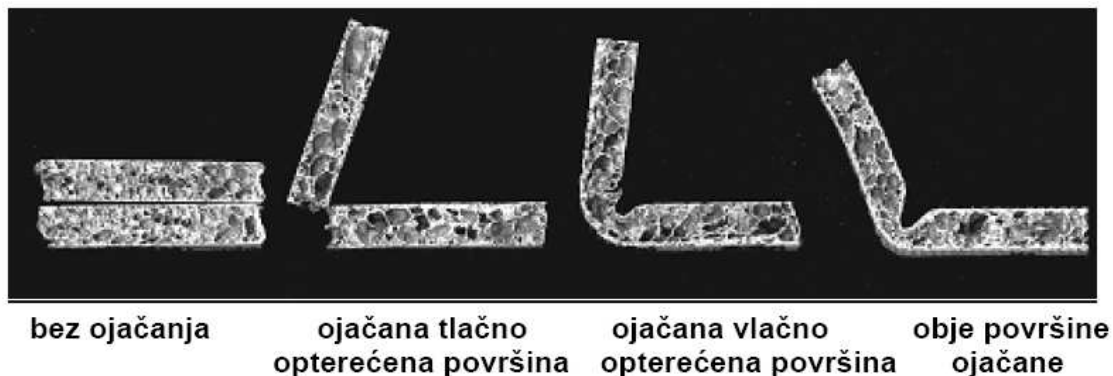
Slika 3.11. Ojačane Al pjene nakon udarnog opterećenja /18/
