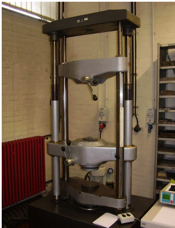
Slika 6.5. Kidalica u Laboratoriju za ispitivanje materijala (FSB Zagreb) proizvođač : WPM Njemačka, model : EU 40 mod
