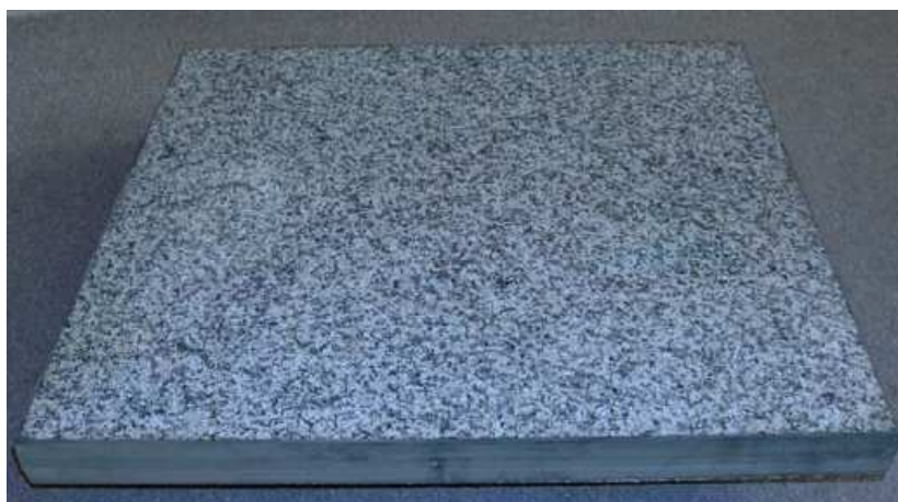
Slika 5.6. Grijaća ploča izrađena od ALPORAS ojačane pjene /20/
