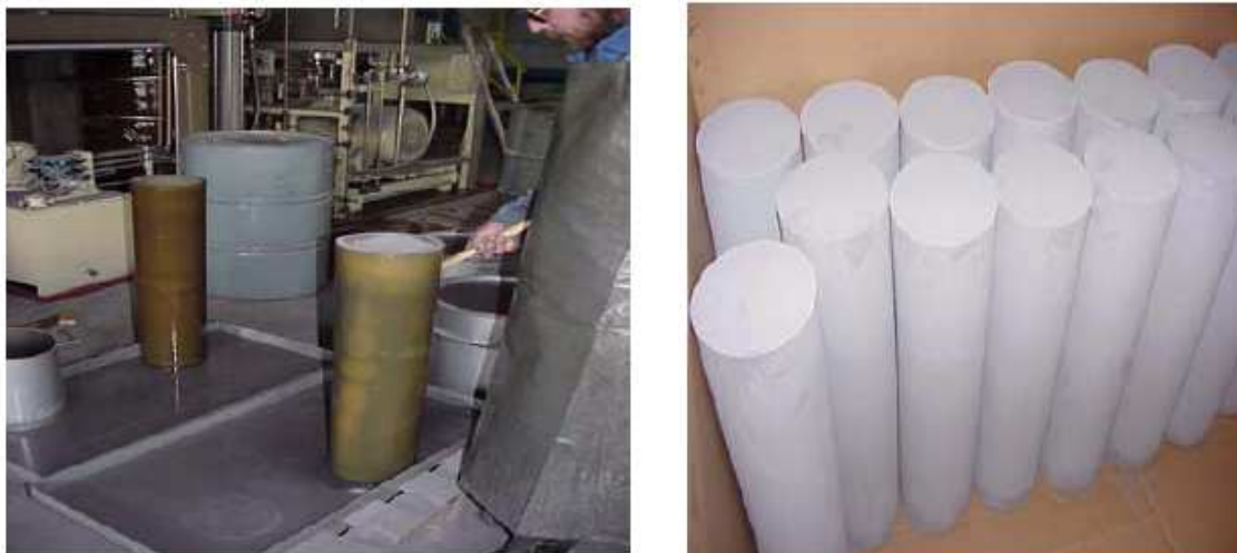
Slika 2.6. Stvaranje trupaca izostatičkim prešanjem (100 MPa) mješavine prahova /7/
