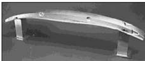
Slika 5.4. Branik automobila izrađen od aluminijske pjene /23/
