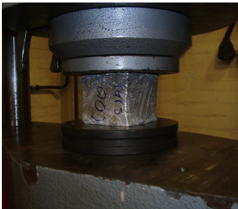
Slika 7.17. Kvadratni uzorak za vrijeme ispitivanja
