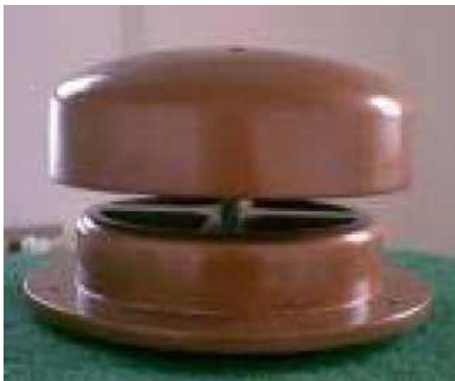
Slika 5.8. Plovak izrađen od metalne pjene /20/
