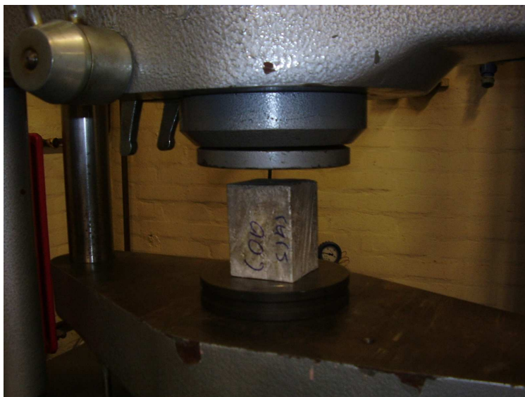
Slika 7.16. Kvadratni uzorak prije početka ispitivanja
