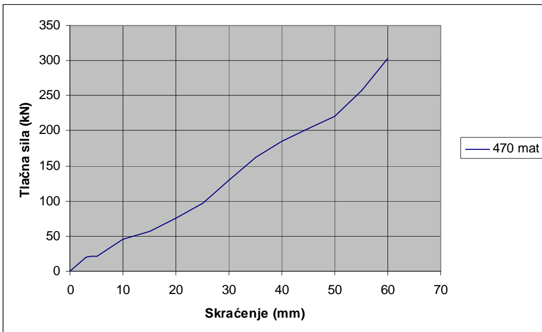
Slika 7.28. Dijagram srednje vrijednosti za cilindrične uzorke 470 mat
