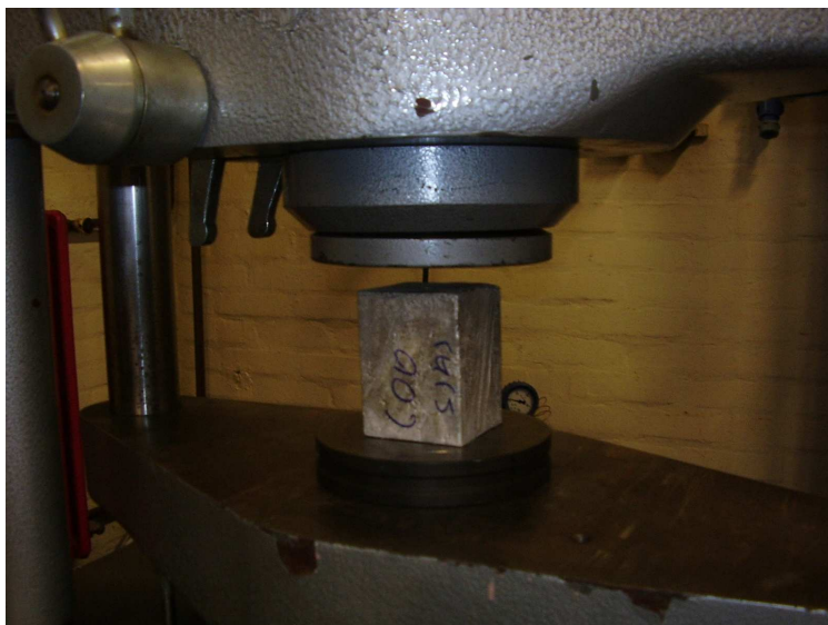
Slika 7.16. Kvadratni uzorak prije početka ispitivanja
