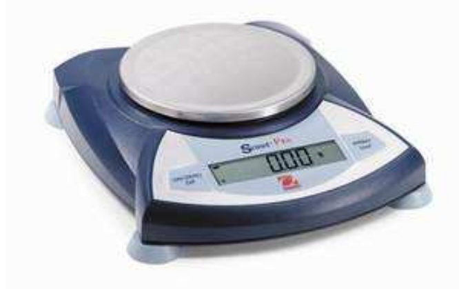
Slika 7.6. Vaga (Scout Pro) za mjerenje mase prekursora
