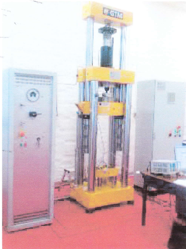
Slika 8: Referentni etalon sile u Hrvatskoj (LIMS)
