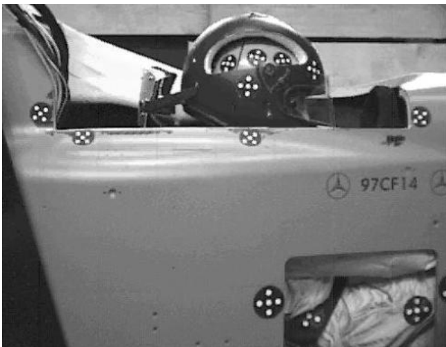
Slika 32. Kretanje glave unaprijed kod testiranja ovratnika verzije 2.5 [6].
