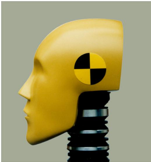
Slika 9. Mehanički modeli vrata i glave - Hybrid HI [20].
