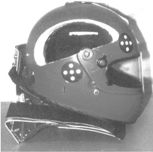
Slika 39. Ovratnik verzije 2.4 – prototip proizveden od kompozita i aluminija nakon testa 97CF13 [6].
