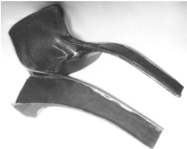
Slika 40. Ovratnik verzije 3.0 – prototip napravljen od kompozita prije montiranja na kacigu i testa 97CF20 [6].
