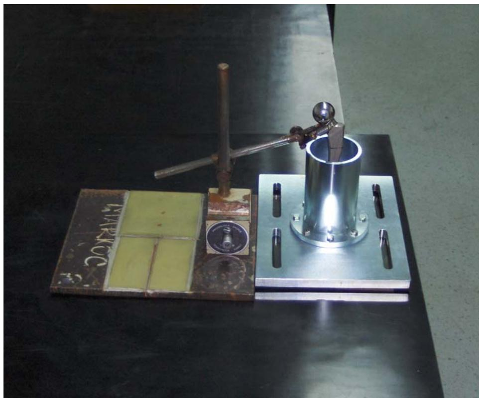
Slika 33. Pozicionirana endoproteza zglobo kuka na improviziranom staku
