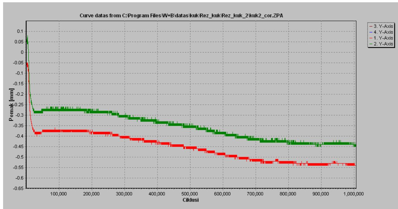
Slika 39. Dijagram pomak–ciklusi za cementni otkivak endoproteze Müller izrađene iz nehrđajućeg (CrNi) čelika
