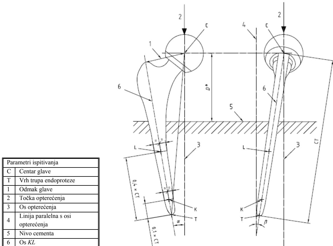
Slika 27. Orientacija ispitnog uzorka tijekom ispitivanja
