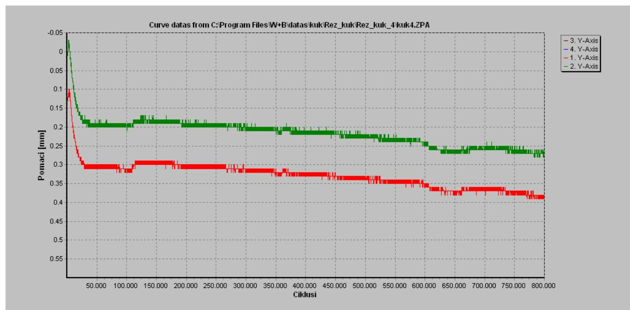
Slika 41. Dijagram pomak–ciklusi za endoprotezu Müller rezanu iz ploče izrađenu iz slitine Ti<sub>6</sub> Al<sub>4</sub>V
