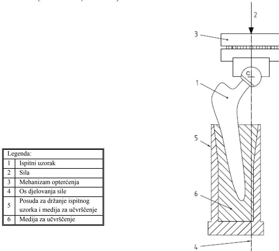
Slika 26. Glavne odredbe ispitnog uzorka za ispitivanja
