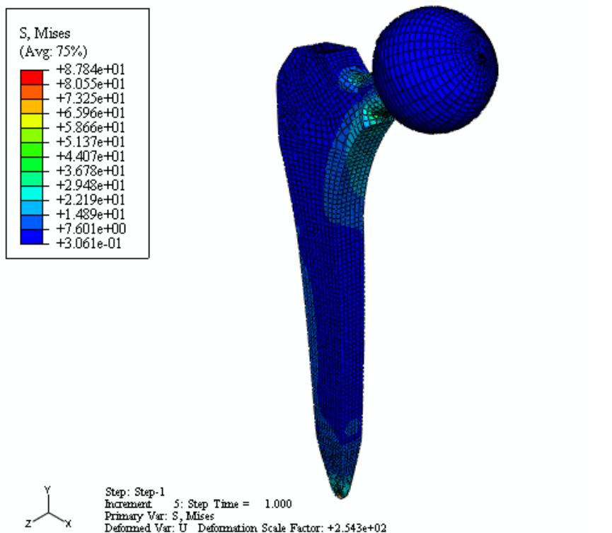
Slika 59. Naprezanje po Misesu pri opterećenju od 1000 N
