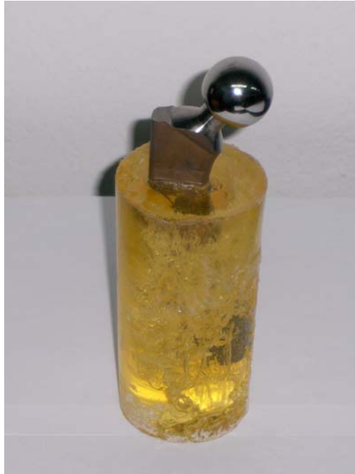
Slika 37. Odljevak endoproteze Müller izrađene iz nehrđajućeg (CrNi) čelika i epoksidna smola nakon ispitivanja
