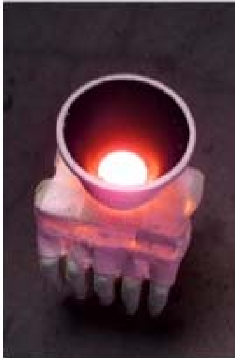
Slika 21. Električno lijevanje u kalup za izradu endoproteza
