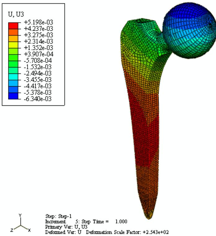
Slika 55. Horizontalni pomaci u smjeru osi z na endoprotezi zglobo kuka pri opterećenju od 1000 N
