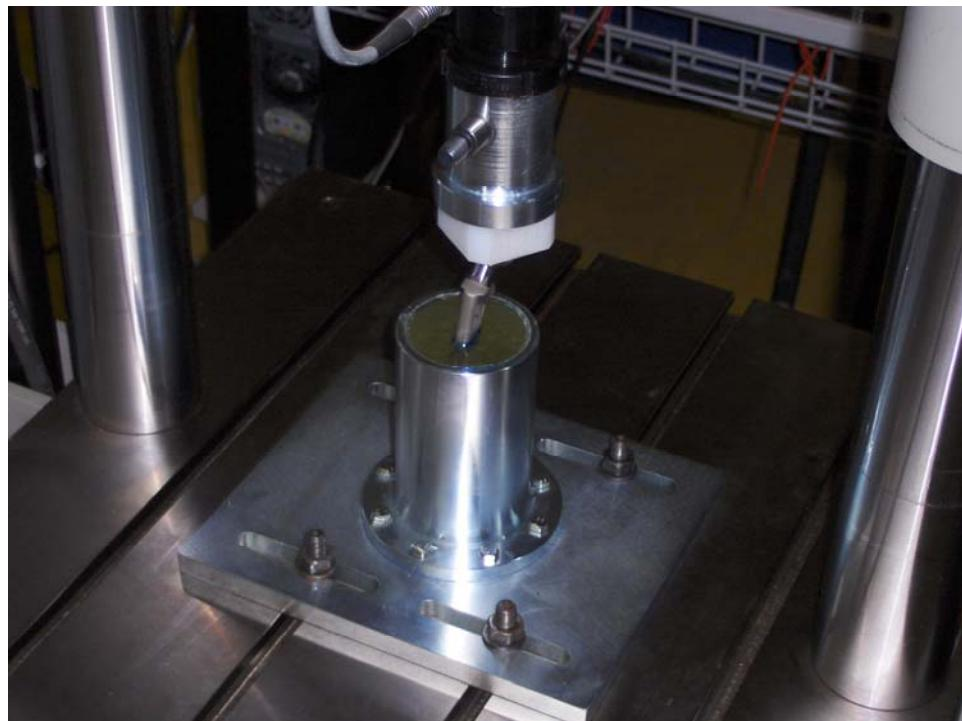
Slika 34. (B) Kolinearnost centra glave endoproteze i osi opterećenja dinamičke kidalice
