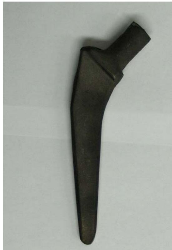
Slika 24. Endoproteza Müller izrađena kovanjem iz slitine Ti<sub>6</sub> Al<sub>4</sub>V
