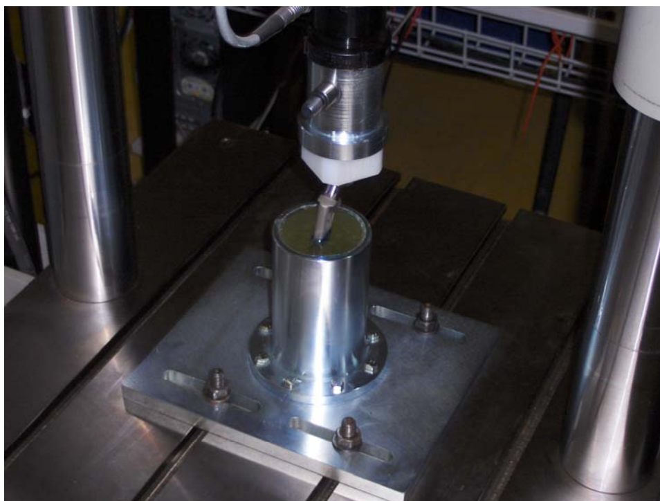
Slika 34. (B) Kolinearost centra glave endoproteze i osi opterećenja dinamičke kidalice
