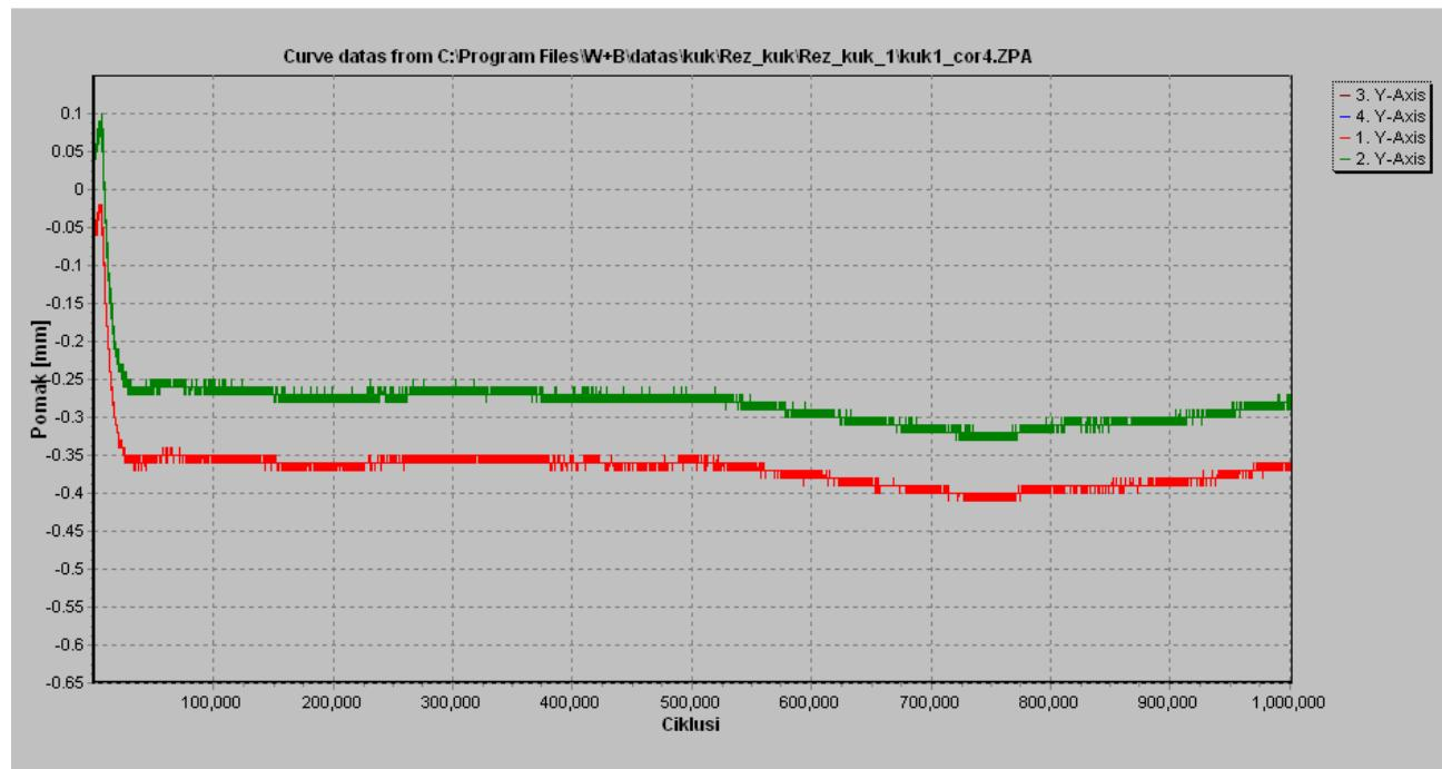
Slika 38. Dijagram pomak–ciklusi za cementni odljevak endoproteze Müller izrađene iz slitine CoCrMo
