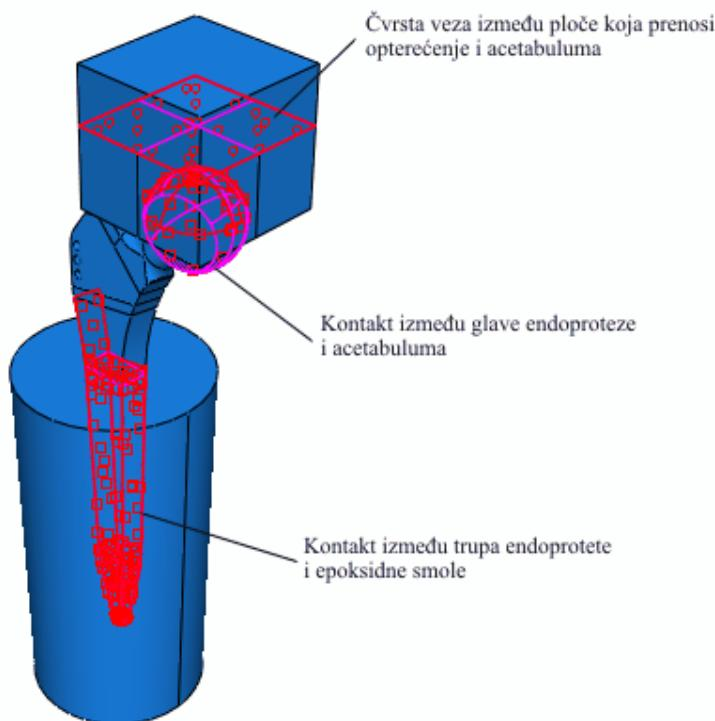
Slika 51. Kontaktne površine
