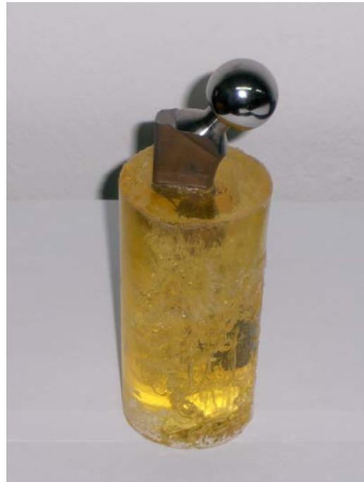
Slika 37. Odljevak endoproteze Müller izradene iz nehrđajućeg (CrNi) čelika i epoksidna smola nakon ispitivanja
