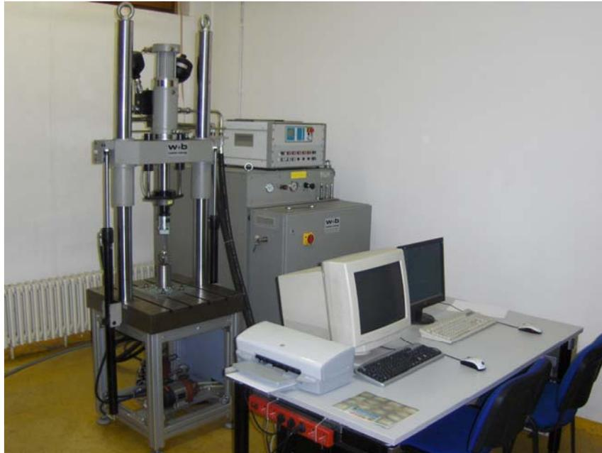
Slika 35. Servohidraulička kidalica LFV 50-HH s upravljačkom jedinicom
