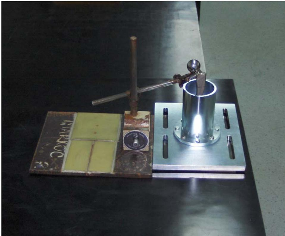
Slika 33. Pozicionirana endoproteza zgloba kuka na improviziranom stalku
