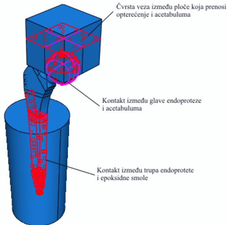
Slika 51. Kontaktne površine
