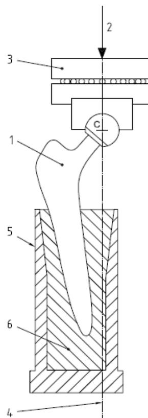
Slika 26. Glavne odredbe ispitnog uzorka za ispitivanja
