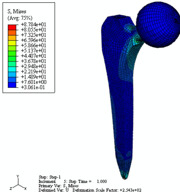
Slika 59. Naprezanje po Misesu pri opterećenju od 1000 N
