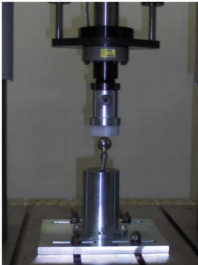
Slika 34. (A) Kolinearnost centra glave endoproteze i osi opterećenja dinamičke kidalice
