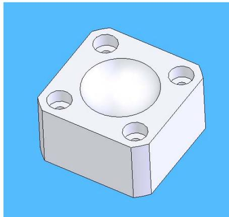
Slika 32. Polietilenski dio konektora za opterećenje glave endoproteze
