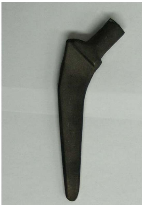
Slika 24. Endoproteza Müller izrađena kovanjem iz slitine  $Ti_6 Al_4V$
