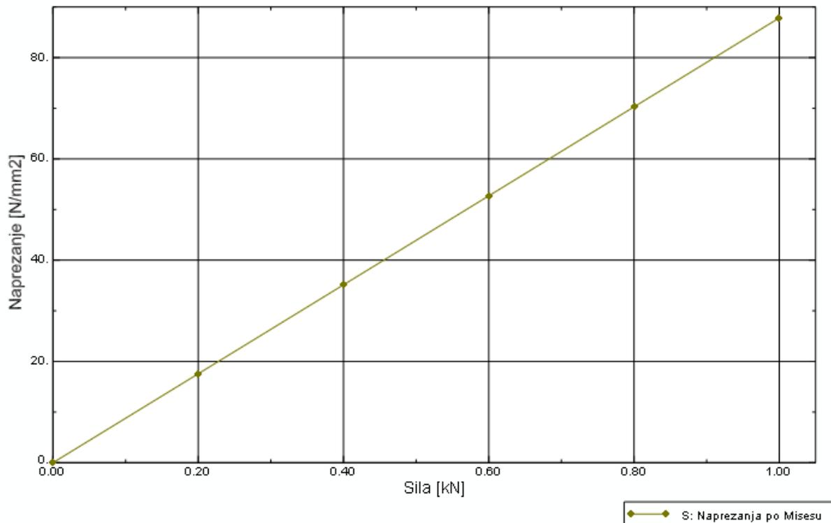
Slika 60. Dijagram ovisnosti naprezanje o sili
