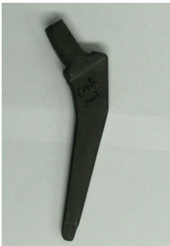
Slika 23. Endoproteza Müller izrađena iz nehrđajućeg (CrNi) čelika
