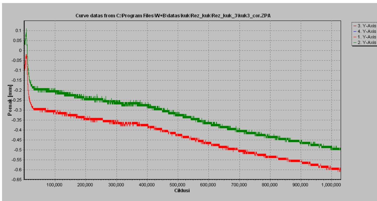
Slika 40. Dijagram pomak–ciklusi za otkivak endoproteze Müller izrađene iz slitine Ti<sub>6</sub> Al<sub>4</sub>V
