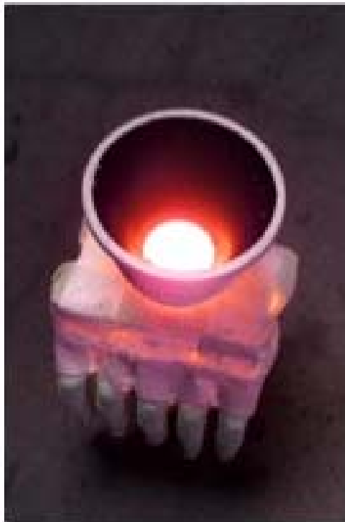
Slika 21. Električno lijevanje u kalup za izradu endoproteza
