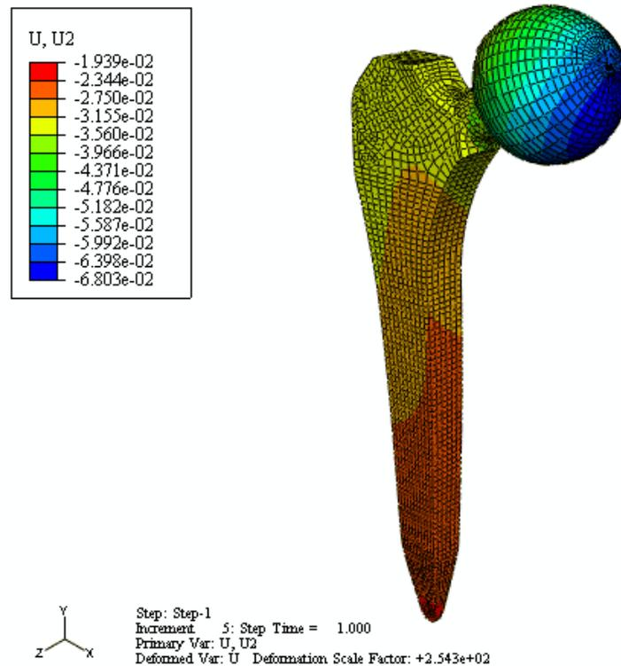
Slika 53. Vertikalni pomaci na endoprotezi zgloba kuka pri opterećenju od 1000 N
