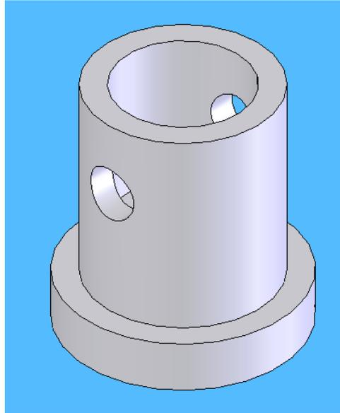
Slika 31. Metalni dio konektora za opterećenje glave endoproteze
