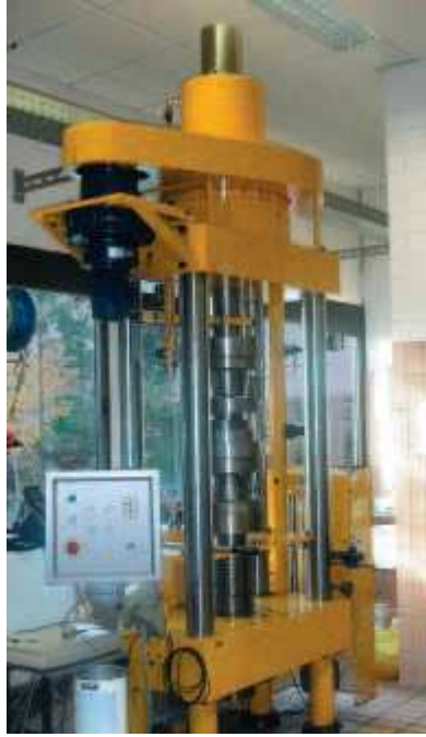
Slika 7: Referentni etalon sile s hidrauličnim mehanizmom opterećenja proizvođača GTM smješten u LBF – u (Njemačka) [8]
