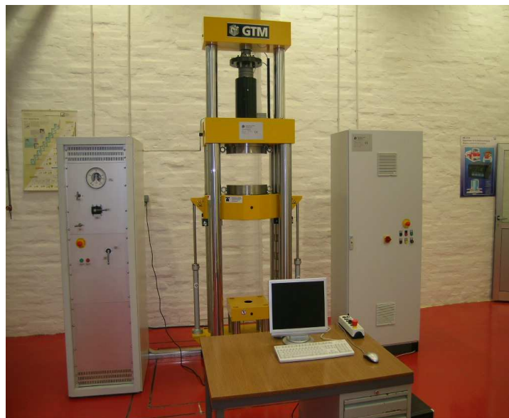
Slika 12: Referentni etalon sile u LIMS – u [5]
