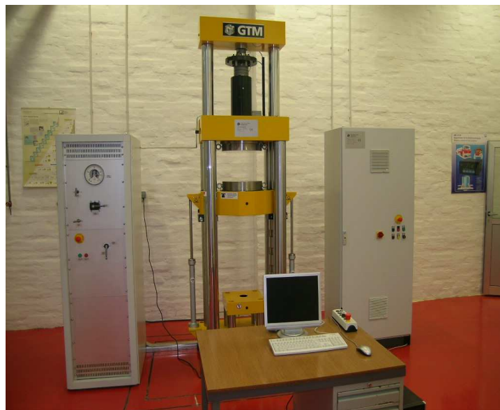
Slika 12: Referentni etalon sile u LIMS – a [5]
