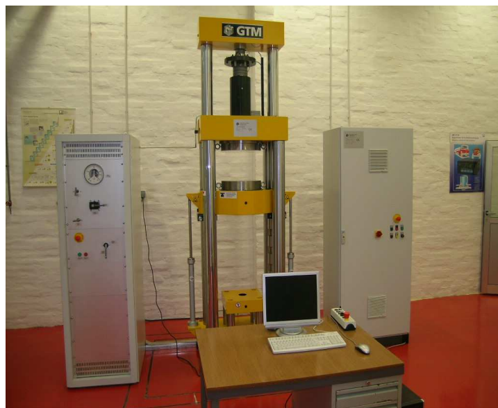
Slika 8: Referentni etalon sile komparatornog tipa nazivne sile 500 kN proizvođača GTM smješten u LIMS – u [5]
