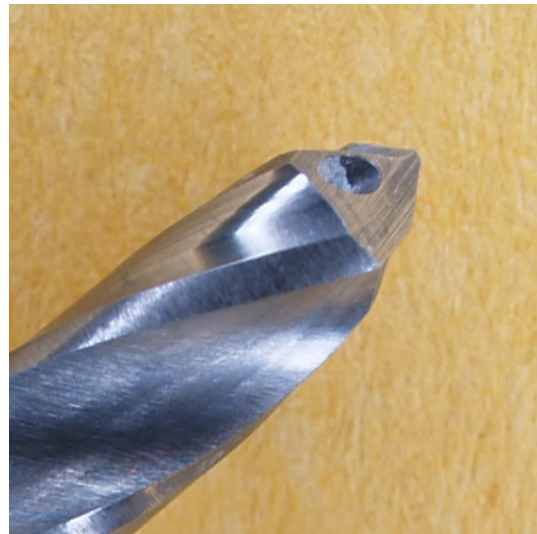
Slika 80. Oštrica prvog stupnja dvostupnjevanog spiralnog svrdla promjera 2,5-3,4 mm nakon 360 mjerenja
