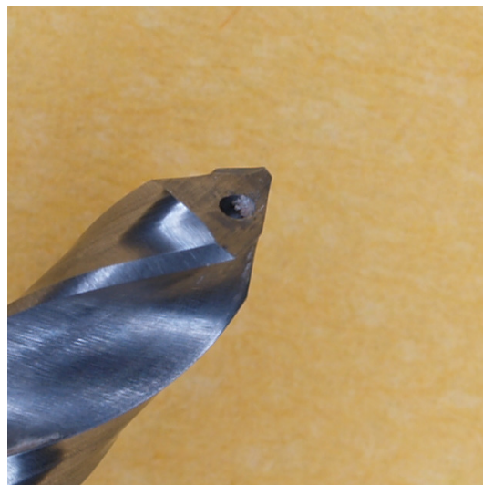
Slika 84. Oštrica prvog stupnja dvostupnjevanog spiralnog svrdla promjera 3,4-4,5 mm nakon 360 mjerenja
