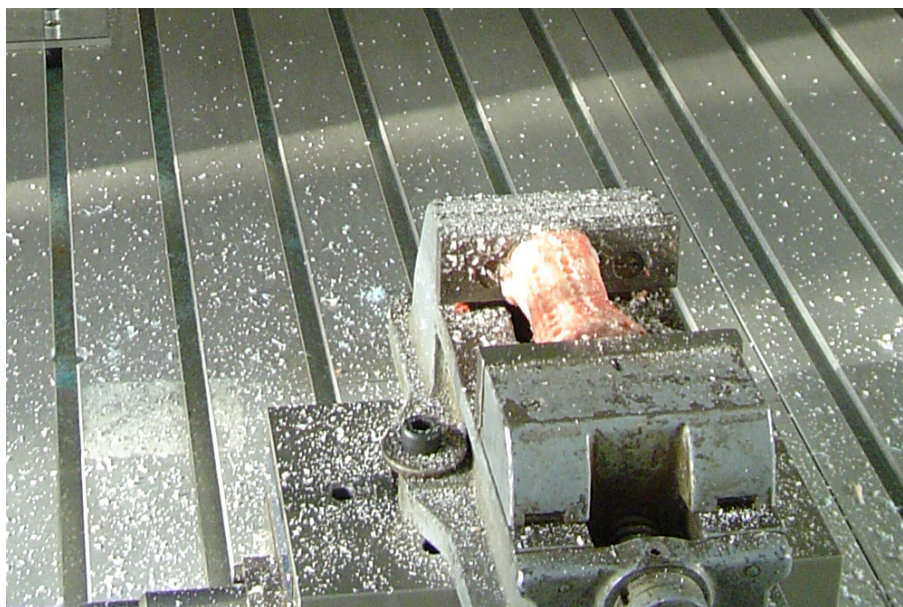
Slika 51. Stezna naprava pričvršćena na radni stol i kost stegnuta u njoj [28]
