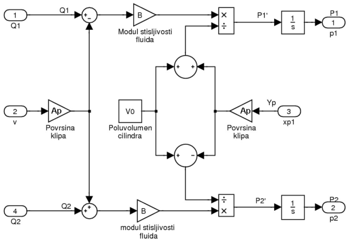
Slika 6.2 – SIMULINK shema jednadžbi promjene tlakova
