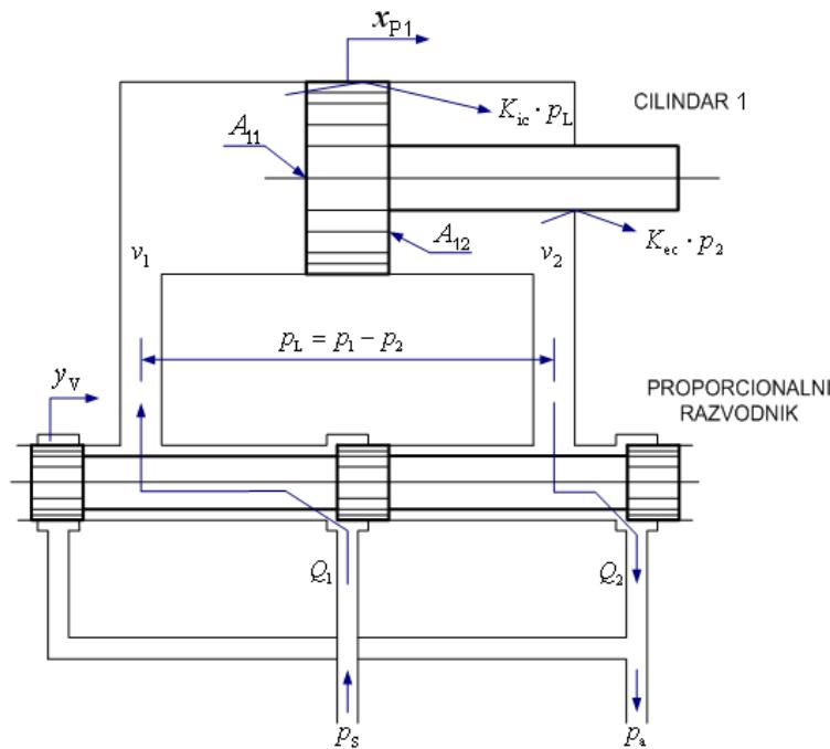
Slika 5.1 – Hidraulički cilindar 1 upravljan proporcionalnim razvodnikom
