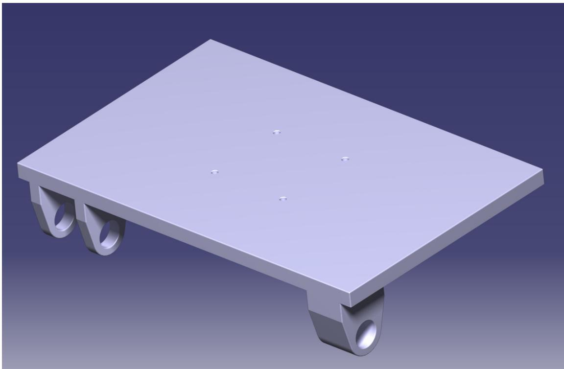
Slika 2.3 – Prikaz CAD modela ploče postolja
