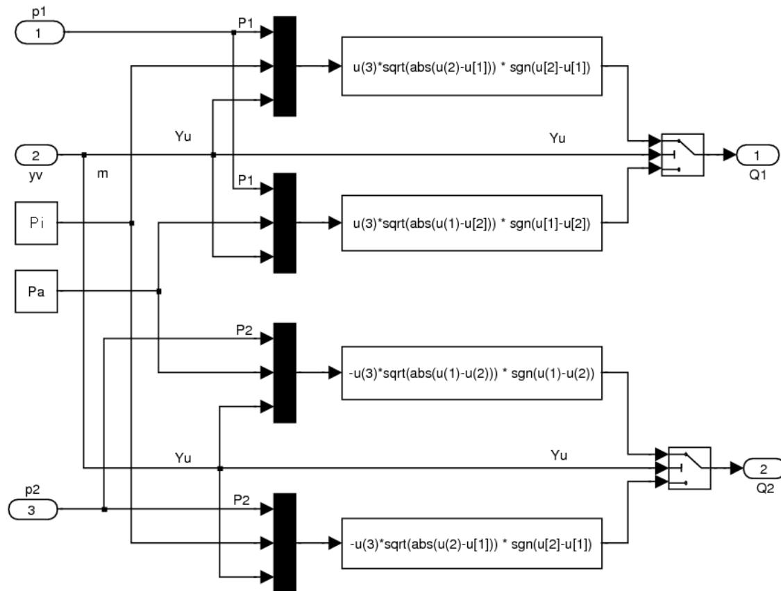
*Slika 6.1 – SIMULINK shema jednadžbi protoka kroz proporcionalni ventil*
