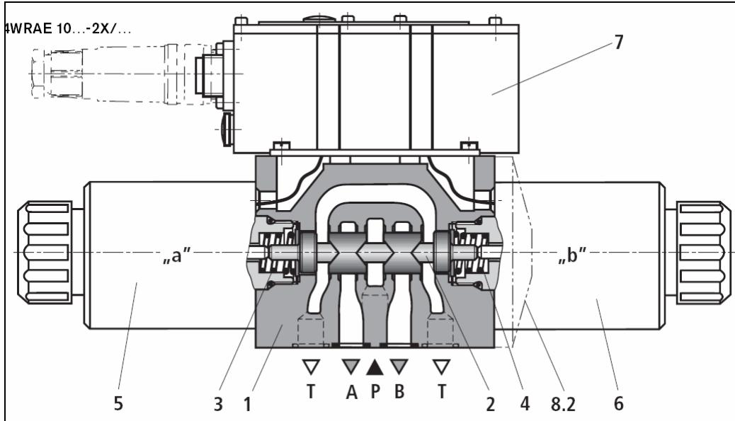
Slika 4.1 – Direktno upravljeni proporcionalni razvodni ventil
