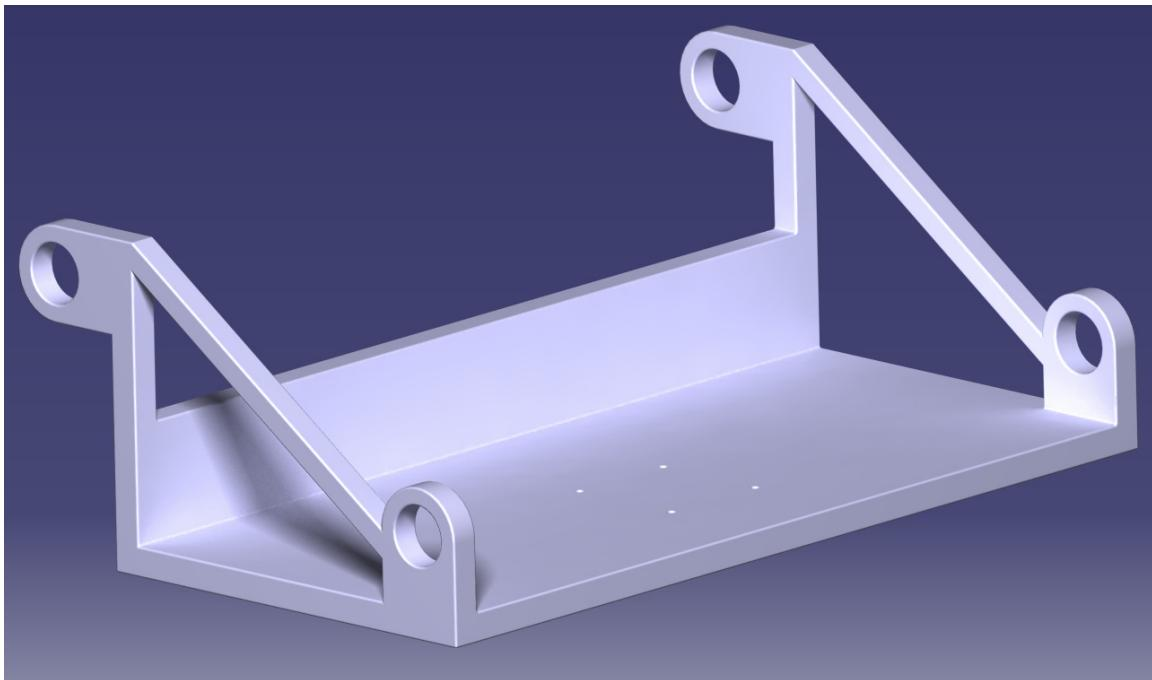
Slika 2.2 – Prikaz CAD modela pokretnog podvozja postolja
