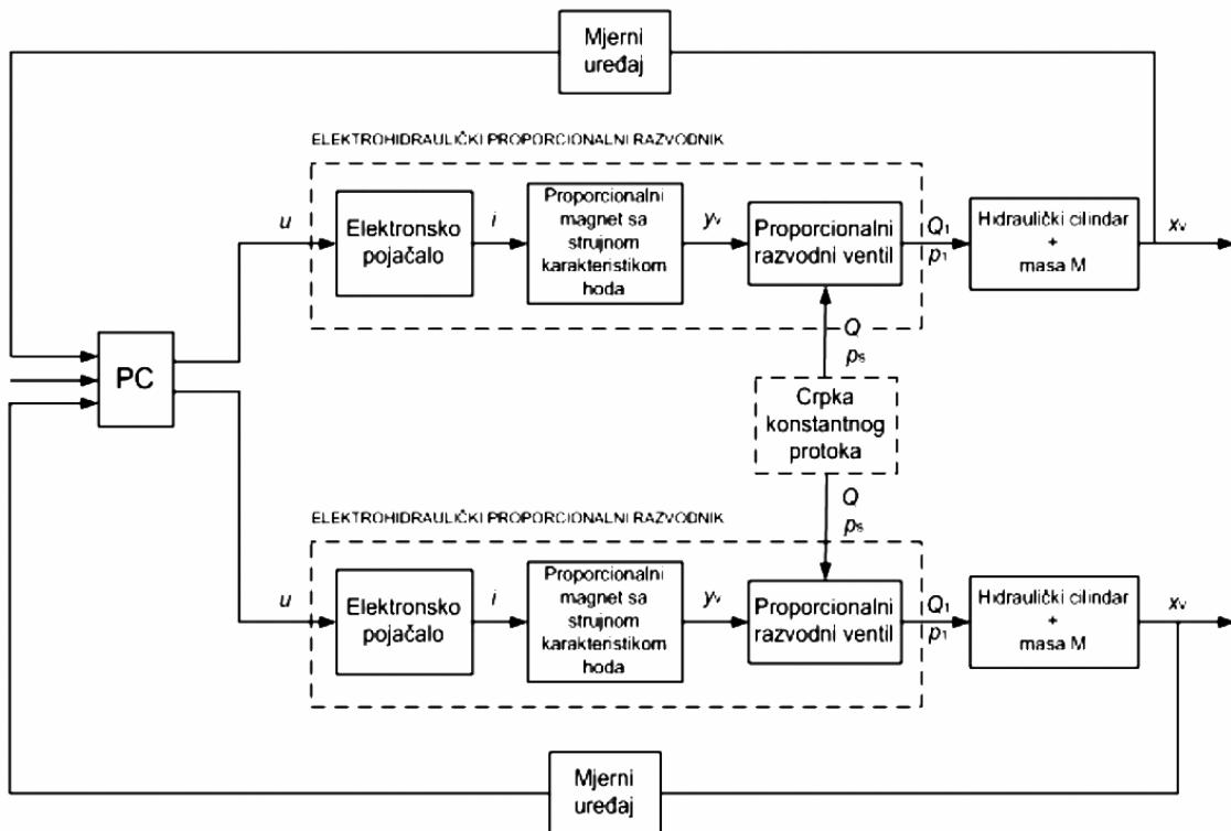
Slika 3.1 – Funkcionalna shema elektrohidrauličkog servosustava oba cilindra
