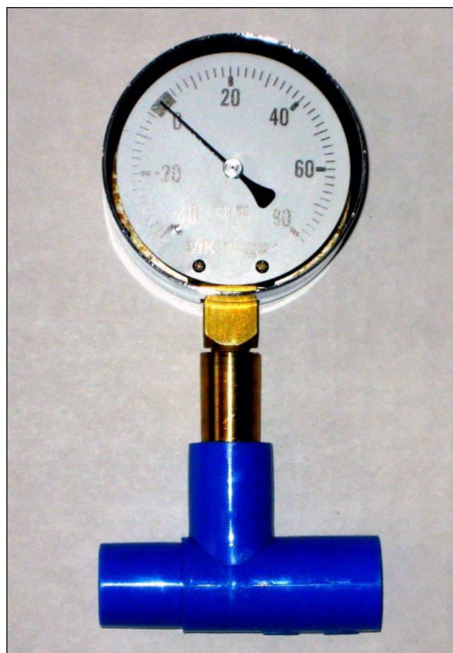
Slika 3.11 – Analogni manometar
