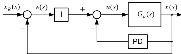
Slika 7.1 – Blok dijagram modificirane (I+PD) strukture regulatora
