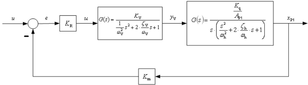
Slika 5.2 – Blok-shema EHSS-a s prijenosnim funkcijama komponenata za cilindar 1
