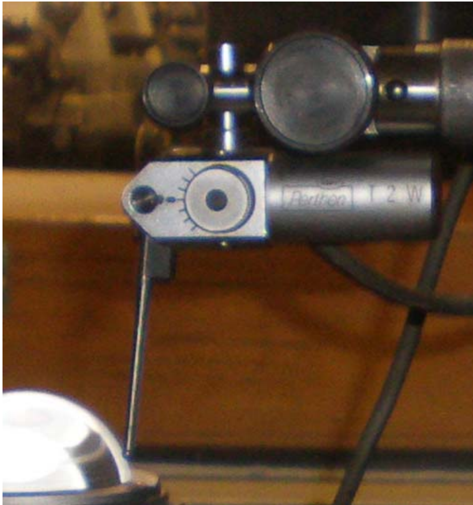
Slika 31. Induktivno ticalo i ruka ticala
