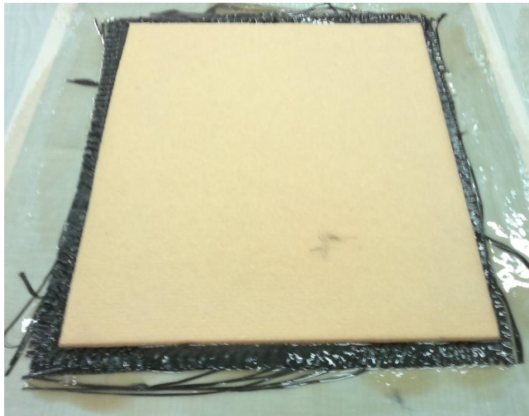
Slika 14 – Izrada sendvič konstrukcije
