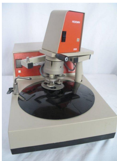
Slika 20 - Uređaj za brušenje i poliranje (Struers DAP-V)
