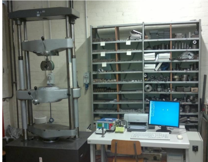
Slika 34 - Uređaj za statičko-vlačno ispitivanje (WPM - EU 40)
