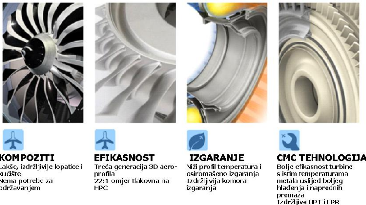
Slika 4.21. Prednosti LEAP-a mjerena kroz aerodinamiku i tehnologiju materijala
