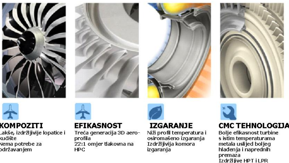
Slika 4.21. Prednosti LEAP-a mjerena kroz aerodinamiku i tehnologiju materijala
