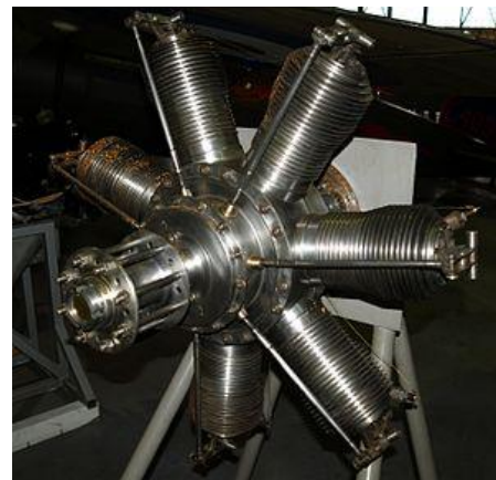
Slika 1.6. Rotacijski Gnome Omega motor iz osam litara razvijao je 50 KS [5]
