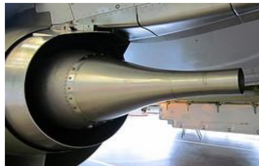
Slika 2.6. Najnoviji tip mlaznice na Boeingu 737 može smanjiti potrošnju za 2%
