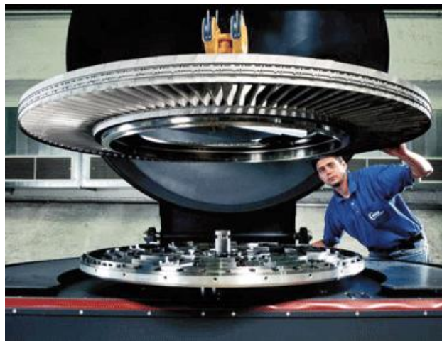
Slika 4.18. Jedan stupanj visokotlačne turbine
