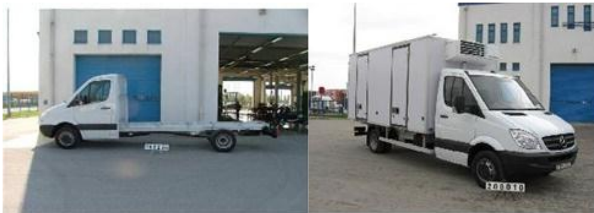
Slika 8. Primjer vozila koje podliježe višestupanjskoj homologaciji prikazanog u dvije faze – nepotpuno vozilo (lijevo), dovršeno vozilo (desno)
