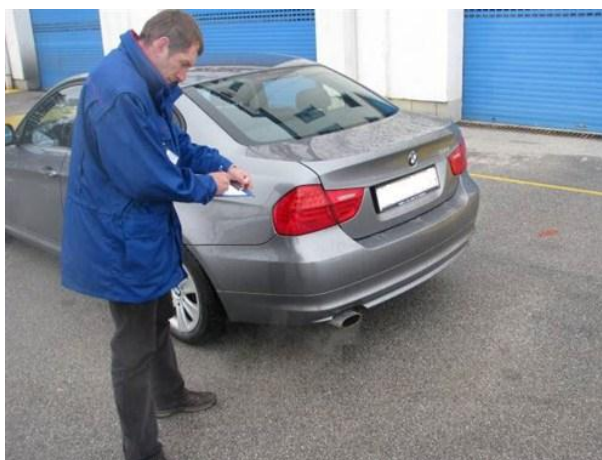
Slika 5. Primjer homologacije tipa vozila-provjera homologacijskih oznaka vozila prema homologacijskoj dokumentaciji
