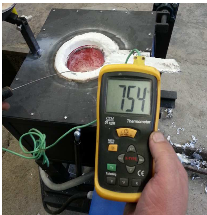
Slika 36. Mjerenje temperature prije lijevanja u kalup
