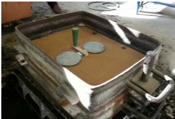
Slika 26. Namješten okvir gornjaka na donjak te pozicionirani modeli
