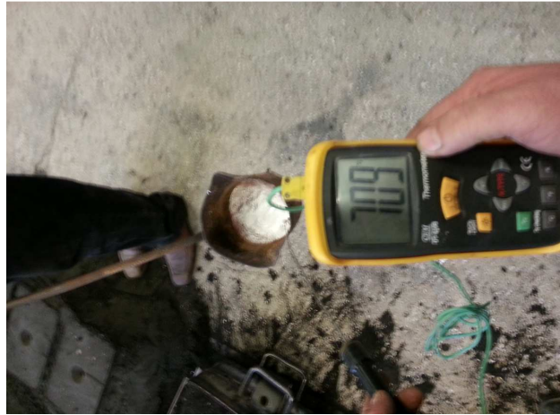
Slika 34. Mjerenje temperature prije lijevanja u kalup
