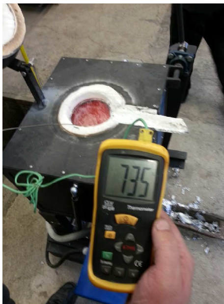
Slika 35. Prikaz mjerenja temperature legure u peći
