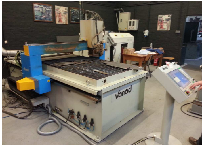
Slika 23. Plazma rezač Vanad za vrijeme izrezivanja jezgri.
