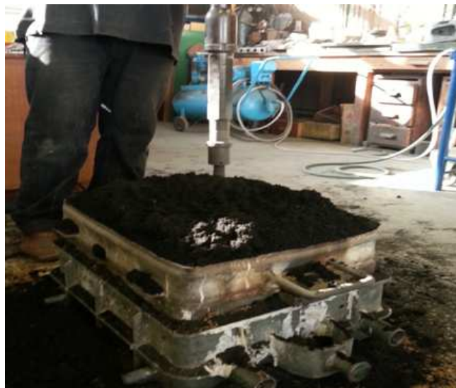
Slika 25. Sabijanje kalupne mješavine
