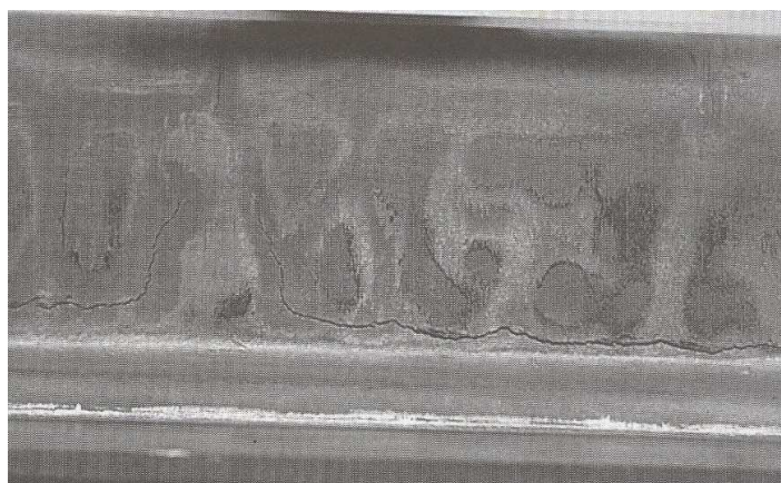
Slika 16. Topla pukotina na odljevku [28]
