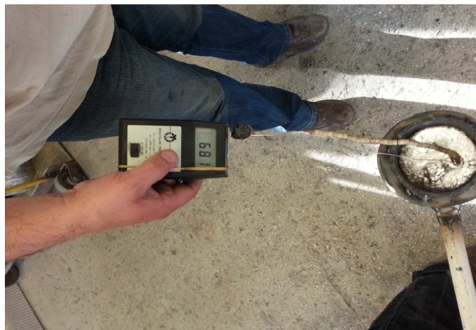
Slika 33. Mjerenje temperature prije ulijevanja taljevine u kalup
