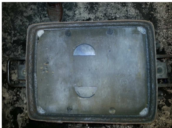
Slika 30. Prikaz pozicioniranog okvira donjaka i hladila
