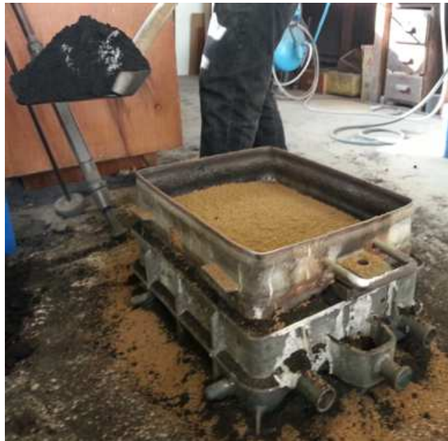
Slika 24. Nasipavanje kalupne mješavine
