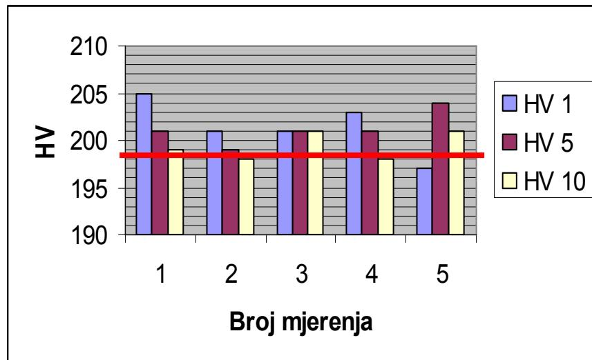
Slika 13: Grafički prikaz rezultata mjerena tvrdoće referentne pločice 1 na tvrdomjeru 1
