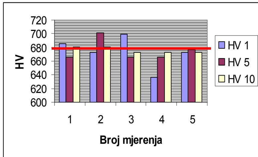
Slika 15: Grafički prikaz rezultata mjerena tvrdoće referentne pločice 3 na tvrdomjeru 1
