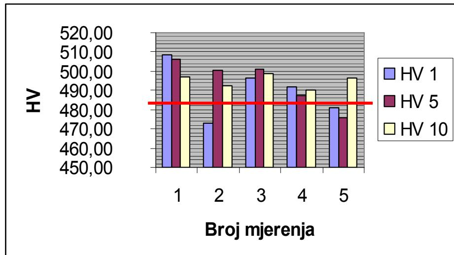
Slika 17: Grafički prikaz rezultata mjerena tvrdoće referentne pločice 2 na tvrdomjeru 2
