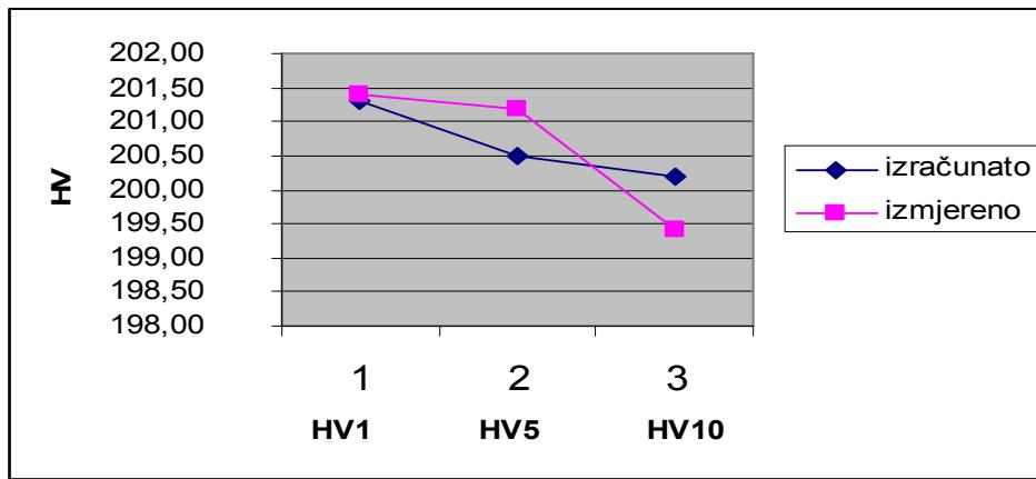
Slika 19: Grafički prikaz razlika izmjerениh i izračunatih vrijednosti tvrdoća referentne pločice 1 na tvrdomjeru 1
