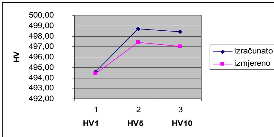
Slika 20: Grafički prikaz razlika izmjerениh i izračunatih vrijednosti tvrdoća referentne pločice 2 na tvrdomjeru 1
