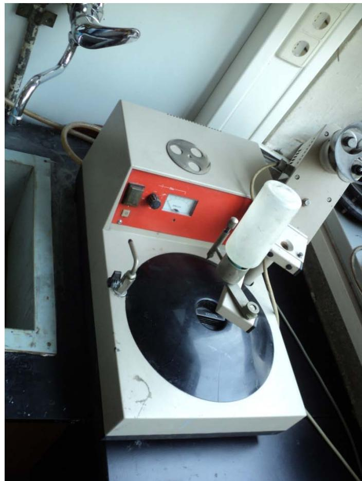
Slika 50. Uređaj za poliranje
