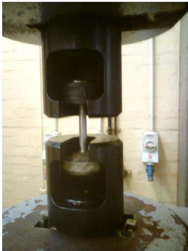
Slika 59. Pozicija epruvete na kidalici
