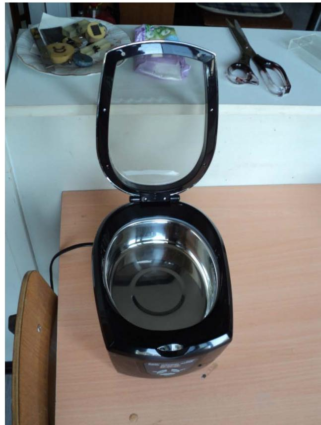
Slika 49. Ultrazvučna čistilica
