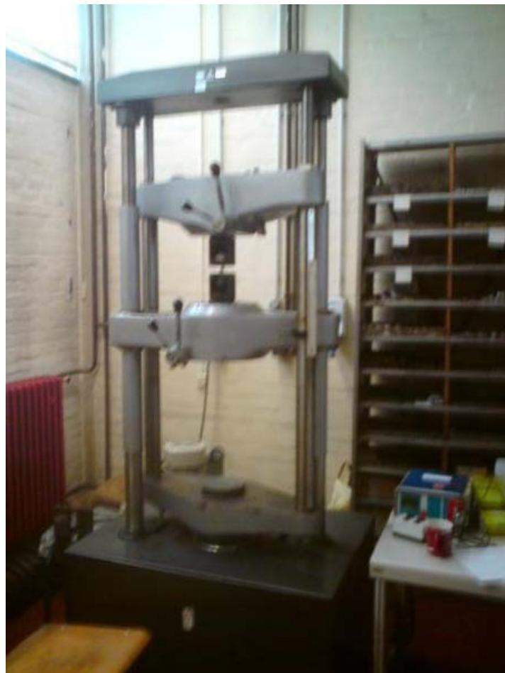
Slika 58. Hidraulička kidalica
