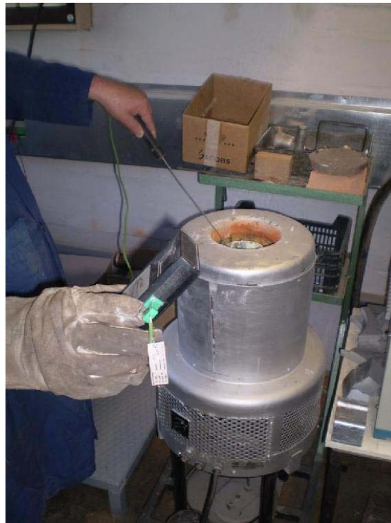
Slika 35. Mjerenje temperature pirometrom
