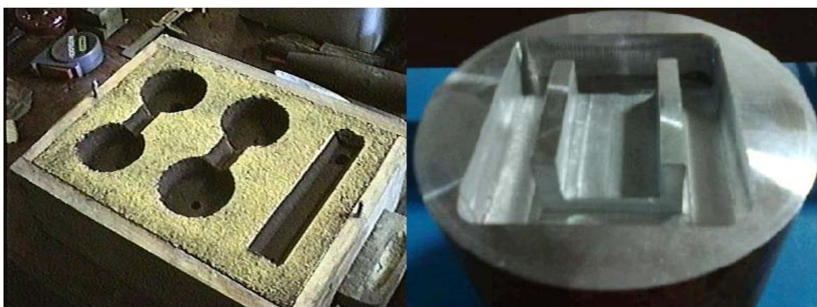
Slika 4. Donjak jednokratnog kalupa (lijevo) i donjak stelnog kalupa (desno) [5,6]
