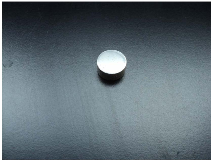
Slika 45. Uzorak za ispitivanje mikrostrukture ( $\Phi 20 \times 10$  mm)
