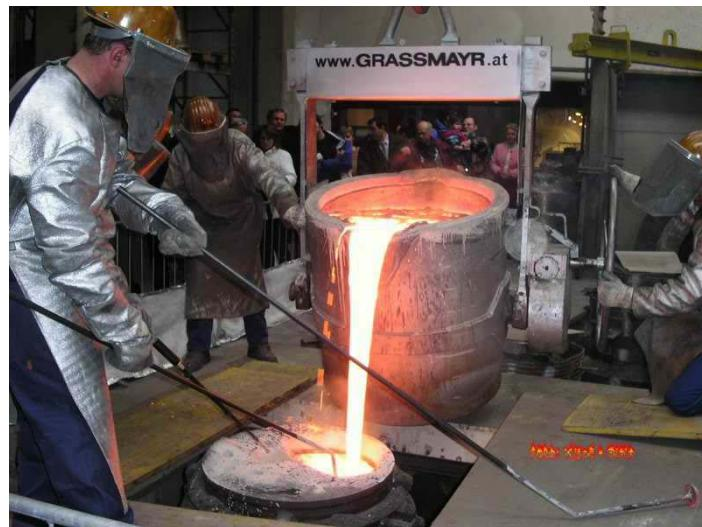
Slika 1. Lijevanje metala u kalup [3]
