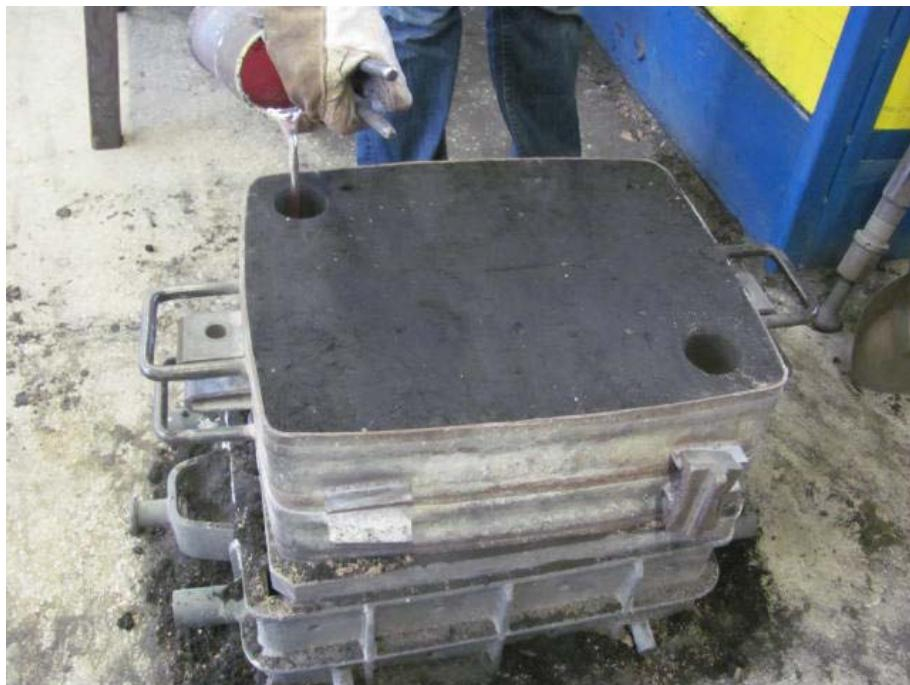
Slika 40. Ulijevanje rastaljene AlCuMgSi legure u kalup
