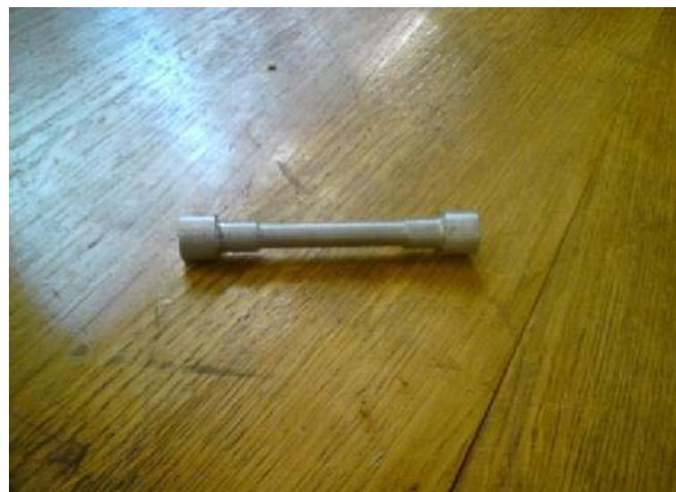
Slika 56. Epruveta za vlačna ispitivanja na kidalici
