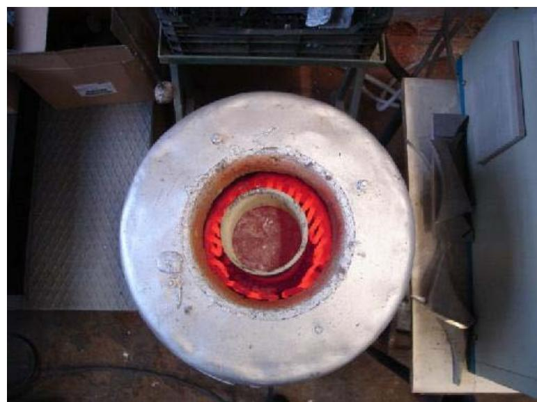
Slika 34. Taljevina AlSi12 legure u peći
