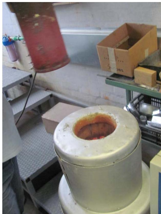
Slika 38. Umetanje lonca u elektrootpornu peć
