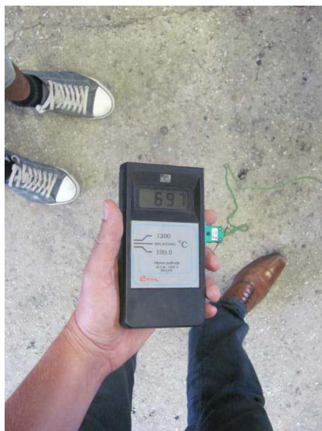
Slika 39. Očitavanje temperature taljevine
