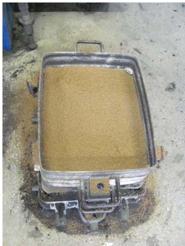
Slika 24. Nasipavanje modelnog pijeska
