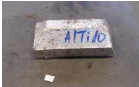
Slika 31. Predlegura AlTi10 za usitnjavanje zrna
