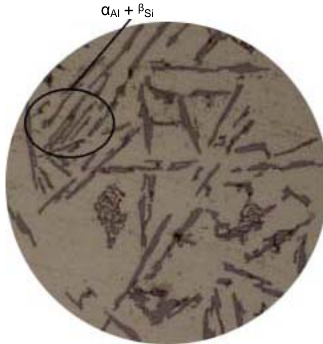
Slika 53. AISi12 legura cijepljena AlTi10 predlegurom (povećanje 500x)
