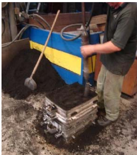
Slika 20. Sabijanje kalupne mješavine
