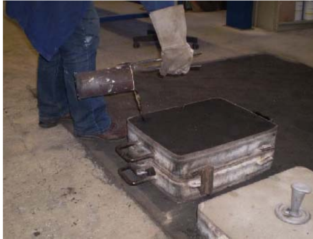
Slika 29. Ulijevanje taljevine u pješčani kalup
