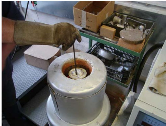
Slika 33. Potapanje tablete u taljevini
