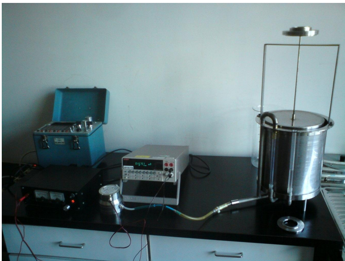
Slika 10.9. Ispitivanje stabilnosti radnih točaka zvonastog manometra
