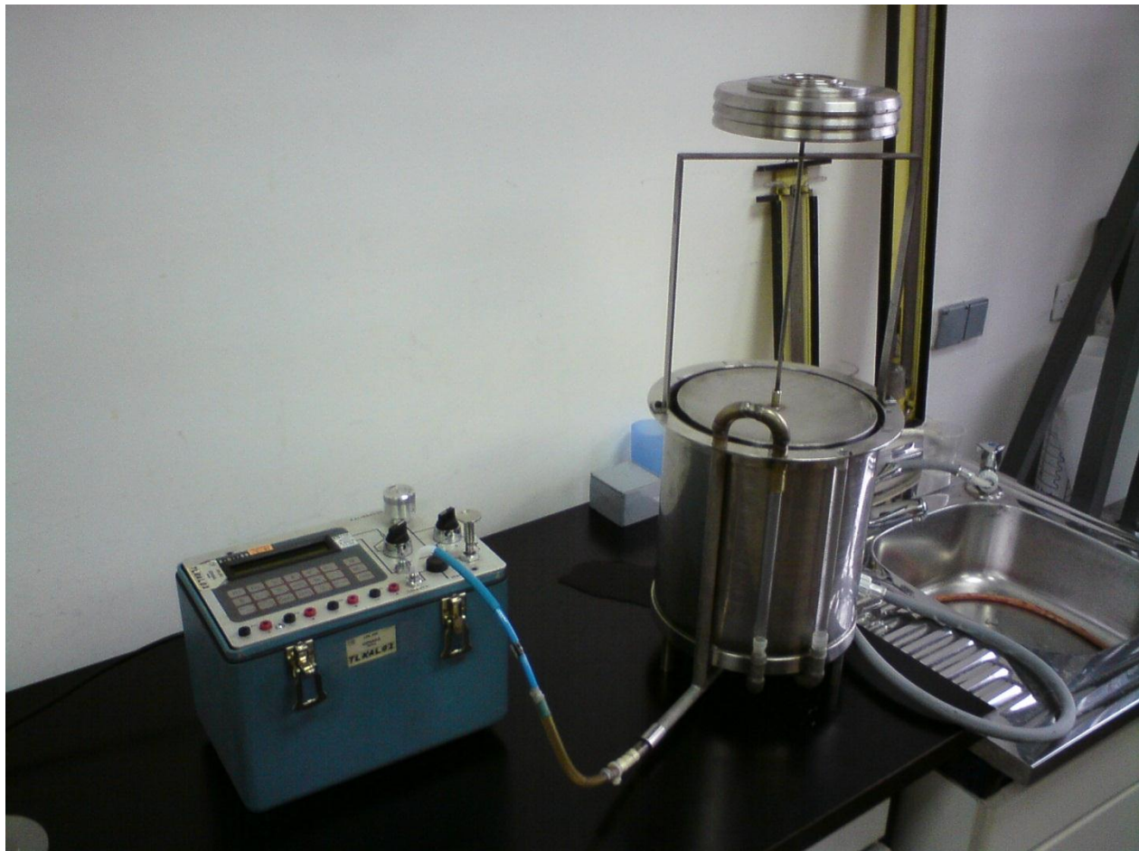
Slika 10.4. Određivanje maksimalne točke mjernog područja zvonastog manometra
