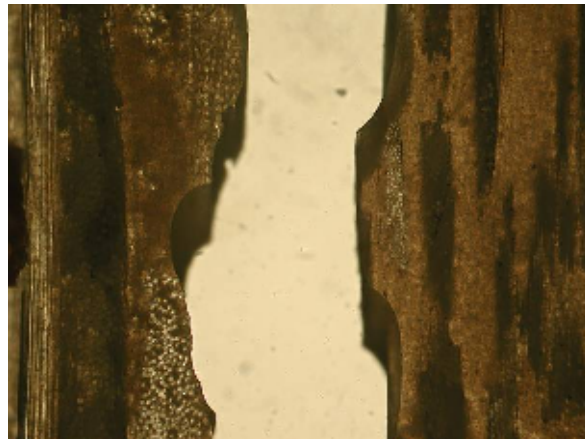
Slika 39. Mikrostruktura laminata nakon djelovanja vode, snimak 10
