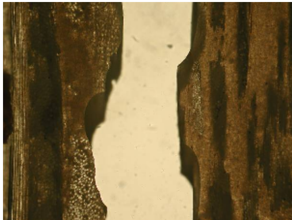
Slika 39. Mikrostruktura laminata nakon djelovanja vode, snimak 10
