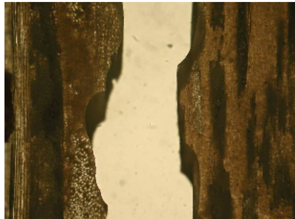
Slika 39. Mikrostruktura laminata nakon djelovanja vode, snimak 10
