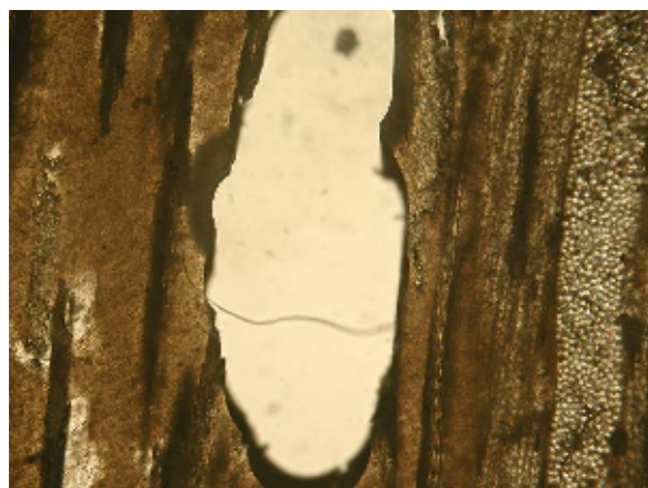
Slika 31. Mikrostruktura laminata nakon djelovanja vode, snimak 2
