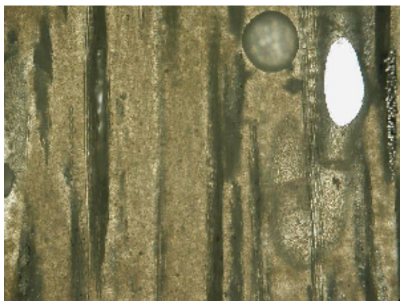
Slika 43. Mikrostruktura laminata nakon djelovanja vode, snimak 14
