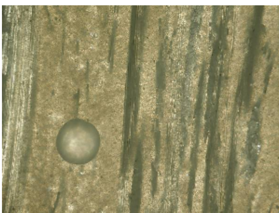
Slika 36. Mikrostruktura laminata nakon djelovanja vode, snimak 7
