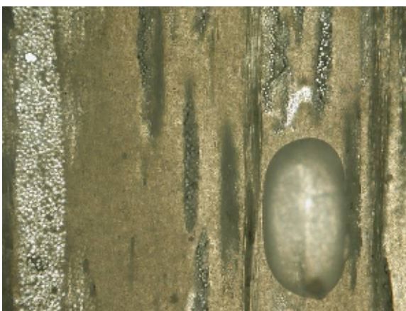
Slika 41. Mikrostruktura laminata nakon djelovanja vode, snimak 12
