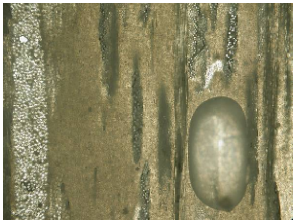
Slika 41. Mikrostruktura laminata nakon djelovanja vode, snimak 12
