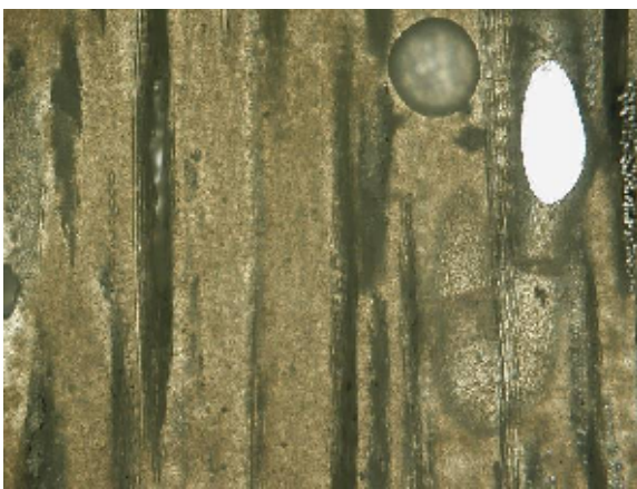
Slika 43. Mikrostruktura laminata nakon djelovanja vode, snimak 14
