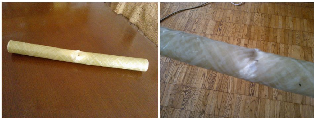
Slika 40 Oštećenja uslijed ispitivanja savijanjem
