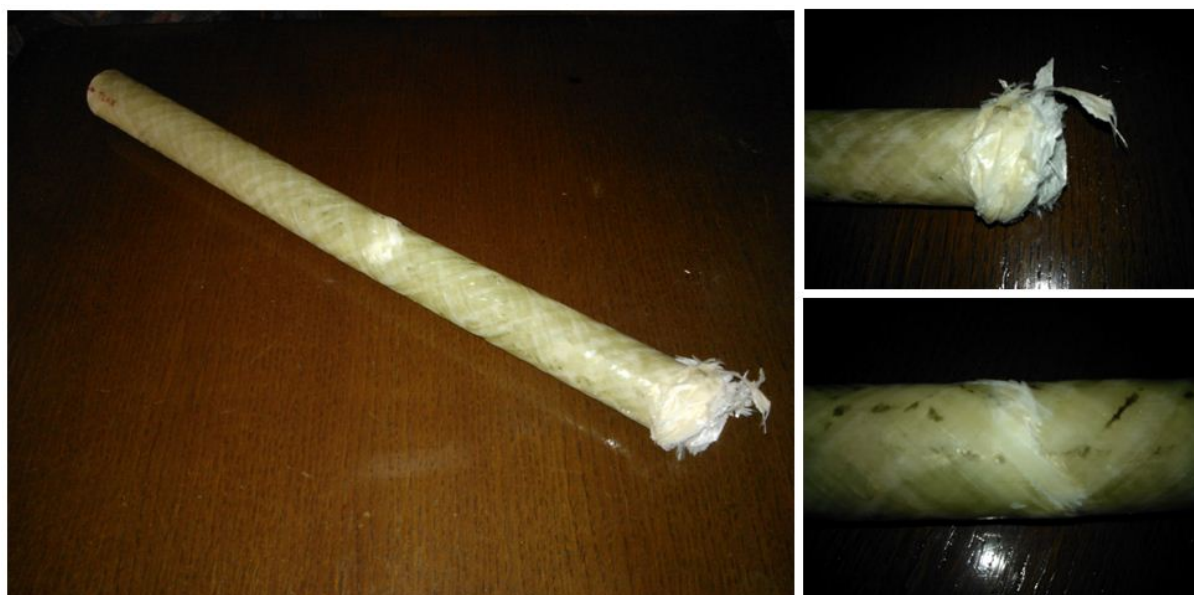
Slika 42 Oštećenja uslijed ispitivanja tlačanjem
