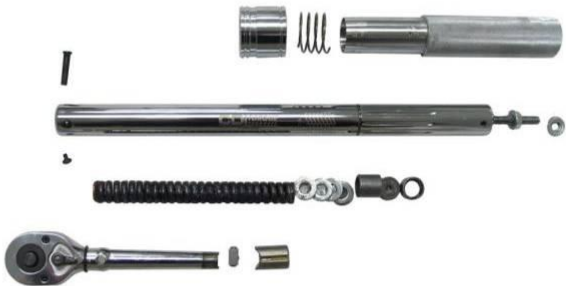
Slika 2: Rastavljeni mehanički momentni ključ s fiksnim podešenjem (tip sa zvučnom indikacijom) [4]
