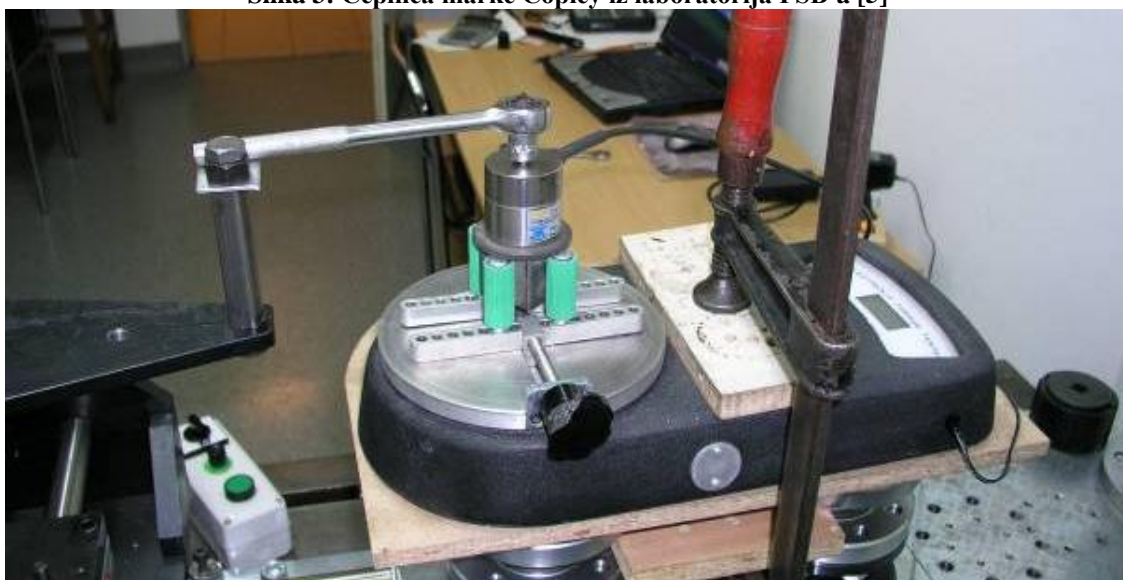
Slika 4: Trenutačni način umjeravanja čepilice [5]
