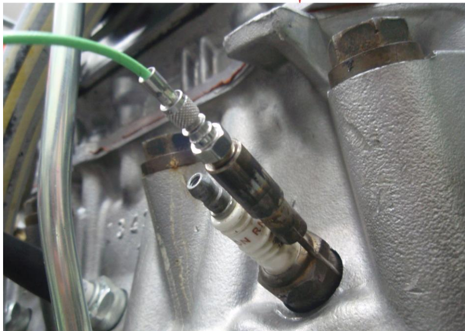
Slika Pogreška! Za dodavanje Heading 1 tekstu koji želite da se ovdje pojavi koristite karticu Početno..4.Fotografija sklopa svjećice i kućišta za piezoelektrični pretvarač ugrađenog u ispitni motor
