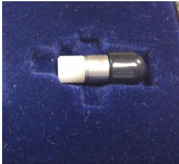
Slika Pogreška! Za dodavanje Heading 1 tekstu koji želite da se ovdje pojavi koristite karticu Početno..3. Fotografija piezoelektričnog pretvarača tlaka proizvođača Kistler tip 6001
