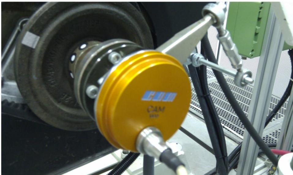
Slika Pogreška! Za dodavanje Heading 1 tekstu koji želite da se ovdje pojavi koristite karticu Početno..5. Fotografija CAM enkodera ugrađenog na DMB 128 A motor
