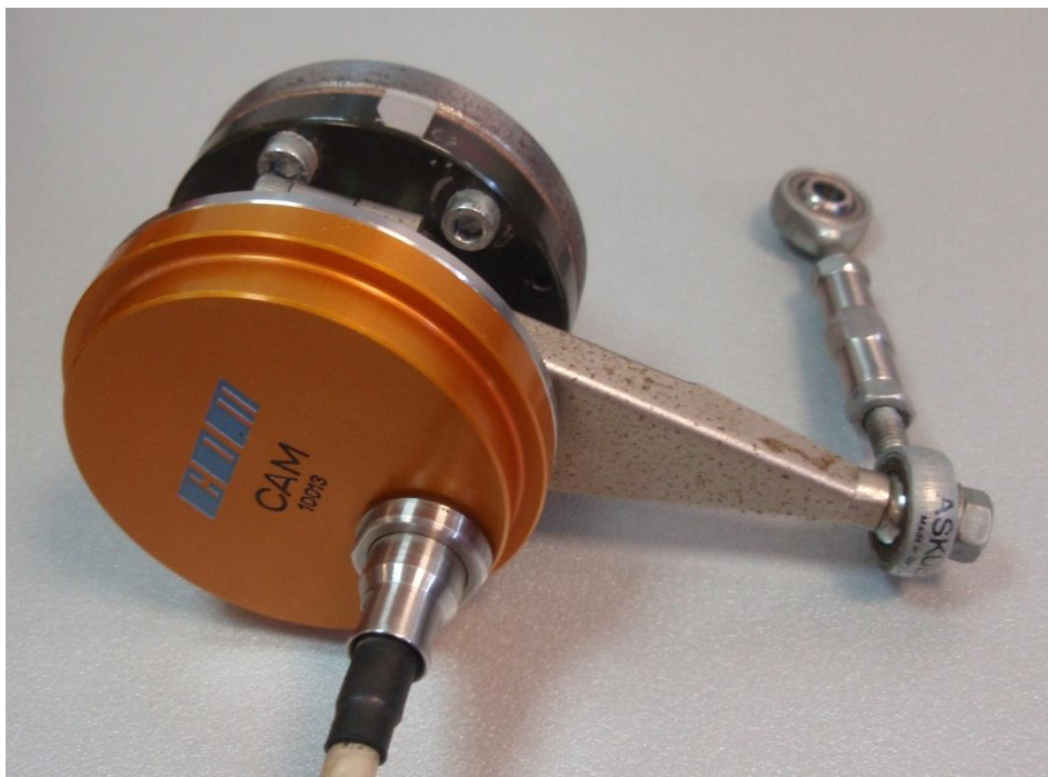
Slika Pogreška! Za dodavanje Heading 1 tekstu koji želite da se ovdje pojavi koristite karticu Početno.. 9. Fotografija senzora zakreta i brzine vrtnje koljenastog vratila
