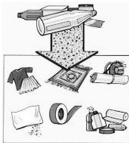
Slika 3.3. Od recikliranog PET-a do gotovog proizvoda [13]
