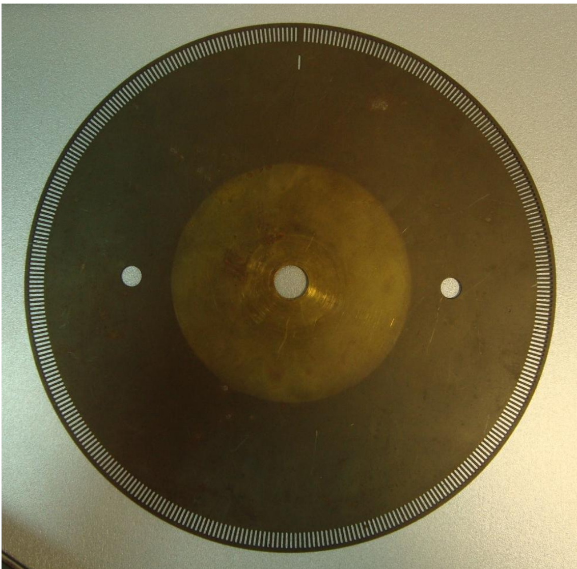
Slika 5.1. Disk enkodera koji radi na istom principu kao CAM enkoder
