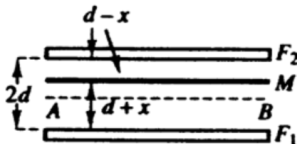
Slika 3.9. Diferencijalni senzor pomaka [1]
