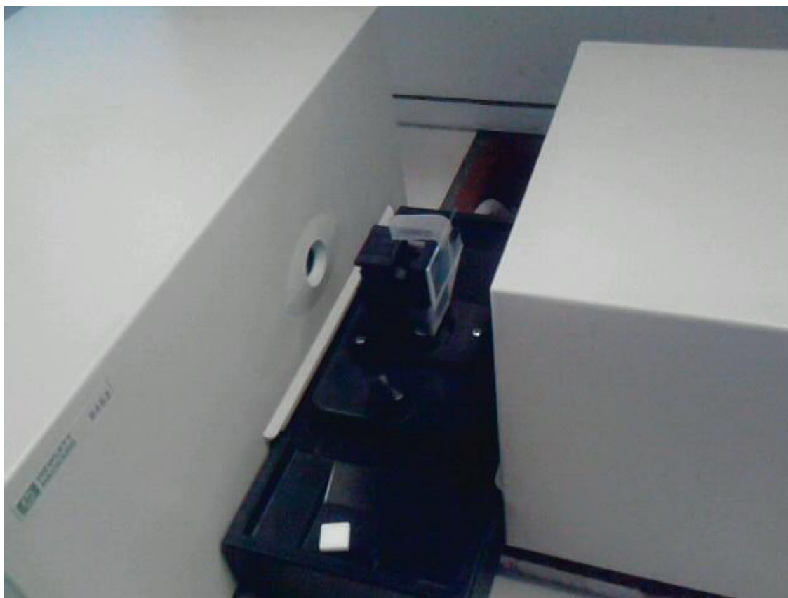
Slika 27. : Uzorak pripremljen za određivanje transmitancije
