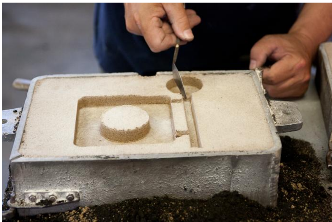
Slika 33. Oblikovanje uljevnog sustava alatom za obradu kalupne šupljine (lancetom)
