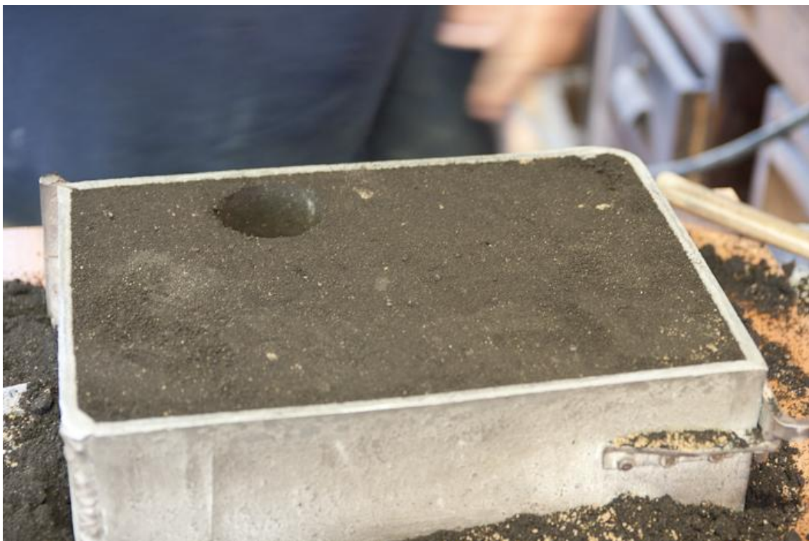
Slika 23. Vađenje uljevne čaše i spusta
