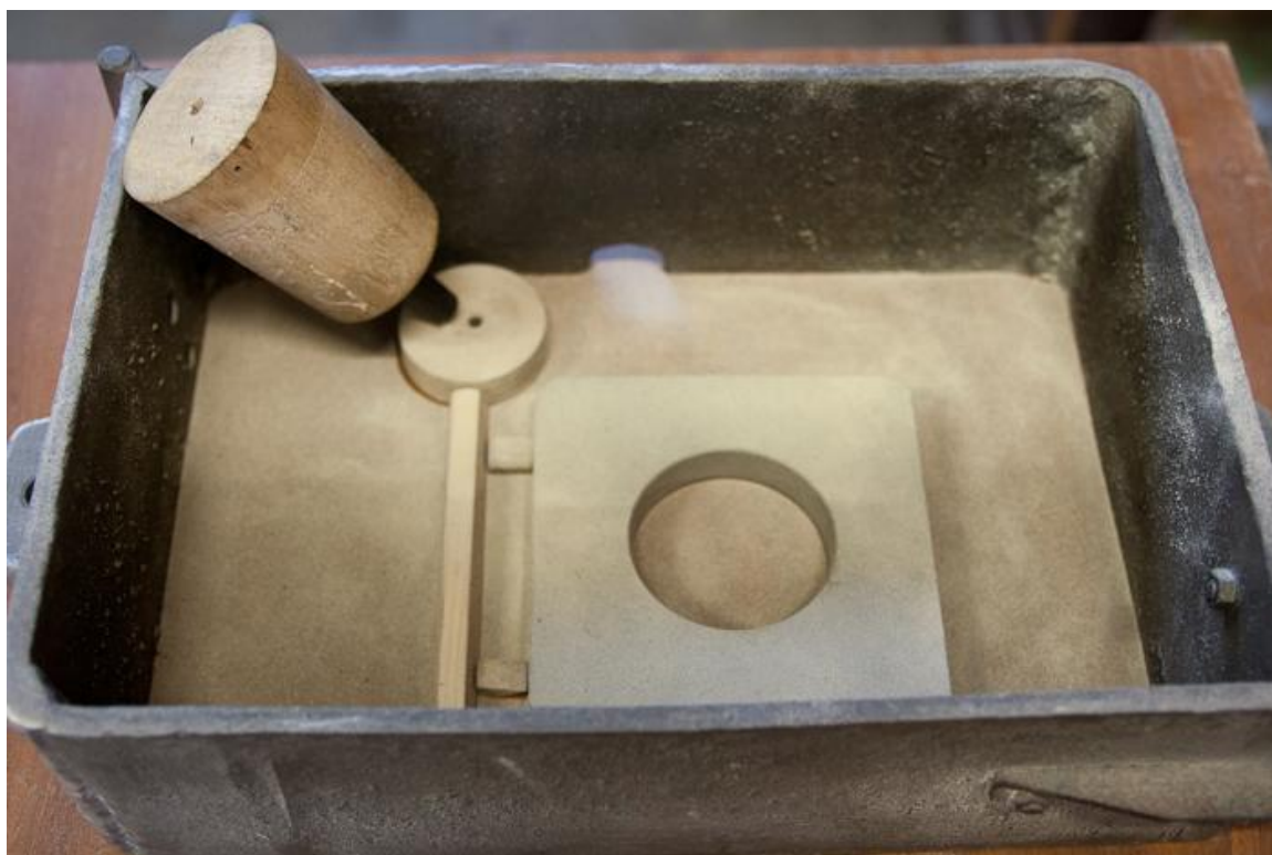
Slika 18. Pozicioniranje drvenog modela u gornjak (dimenzija 300x200x90mm)
