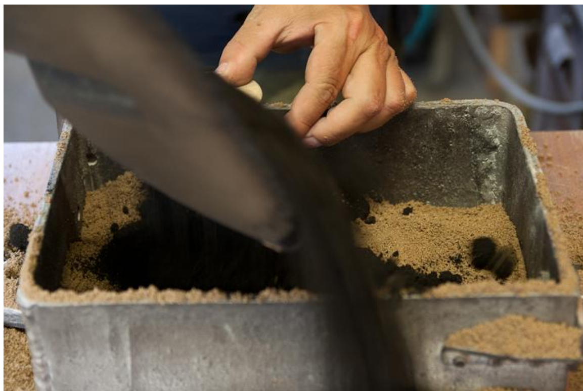
Slika 20. Nasipavanje crnim (dopunskim) pjeskom
