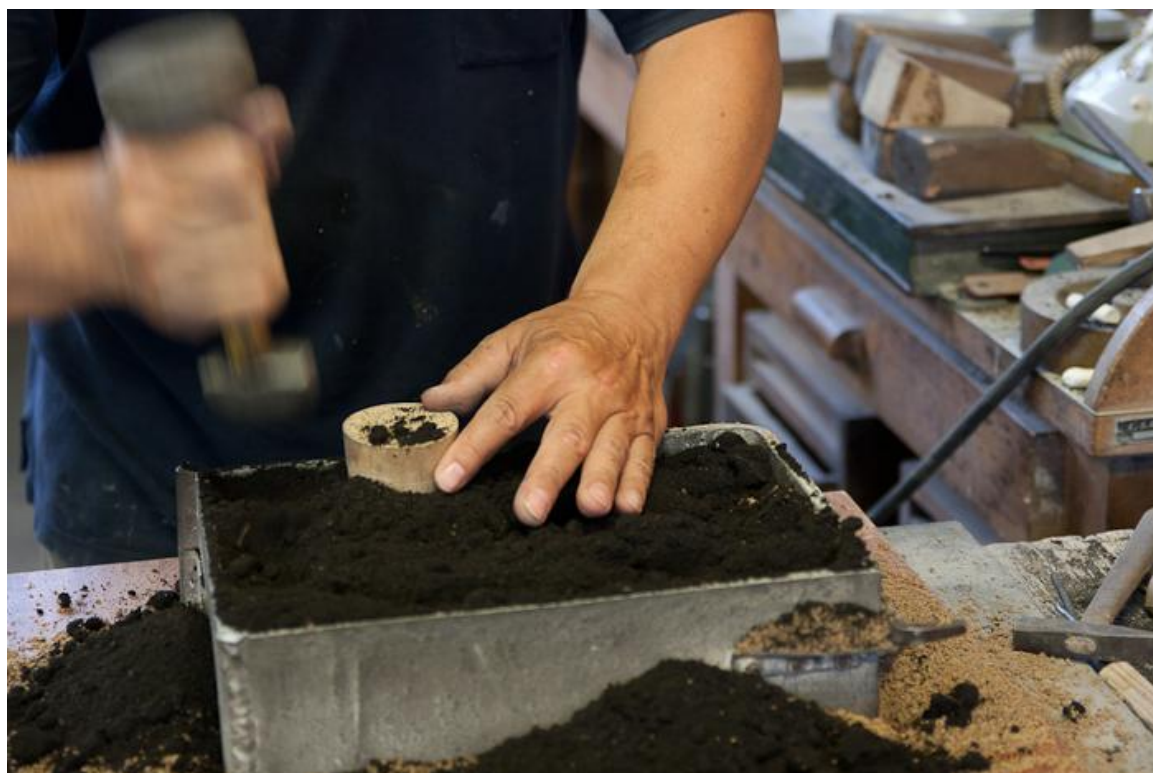
Slika 21. Sabijanje kalupne mješavine
