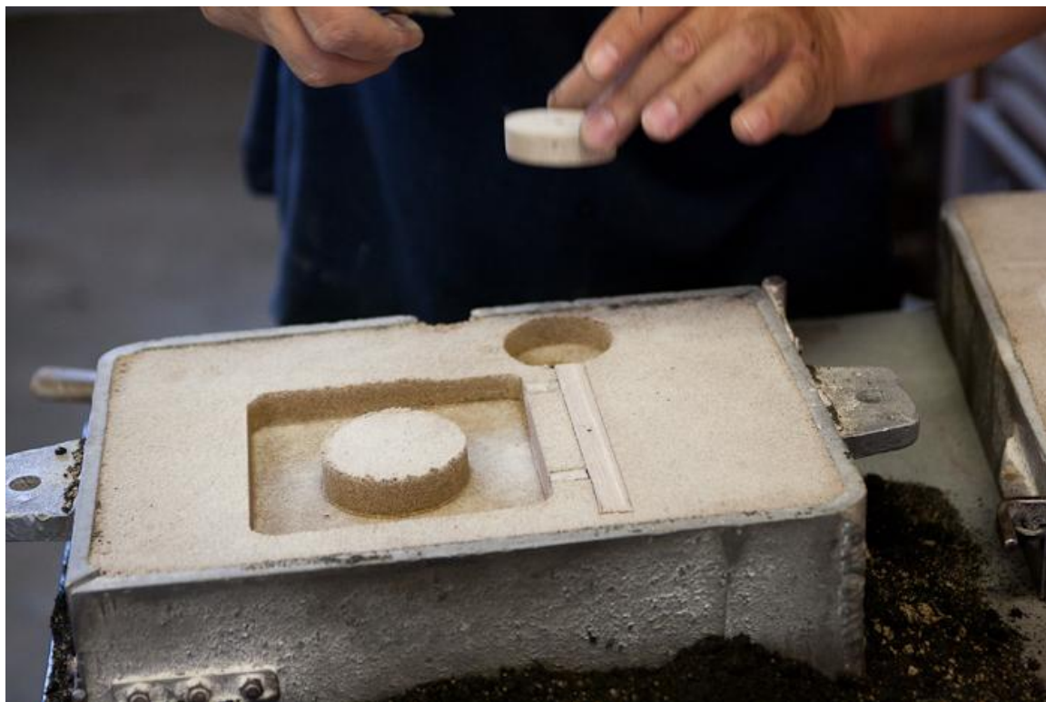
Slika 32. Izdvajanje drvenih modela iz kalupa
