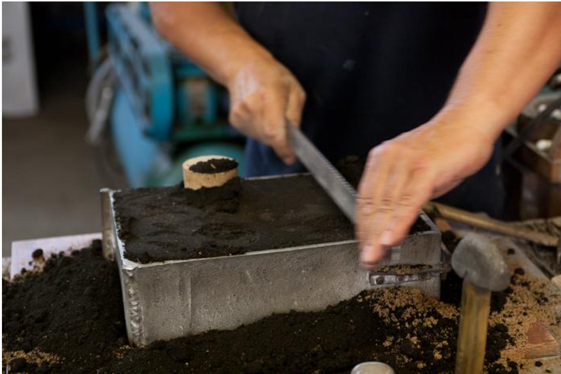
Slika 22. Ravnanje kalupne mješavine nakon sabijanja
