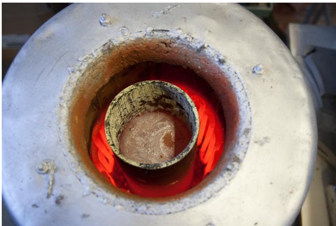
Slika 36. Taljenje aluminija u peći pri 730°C
