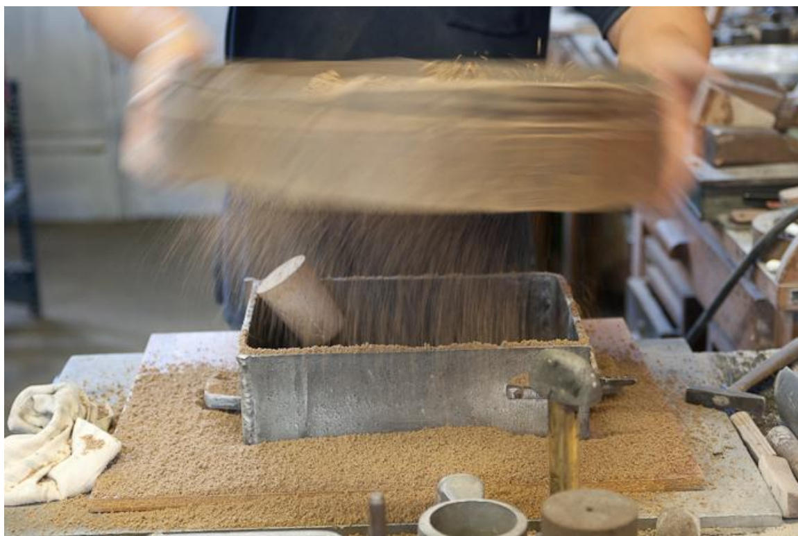
Slika 19. Posipavanje modelnim pijeskom (sadrži više cementa)
