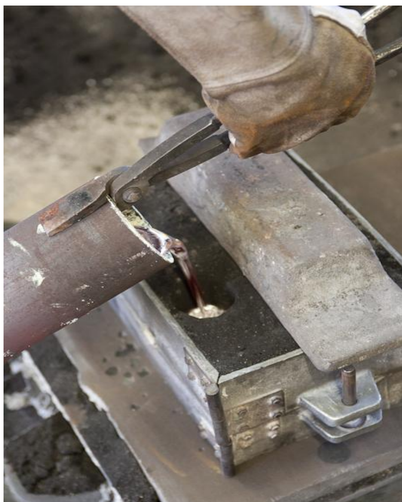
Slika 38. Uljevanje taljevine u kalup
