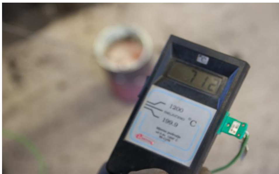
Slika 37. Mjerenje temperature taljevine
