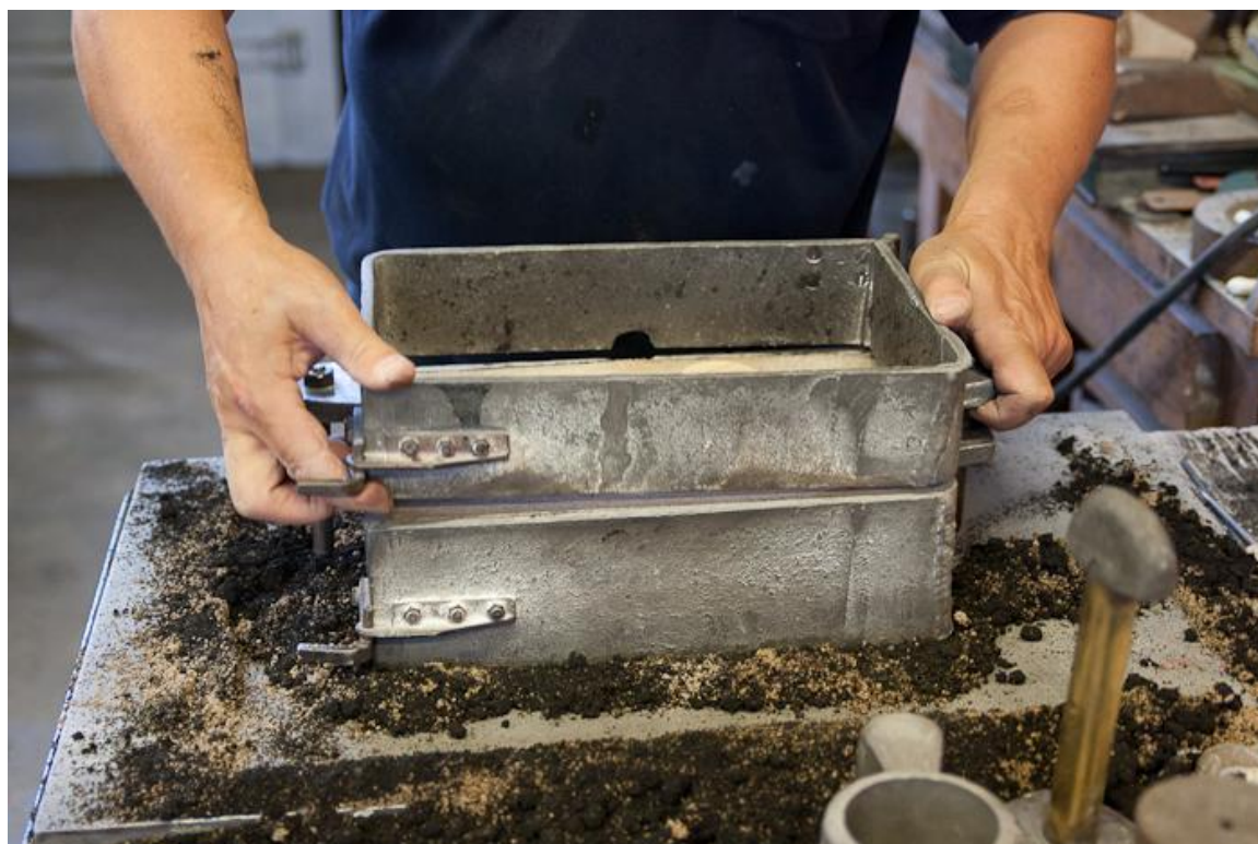
Slika 25. Stavljanje donjaka na gornjak (dimenzije donjaka 300x200x65mm)
