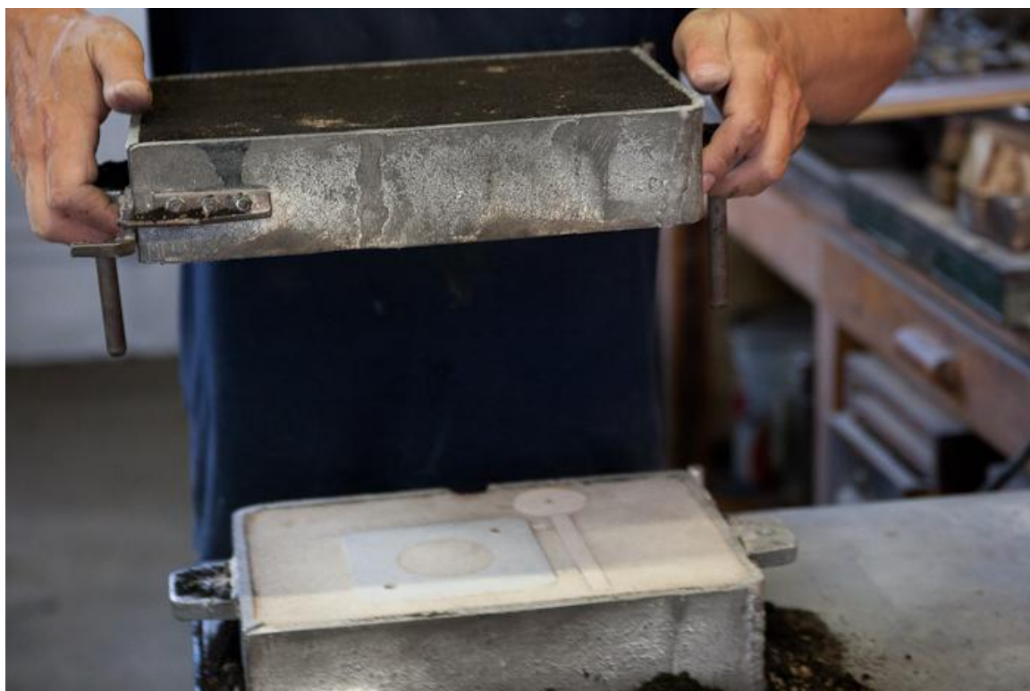
Slika 31. Odvajanje gornjeg i donjeg dijela kalupa
