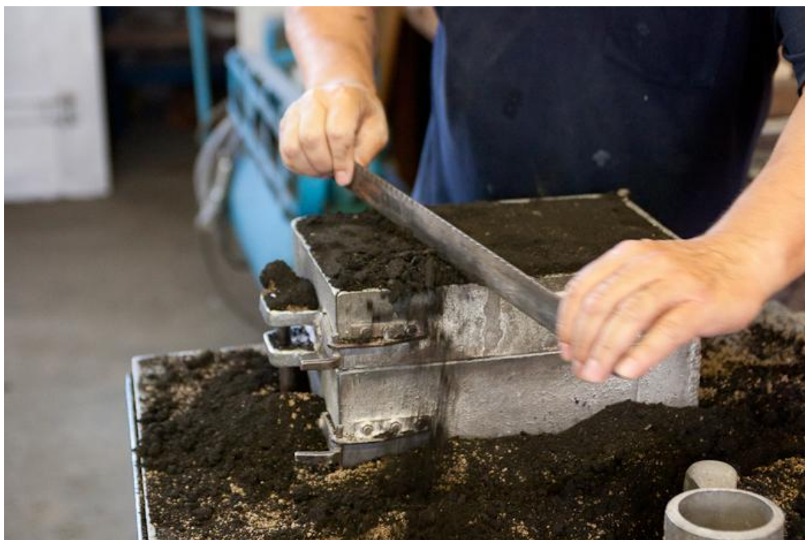
Slika 30. Ravnanje donjeg dijela kalupa nakon sabijanja
