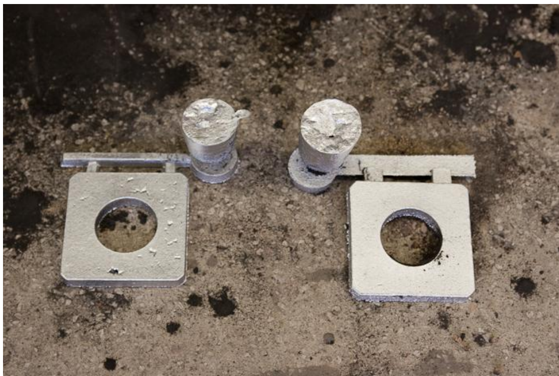
Slika 46. Prikaz odljevka sa uljevnim sustavima (lijevo-tlačni, desno-semitlačni)
