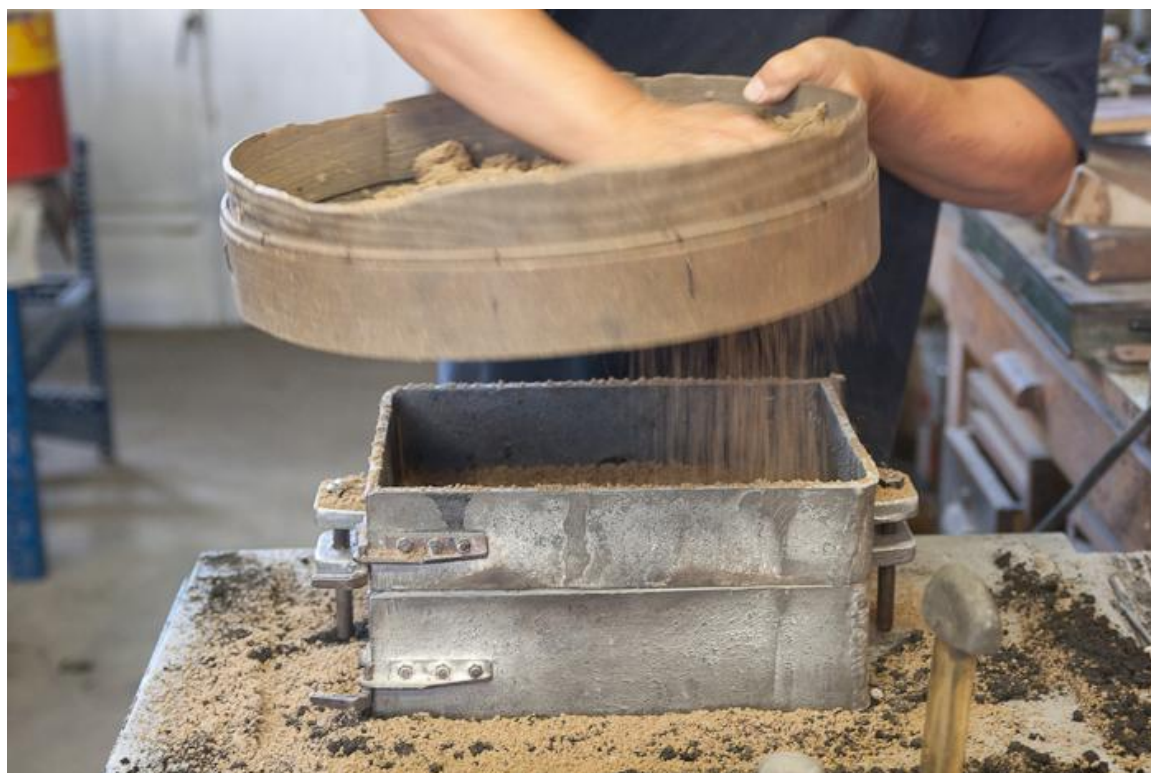
Slika 27. Nasipavanje donjeg dijela kalupa modelnim pijeskom
