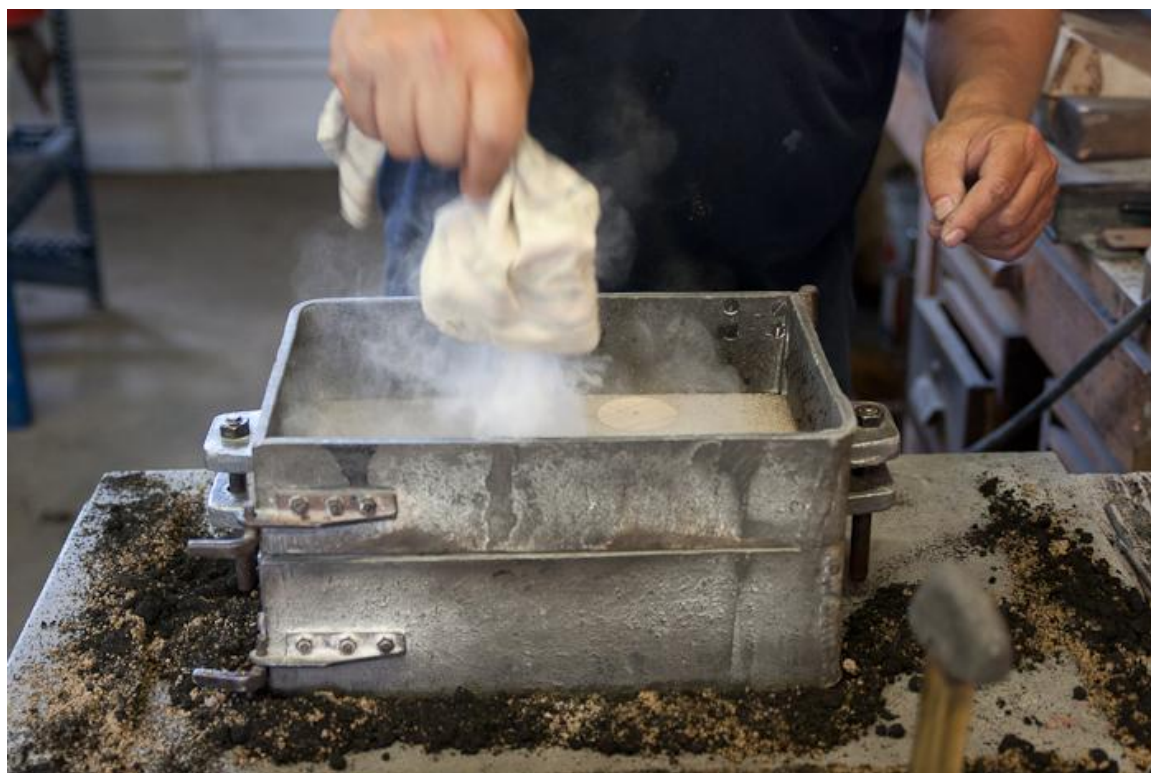
Slika 26. Posipavanje zapraškom radi lakšeg kasnijeg odvajanja
