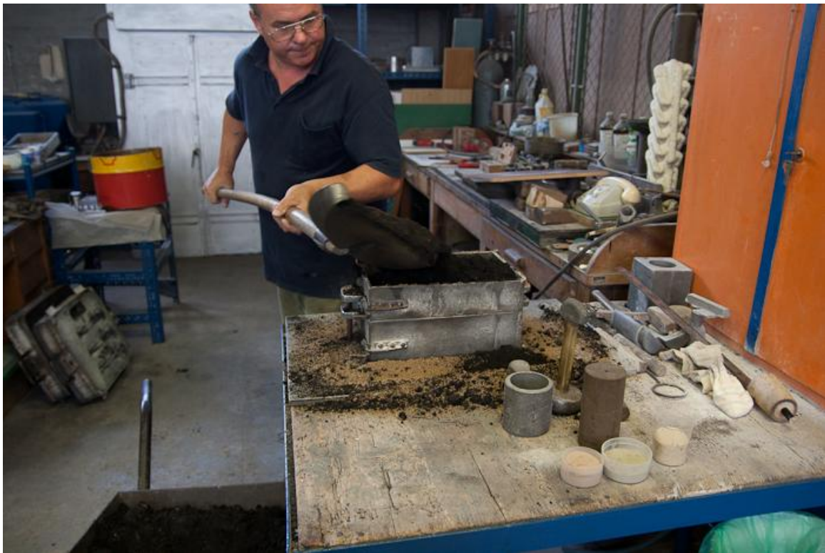
Slika 28. Nasipavanje donjeg dijela kalupa dopunskim pijeskom
