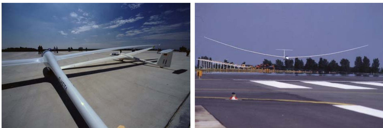
Slika 1.2. Savijanje iznimno vitkog krila pod opterećenjem lijevo: nadolje od vlastite težine; desno: prema gore od aerodinamičkog opterećenja
