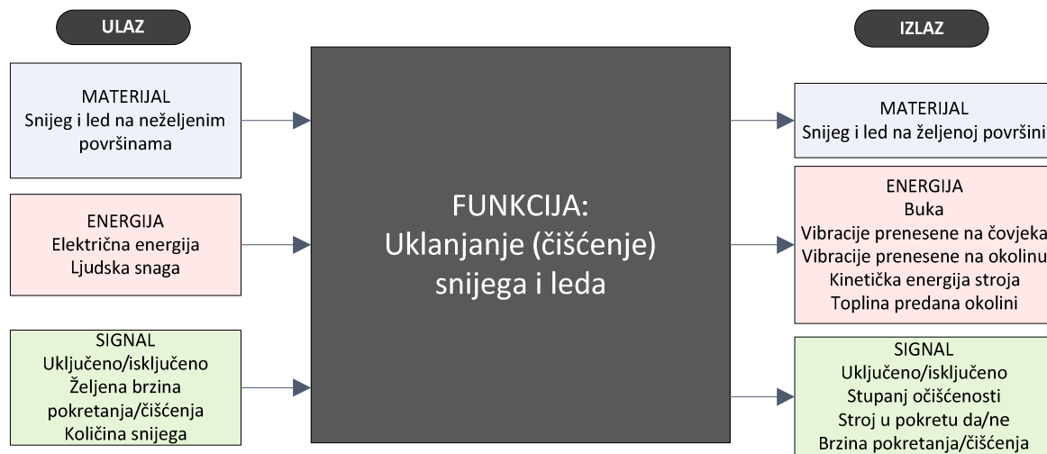
Slika 10. Blackbox stroja za čišćenje snijega i leda
