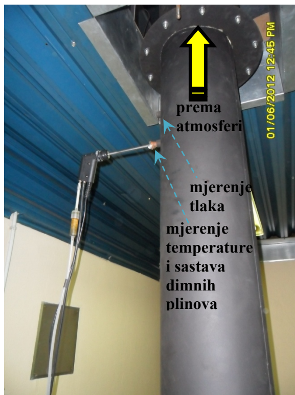
Slika 26. Mjerenje temperature i sastava dimnih plinova
