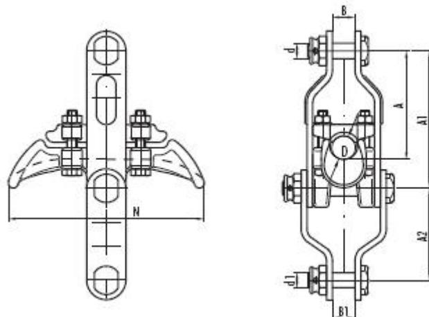
Slika 2.1 Sklop tijela stezaljke
