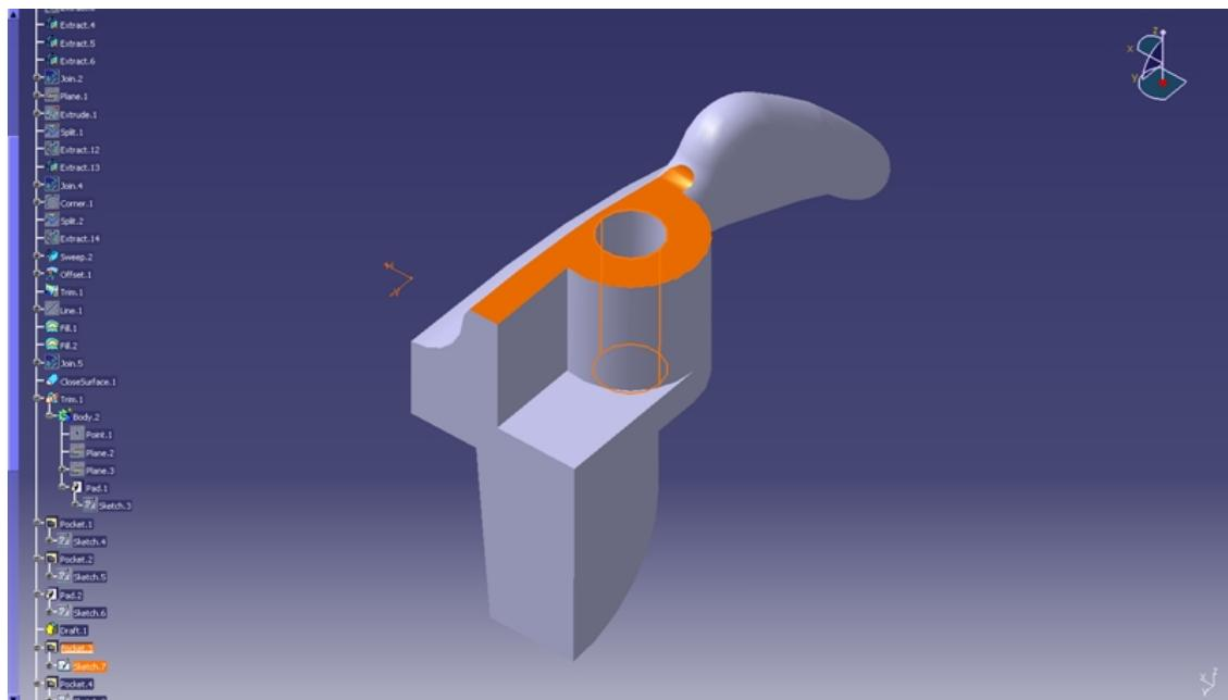
Slika 4.15 Ljevački kut u prvoru
