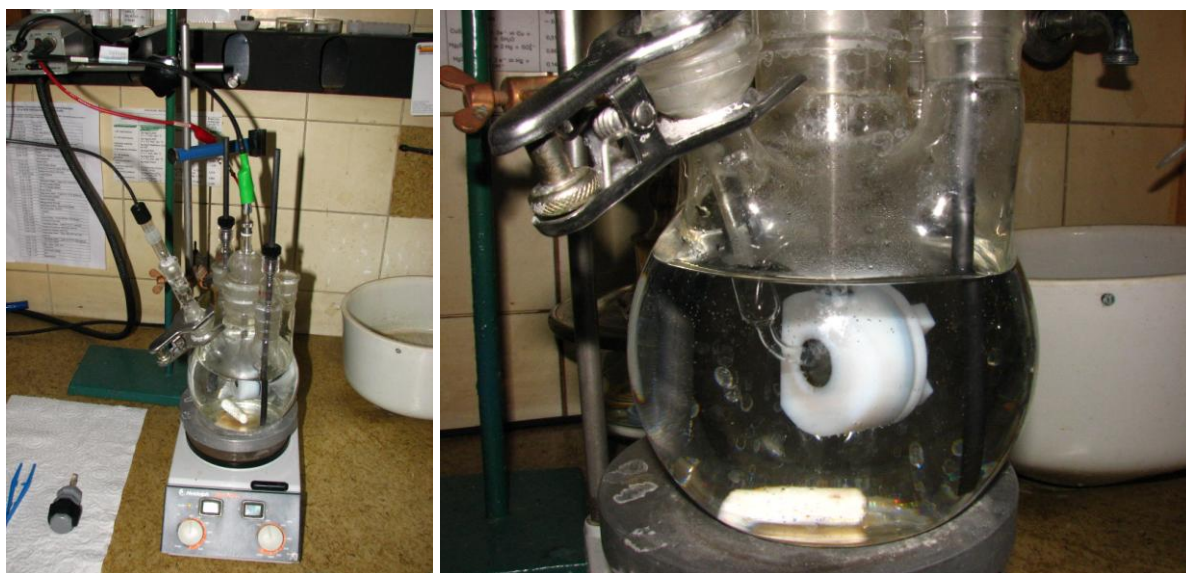
Slika 26. Ispitna ćelija (lijevo), radna elektroda/ispitivani uzorak u nosaču (desno)
