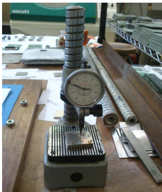
Slika 63. Postupak mjerenja dubina rupica na uzorcima koji su oštećeni rupičastom korozijom
