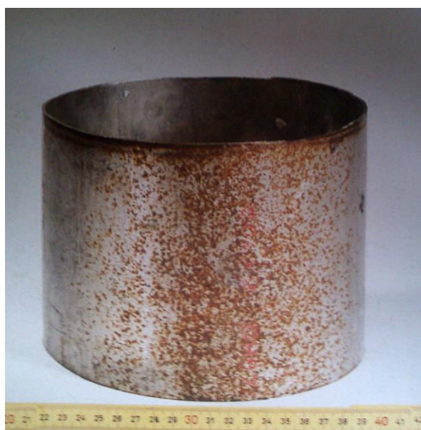
Slika 17. Oštećenje izazvano rupičastom korozijom pri povišenim temperaturama (slučaj 2) [13]
