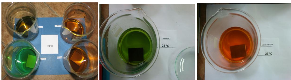
Slika 60. Uzorci nakon 72 sata u otopini \text{FeCl}_3 pri sobnoj temperaturi
