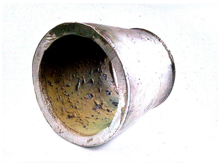
Slika 16. Oštećenje izazvano rupičastom korozijom pri povišenim temperaturama (slučaj 1) [13]
