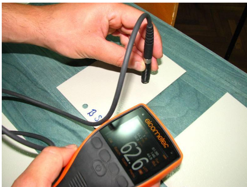
Slika 31. Mjerenje debljine sloja epoksidne prevlake uređajem „elcometer 456“ [10]
