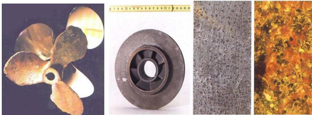
Slika 9. Decinkacija mjedi (lijevo) i grafitizacija sivog lijeva (sredina i desno) [3]
