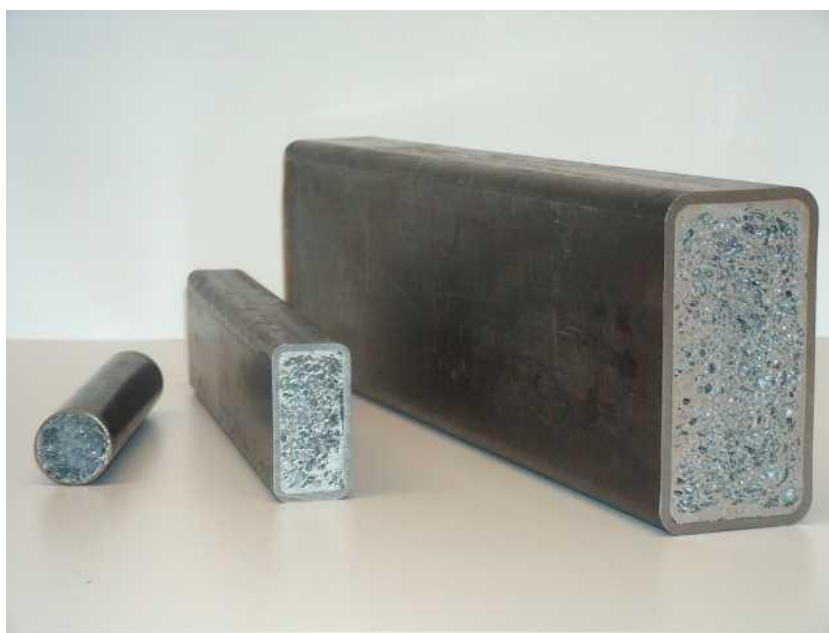
Slika 25. Sendvič konstrukcija s jezgrom od metalne pjene [11]
