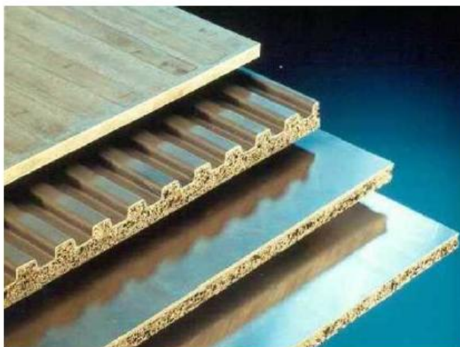
Slika 27. Sendvič poluproizvodi od metalne pjene [12]
