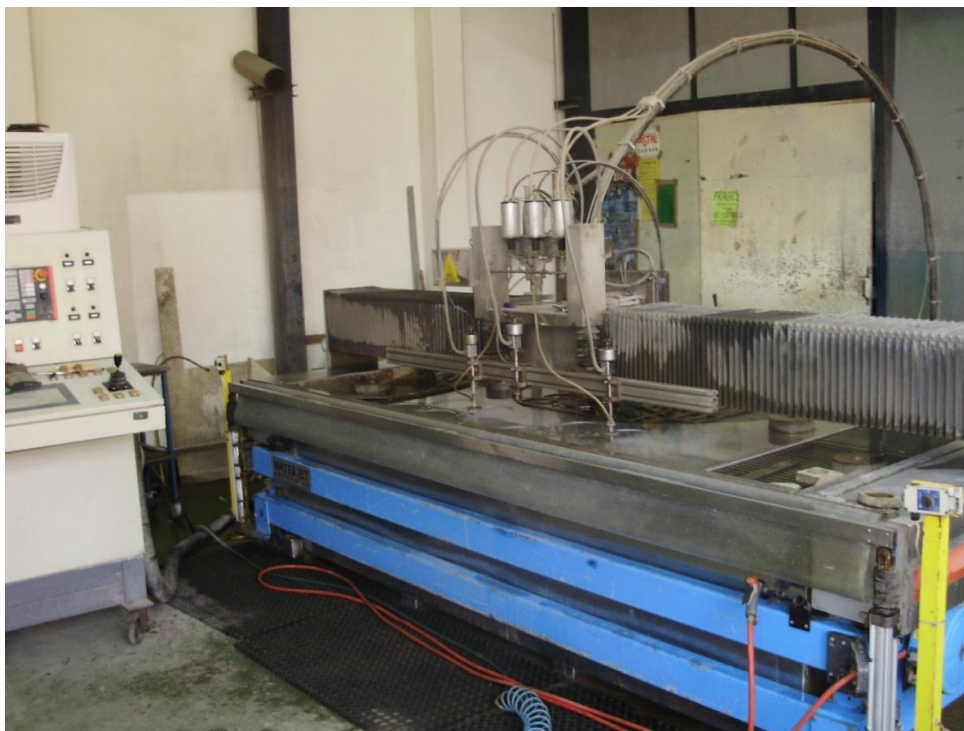
Slika 34. Rezanje vodenim mlazom (WJM)
