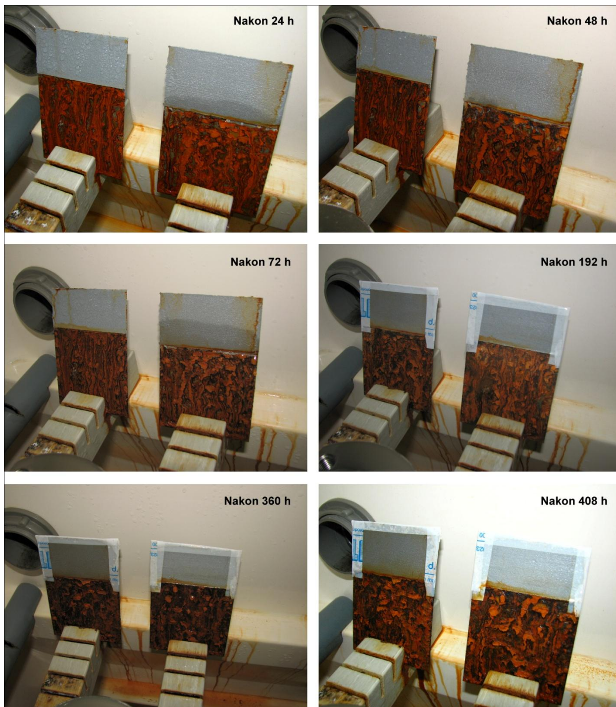
Slika 9.15. Izgled ispitivanih uzoraka u slanoj komori [15]
