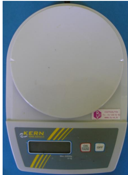
Slika 9.5. Digitalna vaga Kern-EMB 2200-0 [15]
