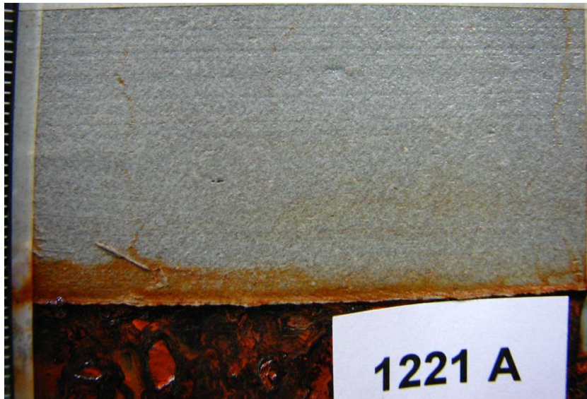
Slika 9.18. Detaljan prikaz površine prevlake od Super E-Metala nakon 20 dana u slanoj komori [15]
