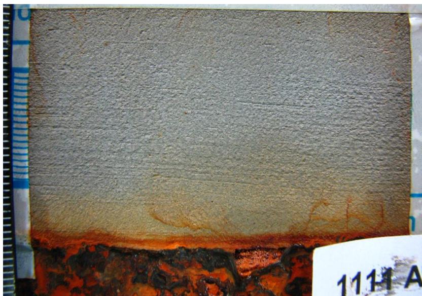
Slika 9.17. Detaljan prikaz površine prevlake od Super Metala nakon 20 dana u slanoj komori [15]
