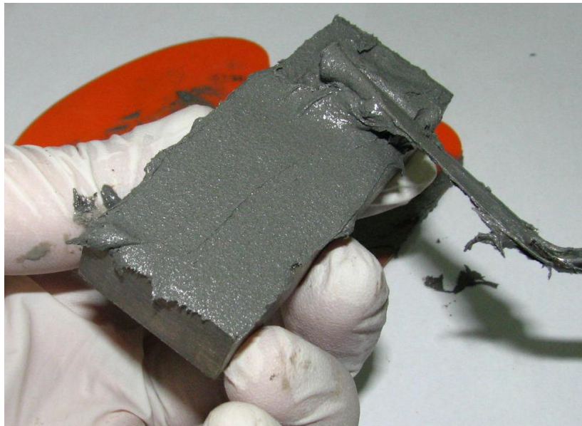
Slika 9.10. Nanošenje Super Metala na ispitni uzorak [15]
